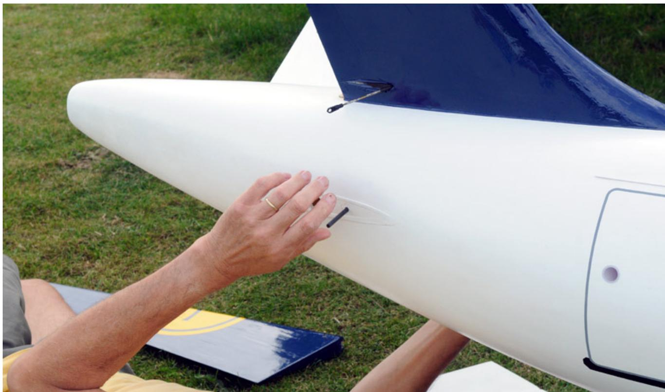
Damit die Servos in Neutralstellung lastfrei sind wird das Ruder durch die Federkraft eines dünnen Stahldrahtes in Waage gehalten und so fließt bei Neutralstellung also kein Servostrom.
