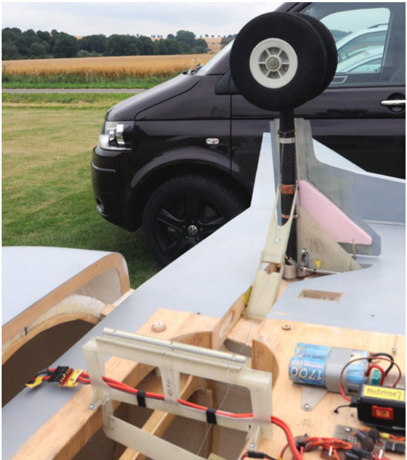
Die Fahrwerksbeine bestehen aus zwei gewebten Kohlerohre aus dem UL-Flugzeugbau. Auch die Federung die dort zum Einsatz kommt ist etwas Besonderes. Hierzu wurden in dem Rohr Gummibänder eingebaut, die aus einem Fahrradschlauch geschnitten sind. Durch die Anzahl der eingesetzten Gummibänder lässt sich die Federstärke einstellen. Diese Idee stammte von Sohn Peter. Das Einziehen der Fahrwerke erfolgt über Seile und einer selbstsperrenden Winde mit
