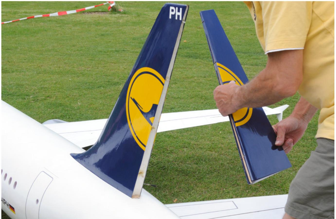
Höhen- und Seitenleitwerk sind abnehmbar. Die Höhenruder entsprechen dem Original der A-320. Dabei müssten normalerweise die Servos in der Nullposition die Ruder in die Neutralposition ziehen.
