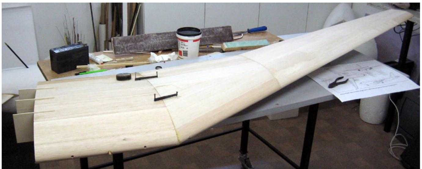
Als Flächenprofil entschied man sich für einen Eppler 203 also ein typischen Segelfliegerprofil und außen ein Eppler 205 mit vier Millimeter Schränkung. Obwohl das Modell weder über Bremsklappen oder Landeklappen verfügt lässt es sich extrem langsam machen. Dies ist durch das geringe Gewicht von lediglich 13 kg
