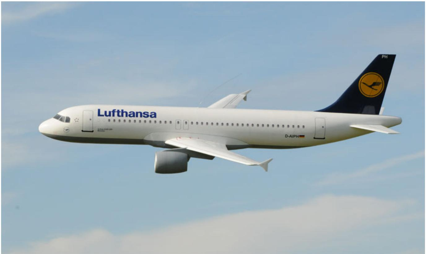
Der Schwerpunkt liegt bei ca. 50 Prozent der Wurzeltiefe. Der Einstellwinkel ist ca.  $1/2$  Grad. Die Maschine lässt sich sehr lange ziehen und ist sehr abrisssicher, es ist leicht beherrschbar und stabilisiert sich gut in der Luft. Die ungefähr ein Kilowatt Eingangleistung pro Motor sorgt dafür, dass sich der Flieger sehr gut auf Rasen starten lässt. Ist die A-320 einmal in der Luft lässt es sich schon mit Viertelgas fliegen.
