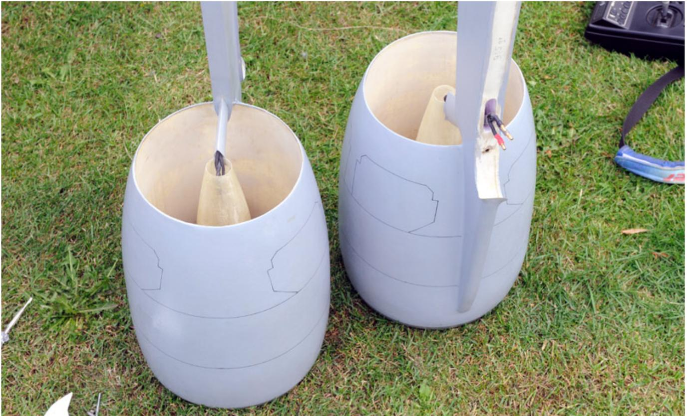
Die Gondeln für die Antriebe lassen sich abnehmen. Als Motoren kommen zwei Plettenberg HP370 mit je einem Jeti Spin 77 an sechs Zellen zum Einsatz. Jedes Treibwerk verfügt über einen eigenen 4.000 mAh Antriebsakku. Die Stromaufnahme im Stand beträgt 55 Ampere pro Triebwerk.
