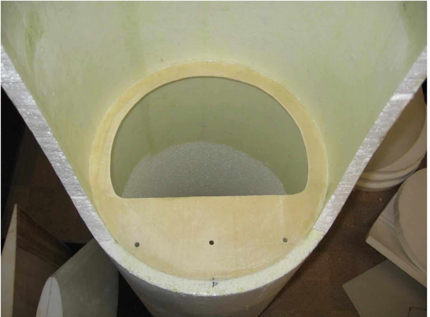
Die Oberfläche wurde mit 47-Gramm-Gewebe überzogen. Im mittleren Bereich des Flugzeugs wurde die Röhre mit 80 Gramm-Gewebe auch noch von innen verstärkt und im Bereich der Flügelaufnahmen sind auch noch Spanten vorhanden.
