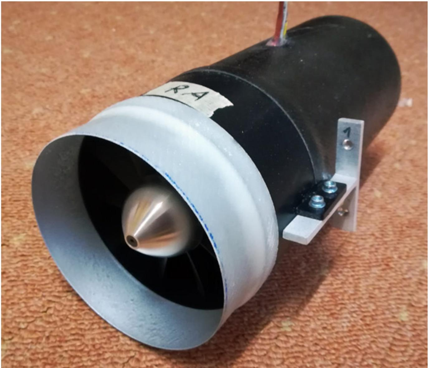
Die Antriebe kommen von WeMoTec und die Wahl fiel auf die neuen 100-mm-Impeller Midi Fan 100 evo. Hier werden immer zwei Fans mit je 12 S gespeist. Jeder Motor erhält ein YGE 95 HV Regler. Den Antrieb hatte WeMoTec berechnet, mit dem Ziel einen Schub von ca. 4,8 kg pro Impeller zu erreichen. Es wurden dafür letztendlich HET 700-68-900 Motoren eingesetzt. Die Akkus und Regler sind zentral im Rumpf verbaut und die Motoren über entsprechend lange Kabel angeschlossen.
