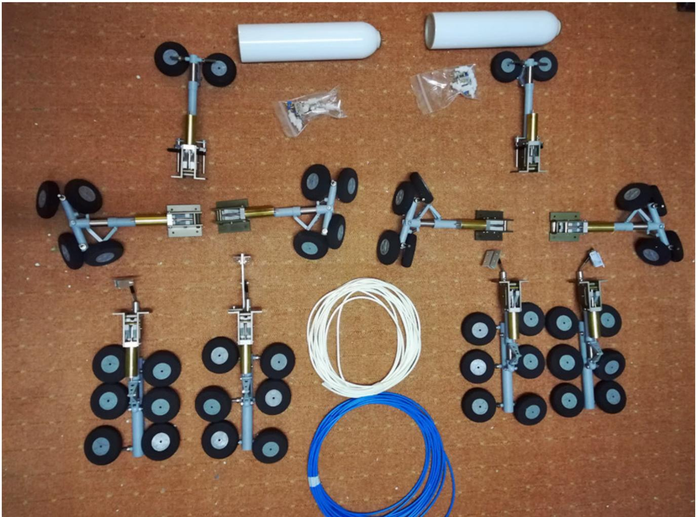
Nachdem wir herausgefunden hatten wie das Fahrwerk einfährt hat sich die Firma Hawe bereit erklärt uns zwei Fahrwerke zu konstruieren und zu bauen. Bei der Montage der Fahrwerke fragte man sich dann doch schon mal, warum man auf die Idee kommt ein Modell mit fünf Fahrwerksbeinen und 22 Reifen zu bauen. Das Fahrwerk ist außergewöhnlich aber auch Typisch und sehr aufwendig.
