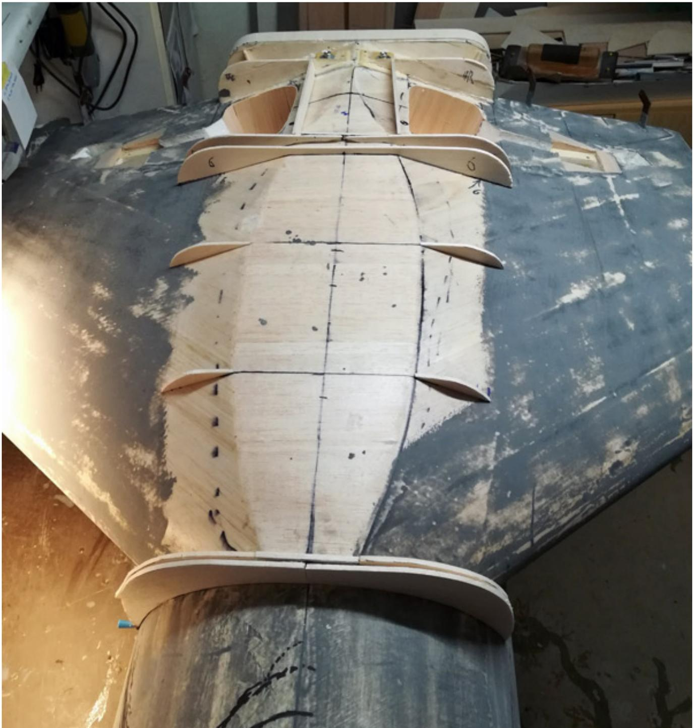
Der Mittelrumpf entstand aus einer Styropo-Röhre die mit 1-mm-Balsa beplankt und alles mit 25-Gramm-Matte laminiert wird. Auch die Flügel sind so aufgebaut. Auch wenn es sich hier schnell runter schreibt, dauerte die Erstellung der beschriebenen Teile schon einige Monate.
