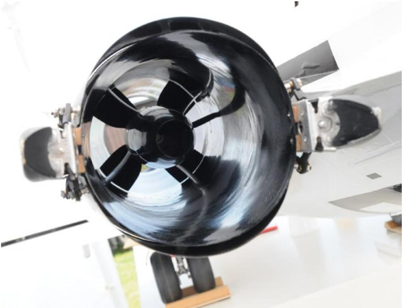
Eine weitere Besonderheit ist, dass das Modell mit Umkehrschubschaufeln ausgestattet ist. Diese haben zwar auch eine funktionelle Wirkung, aber diese ist nicht so groß wie im Vergleich zum Original, sondern eher ein Scale-Feature. Beim Landen werden diese daher auch nicht eingesetzt. Die Trommelbremsen bieten genügend Bremswirkung, um das Modell zum Stehen zu bringen.
