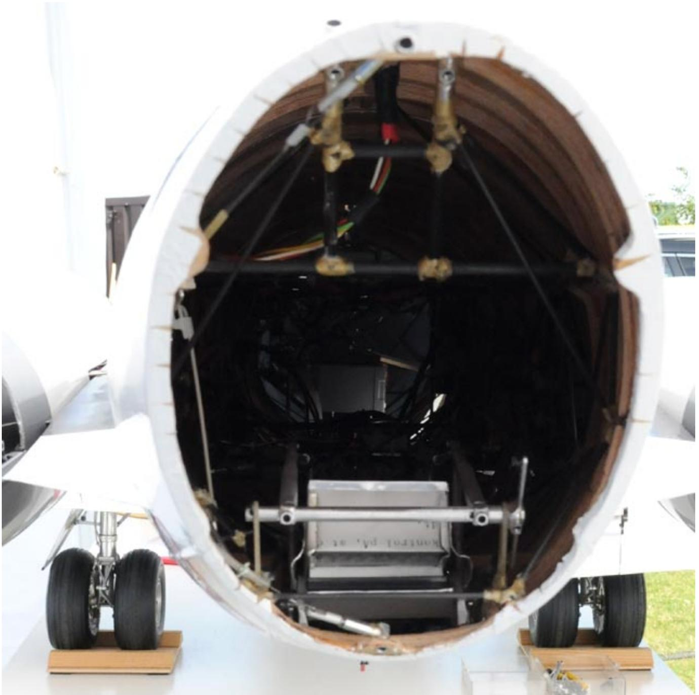
Erwähnenswert ist noch, dass in dem Modell insgesamt 23 Servos verbaut worden sind und zwar: 2 \* Höhenruder, Seitenruder, Bugrad, 2 \* Querruder, 4 \* Vorflügel, 2 \* Flaps und 2 \* Slats, 3 \* Fahrwerk, 1 \* Hauptfahrwerkstüren, 2 \* Bremse, 2 \* Landelichter sowie eines für die hintere Treppe. Es werden zwei 2-S-Lipos als Empfängerbatterien mit einem 6-V-Regler eingesetzt.
