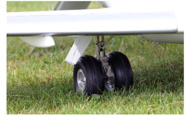
verfügt an den Hauptfahrwerksrädern über Trommelbremsen.
