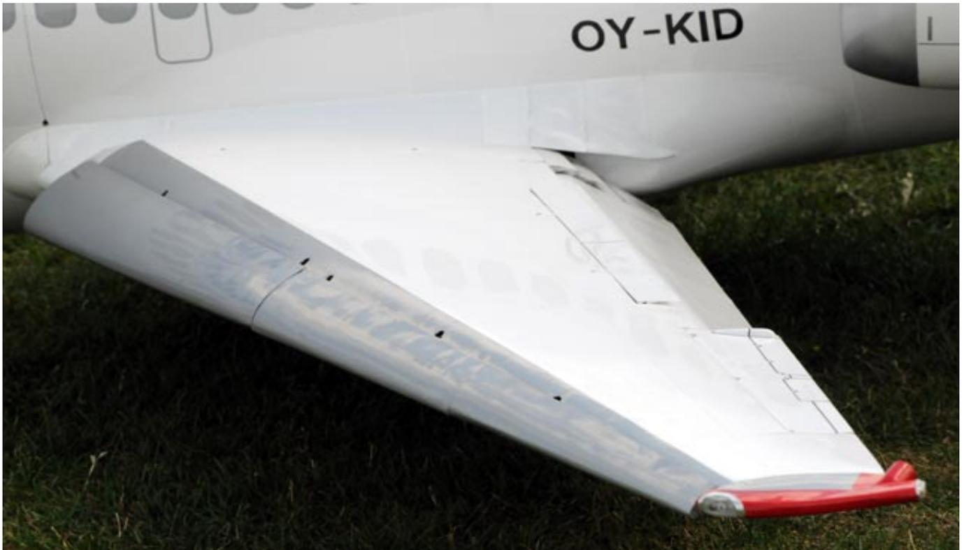
Besondere Aufmerksamkeit wurde verwendet um konstruktiv ein Flattern der Ruder und Klappen zu vermeiden. Dies wurde durch eine Auslegung entsprechender Massen erreicht. Natürlich darf bei einem solchen Modell die Scale-Beleuchtung nicht fehlen und so sind Tip-Landing-Lights, Antikollisionslampen und Positionslichter wie beim Original ausgeführt.
