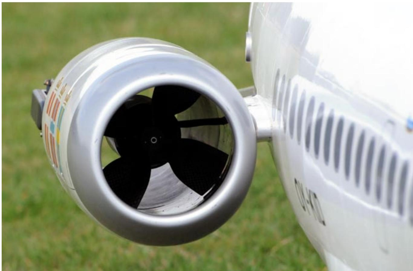
Angetrieben werden die beiden Impeller von je einem Lehner 2240-17, der mit je einem Jeti Spin 99 Regler angesteuert wird. Besonderheit ist hier, dass die Regler im Rumpfinnenen mit Lüfter zwangsgekühlt werden.
