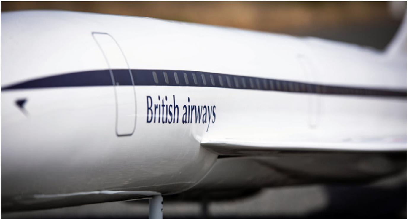
Die Entwicklung begann bereits 2010 und 2013 flog der erste Prototyp mit Styroflächen. Die Concorde wurde ständig weiterentwickelt und das Modell wurde ständig verbessert. So wurden alle Komponenten mittlerweile komplett überarbeitet. Das gesamte Modell wird nun in Vakuum-Sandwichbauweise hergestellt.
