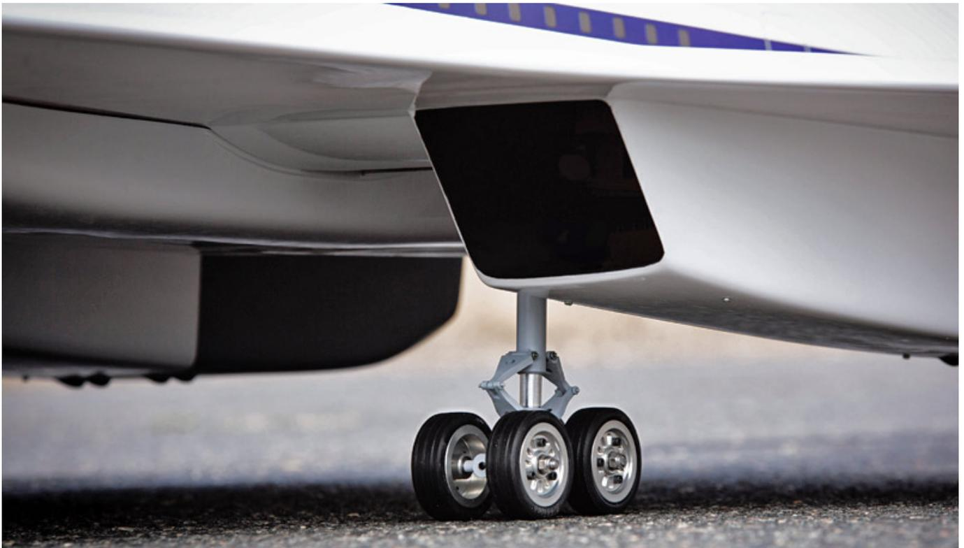
Das Fahrwerk arbeitet elektrisch und besitzt zwei Bremsen pro Hauptfahrwerk, also vier Bremsen insgesamt. Diese Bremsen sind für eine asphaltierte Landebahn erforderlich.
