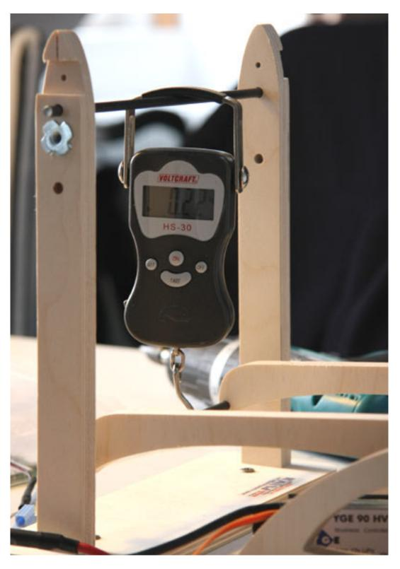
Die Holzklötzen für die Aufnahme des Motor-, bzw. Impellerträgers sind in die Seitenleisten mit je einer Schraube befestigt.
