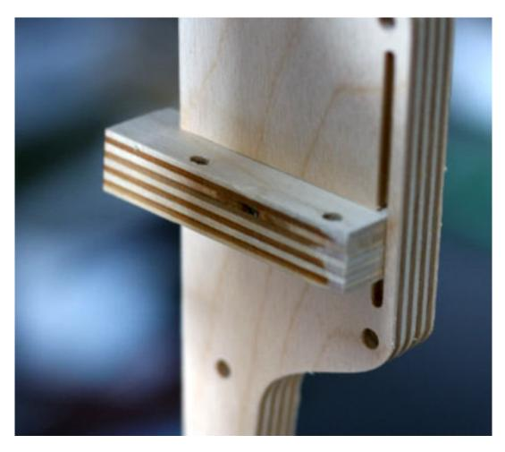
Wenn man Impeller mit unterschiedlichen Befestigungsmaßen testen will, kann man die Klötzchen bei Bedarf tauschen.
