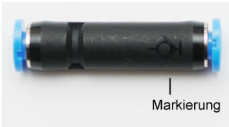
Als Sperrventil wird häufig ein selbstsperrender Steckverbinder (siehe Foto oben) eingesetzt. Es befindet sich auf dem selbstsperrenden Steckverbinder ein Symbol, das kennzeichnet, auf welcher Seite die Luftbefüllung zu erfolgen hat. Es gibt übrigens auch Luftdosen mit Festo-Steckverschraubungen, so dass sich diese bei Bedarf auch wieder lösen lassen.
