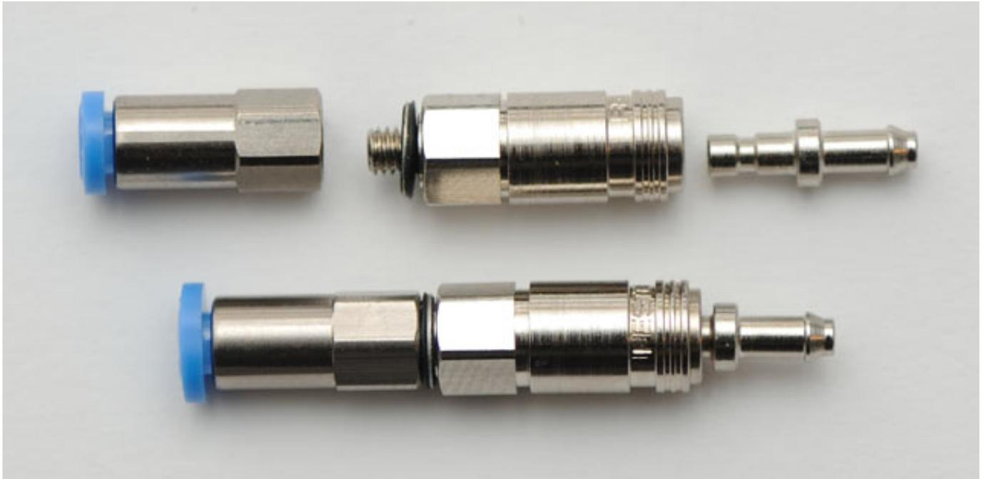
Für die Verbindung zwischen Rumpf und Flügel kann man eine Schnellkupplungsdose mit aufgeschraubtem Steckverschraubung auf der einen und auf der anderen einen Stecker nutzen, wo der Schlauch fest auf den Stecker aufgeschoben wird (siehe Foto oben). Das sind aber nur Beispiele. Man kann natürlich auch auf beiden Seiten eine nicht lösbare Verbindung zum Stecker oder zur Kupplung einsetzen oder auf beiden Seiten lösbare Verbindungen. Die hier gezeigten Beispiele sind aber praxisgerecht.
