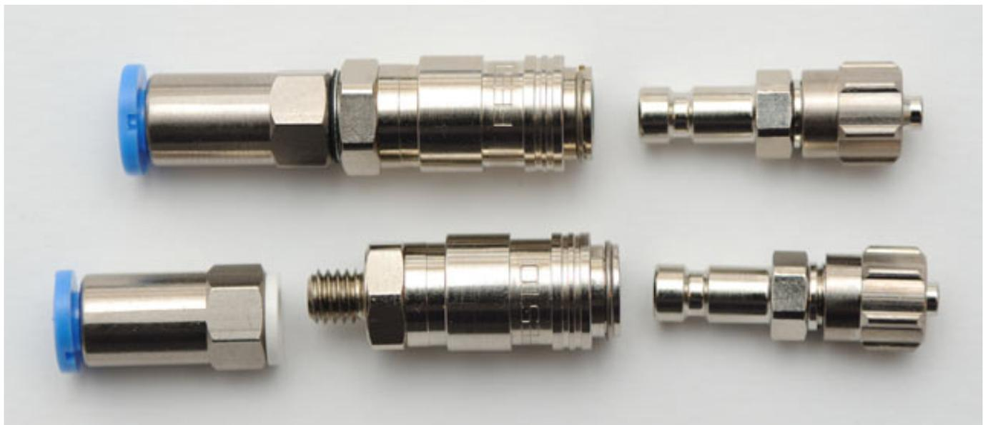
Eine deutlich bessere Lösung sind die Schnellkupplungen KD1/KS1 und KD2/KS2 von Festo, die aus einer Kupplungsdose (links auf dem Foto oben) und einem Kupplungsstecker (rechts) bestehen. Ein wesentlicher Vorteil ist auch, dass die Dosen ebenfalls selbstsperrend sind und man sich so ein Sperrventil erspart.
