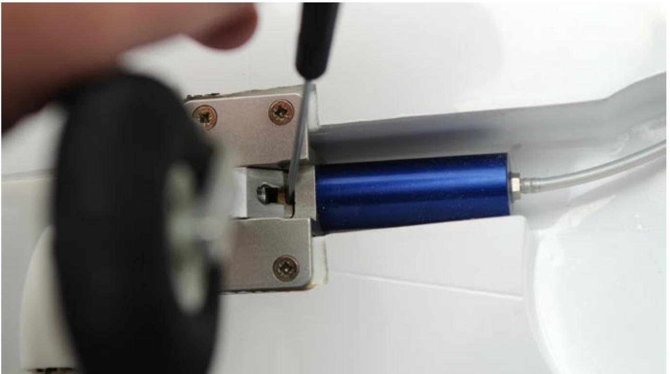
Da bei fehlendem Luftdruck die Beine ausfahren, kann es erforderlich sein, die Fahrwerksbeine, z. B. für den Transport, manuell einzufahren. Hierzu löst man am
