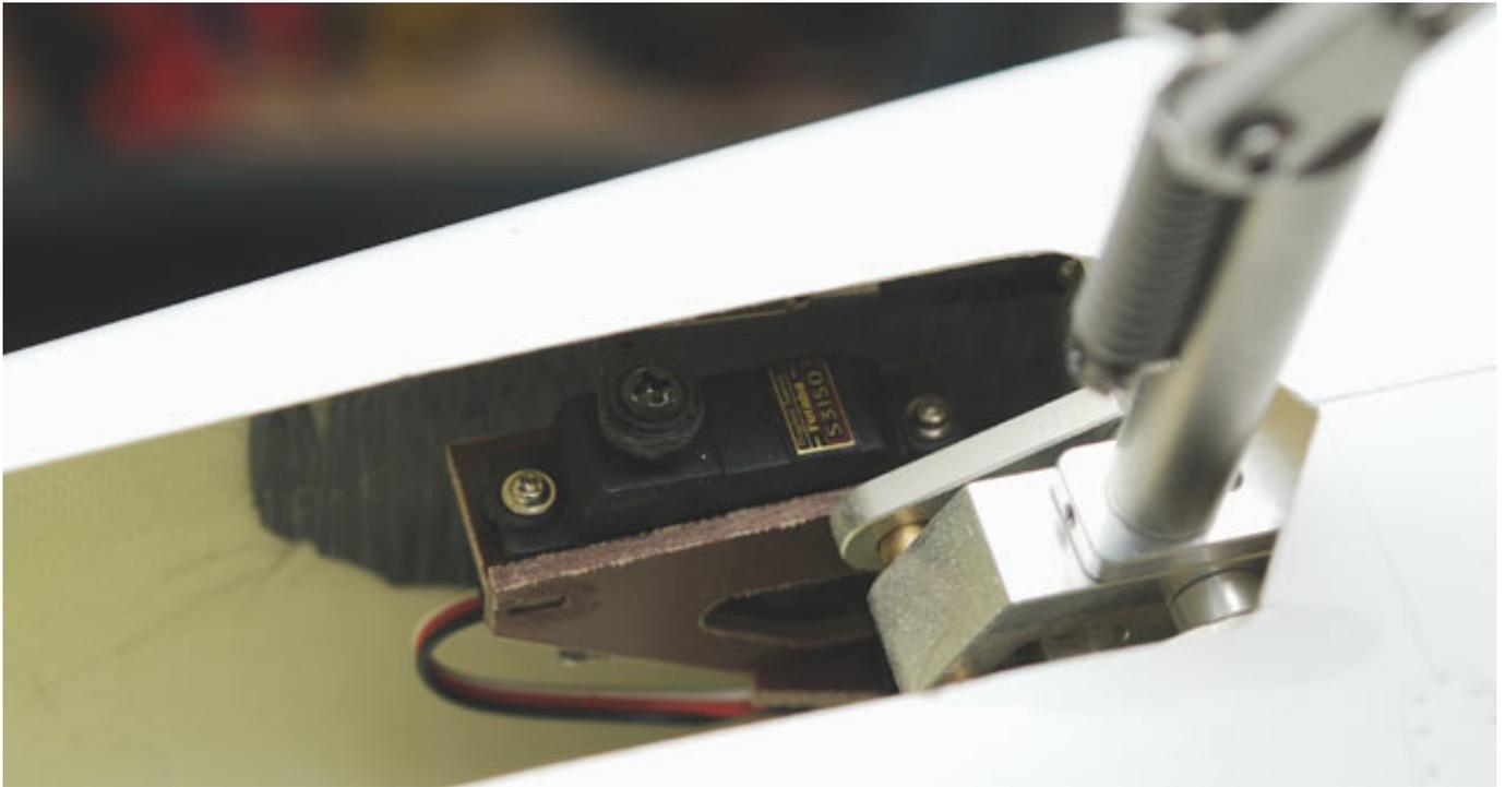
Es gibt aber auch Bugfahrwerksmechaniken, die direkt über einen Hebel bewegt werden, wie hier zu sehen (oben, Fahrwerk einer Savex L-39). Damit ist die ganze Problematik, die eine Seilsteuerung mit sich bringt, gebannt.
