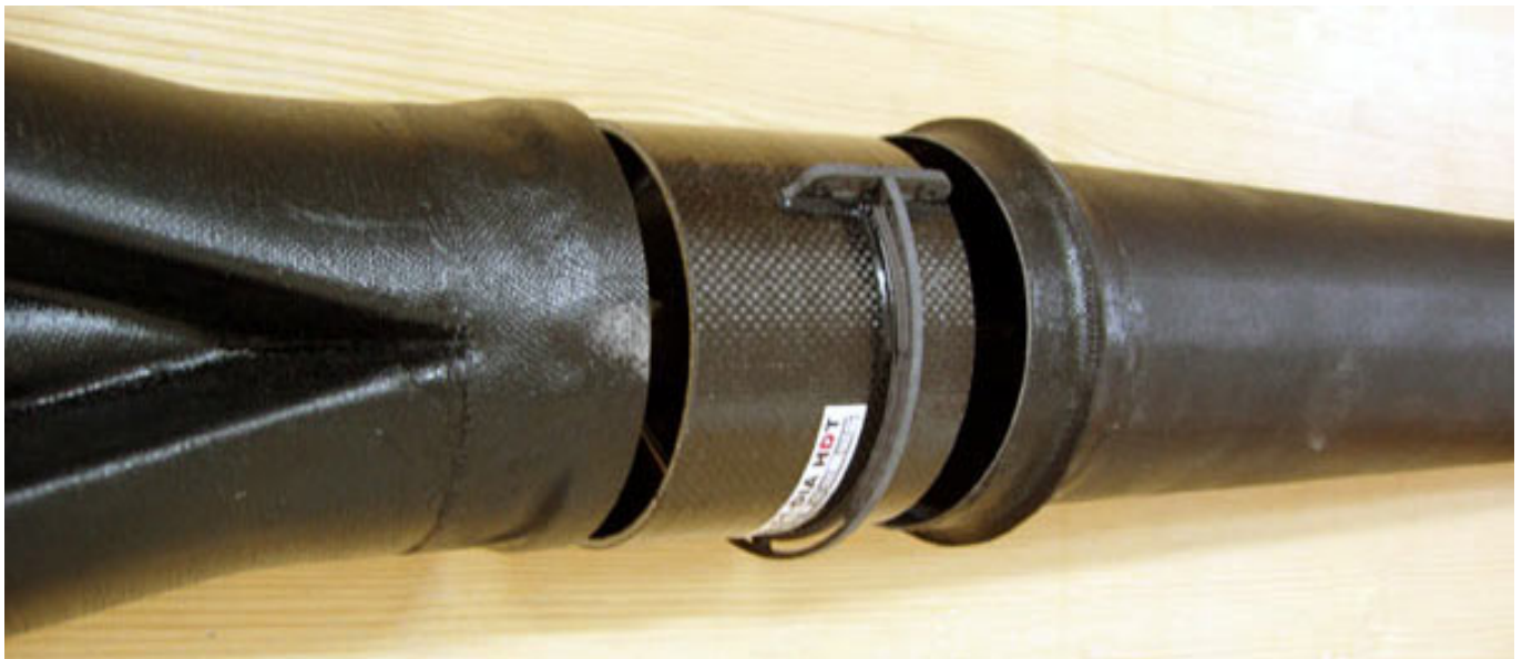
Abb. 6: Luftführung mit Hosenrohr (links), DS-51-DIA HDT Impeller (mitte) und Düse (rechts)
