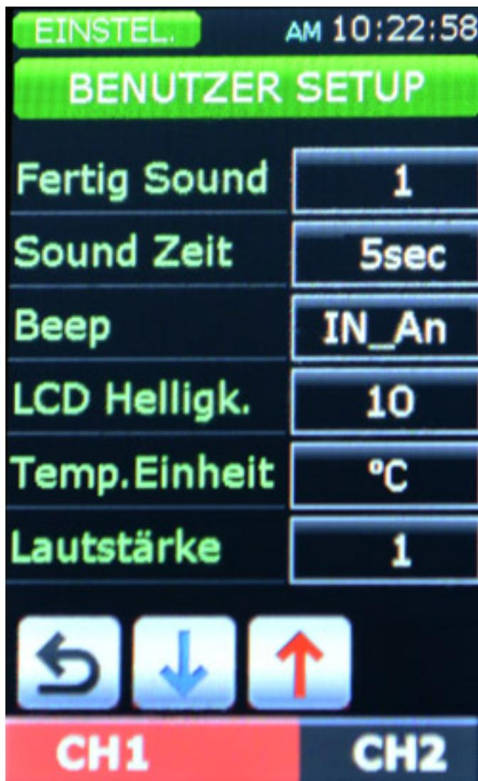
Über das Menü Einstellungen lassen sich Tonausgabe, physikalische Einheiten (s. Abb. oben), sowie sonstige Systemparameter, wie die untere Abschaltspannung (s. Abb. unten), die auf 10,7 V voreingestellt ist oder die Verteilung der Leistung auf die beiden Ausgänge, einstellen. Weiter auch Datum und Uhrzeit. Das Datum wird in der Firmware-Version, die wir zur Verfügung hatten, auch nach dem Update auf die deutsche Firmware, ausschließlich im amerikanische 12-h-Format (AM/PM) ausgegeben.
