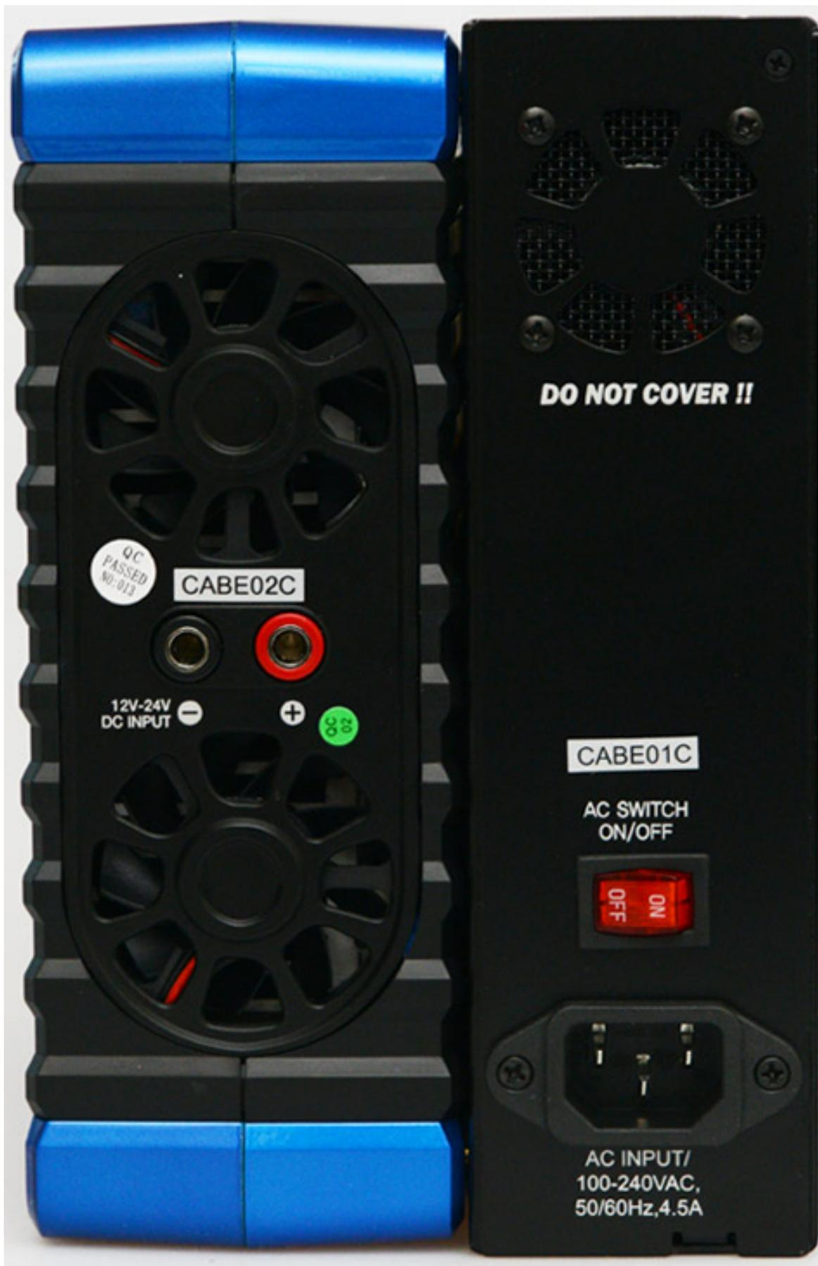
Auf der Rückseite des Ladegerätes (s. Abb. oben links) befinden sich die beiden 4-mm-Buchsen für die Spannungszuführung beim Betrieb ohne ein angedocktes Netzteil. Ein Anschlusskabel sowie zwei Klemmen für den Anschluss an eine Autobatterie oder Ähnliches, gehört ebenfalls zum Lieferumfang.
