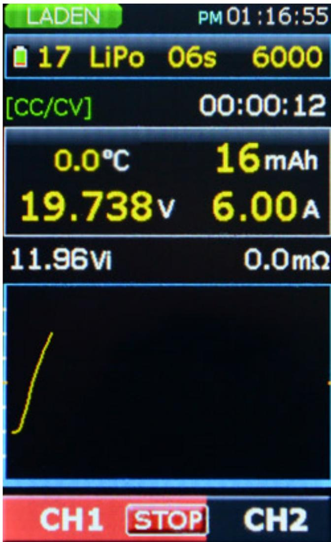
Der Ladevorgang lässt sich mit der virtuellen Stopp-Taste unterbrechen. Ein Antippen auf den Ladestromwert öffnet ein Menü zum Ändern des Ladestrom (Default 1 C).
