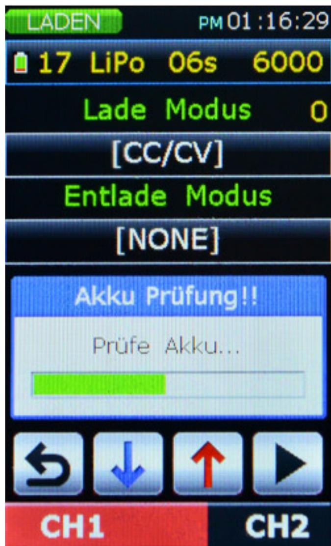
Es erfolgt eine Akkuüberprüfung (s. Abb. oben) und es wird dann anschließend die Anzahl der detektierten Zellen ausgegeben (s. Abb. unten).
