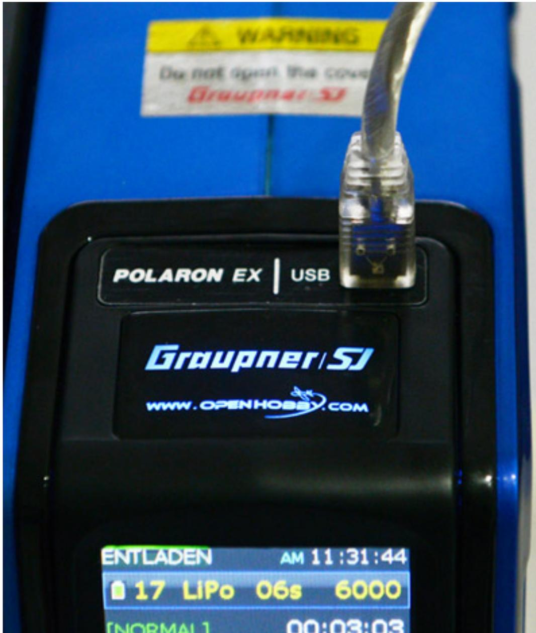
Auf der Oberseite des Ladegerätes (s. Abb. oben) befindet sich noch eine weitere USB-Buchse. Diese ist für den Anschluss eines PCs gedacht. Dazu später mehr. Fast schon unnötig zu erwähnen, dass auch dieses USB-Anschlusskabel dem Ladegerät beiliegt.
