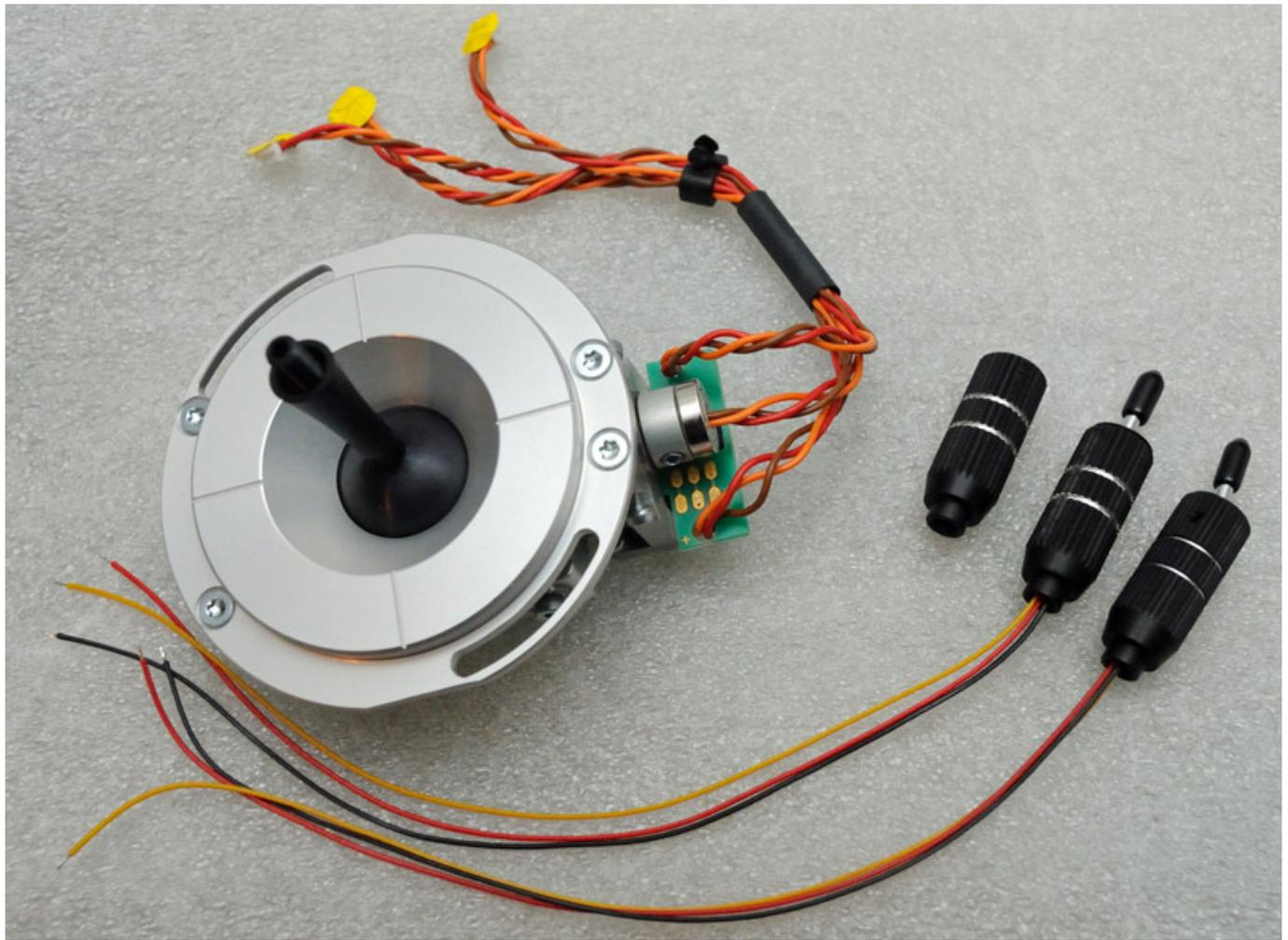
Es lassen sich auch in den Knüppeln optionale Bedienelemente einbauen. Es werden mittlerweile Schalter mit zwei und drei Positionen (s. Foto oben), Drucktaster und auch ein kleiner Proportionaldrehgeber zur Nachrüstung für die Knüppel angeboten.
