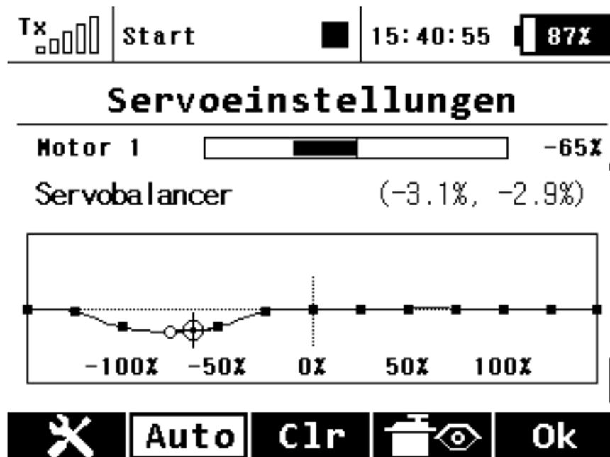
Ab der Version 2.2 ist nun auch ein Servo-Matching über den Servo-Balancer möglich (s. Abb oben). Um die Einstellung hierfür zu erreichen muss man im Menü Servoeinstellungen einfach nach ganz unten scrollen und die entsprechende Grafik erscheint. Zuvor sollte man betreffenden Servos in dem Menü Servozuordnung einer Servogruppe zuordnen.
