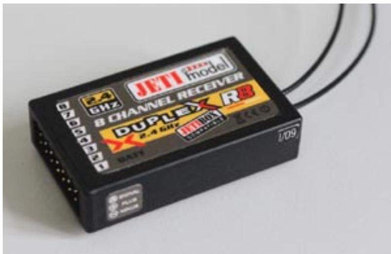
Der R6 und R8 haben die gleiche Bauweise (Foto oben ein DUPLEX R8-Empfänger) und die Pfostenleiste für die JR-Servostecker stehen an der Seite den Empfängers zur Verfügung. Auf der gegenüberliegenden Seite befindet sich noch der Anschluss für den Telemetriesensor, bzw. die Binding-Steckbrücke.
