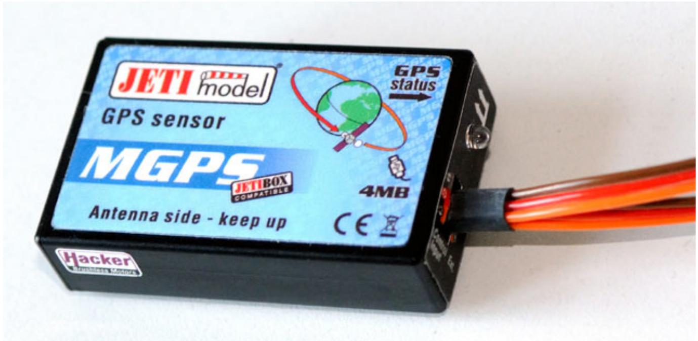
Dank der Miniaturisierung von GPS-Chipsätzen kommen auch wir Modellbauer in den Genuss dieser Technik. So bietet auch Jeti seit kurzem mit dem MGPS einen GPS-basierenden Sensor für sein Duplex-System an, welches mit Software-Unterstützung nähere Aufschlüsse über Flugeigenschaften und Flugraumnutzung gestattet.
