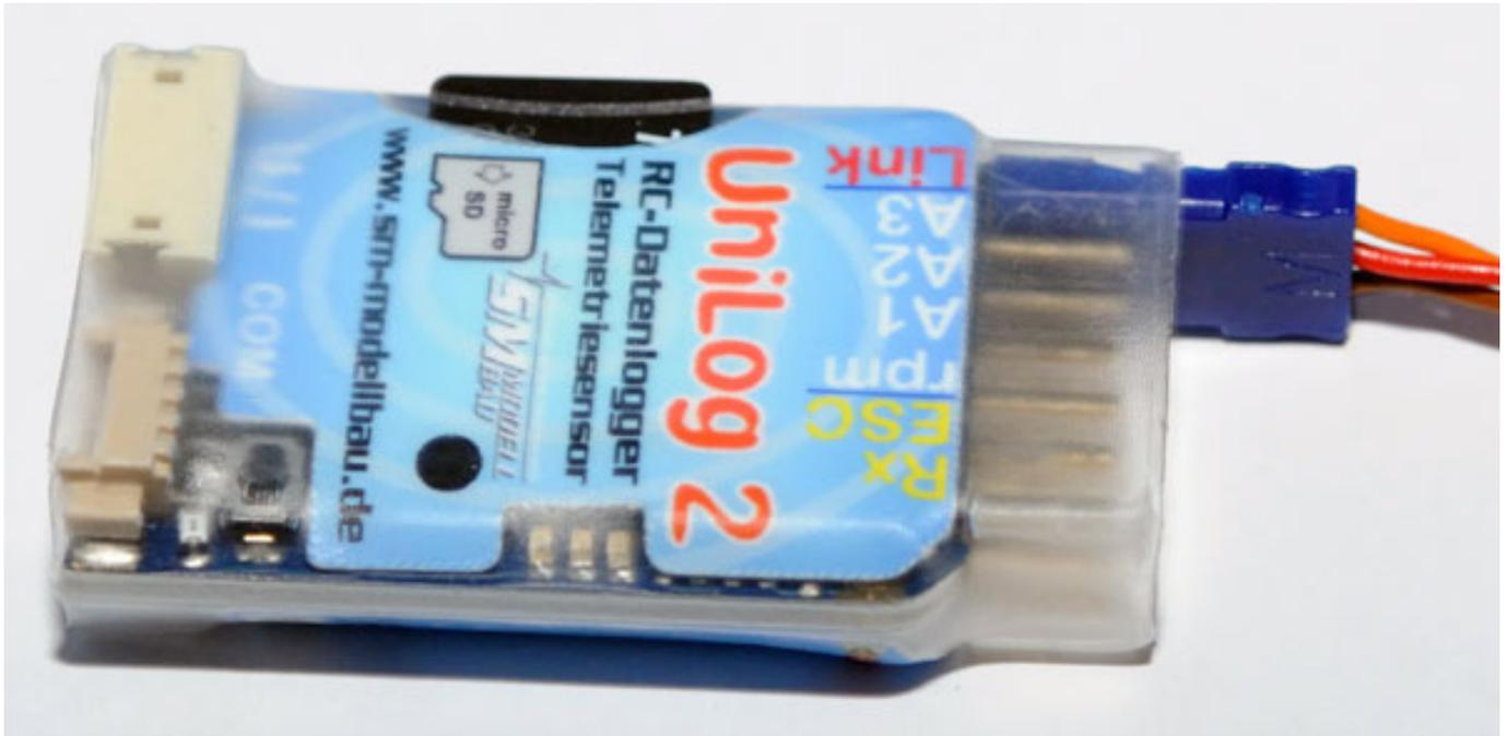
Schon die erste Version des UniLog von SM-Modellbau ist in der Elektroflugszene sehr beliebt gewesen. Nun gibt es mit dem UniLog 2 seit 2012 die Nachfolgeversion. Das Interessante am UniLog 2 ist, dass er nun direkt, und ohne zusätzliches Interface, an die Empfänger des Jeti Duplex, Multiplex M-Link und Graupners HoTT angeschlossen werden kann. Wir haben den UniLog 2 mit der Jeti DC-16 Fernsteuerung und dem Jeti Duplex EX-Protokoll getestet.
