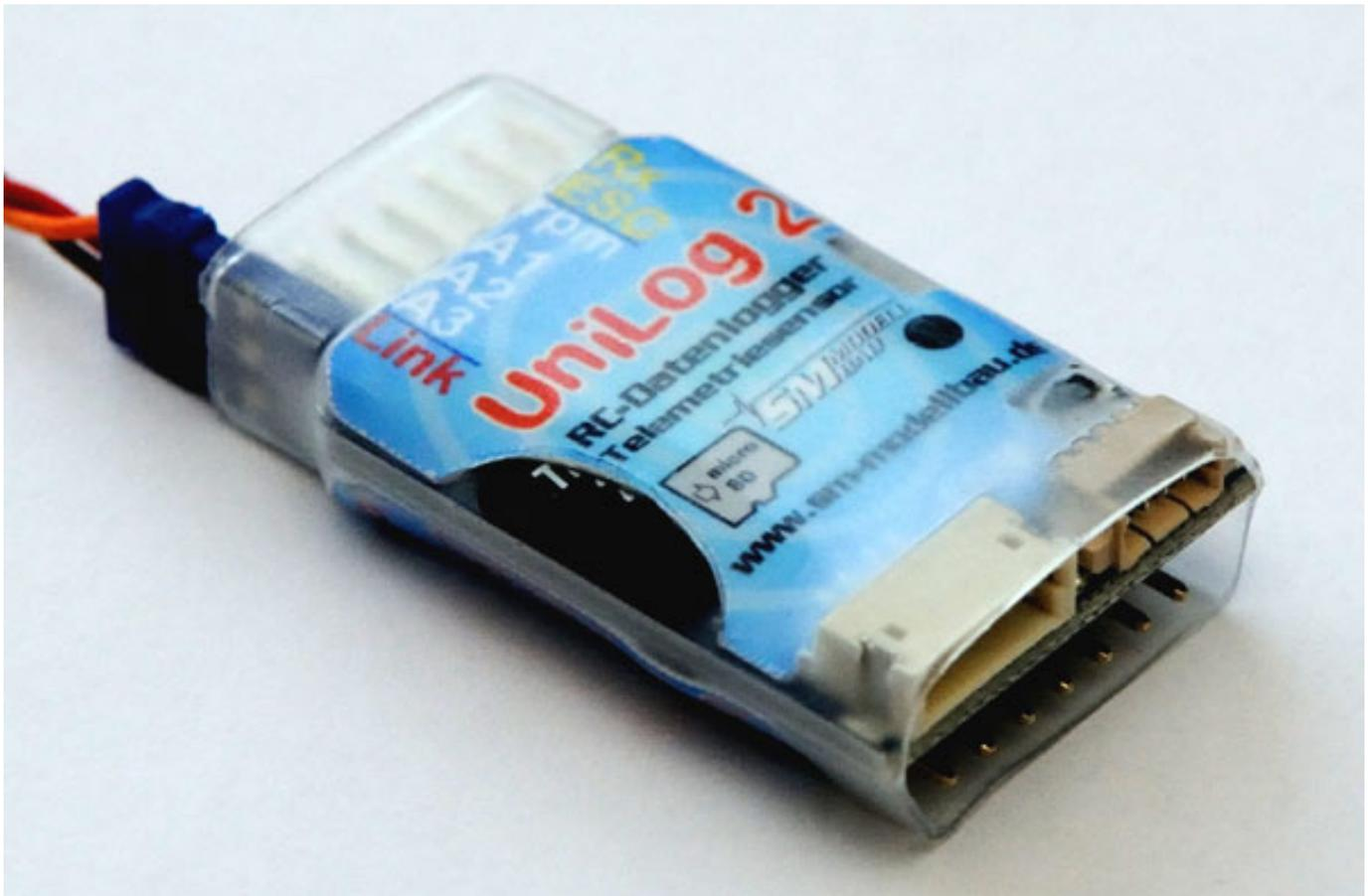
Werfen wir einmal einen Blick auf den UniLog 2 und seinen diversen Anschlüssen. Auf der Front (s. Abb. oben) befindet sich eine kleine Steckleiste mit der Bezeichnung "COM" für den Anschluss des UniDisplay oder eines PCs. Weiter lässt sich hier auch der GPS-Sensor von SM-Modellbau anschließen. In Verbindung mit dem Jeti Duplex EX System ist es allerdings beim Einsatz des SM GPS-Sensors erforderlich, UniLog 2 und GPS-Sensor über einen Jeti-Telemetrieexpander E4 EX an den Empfänger anzuschließen.
