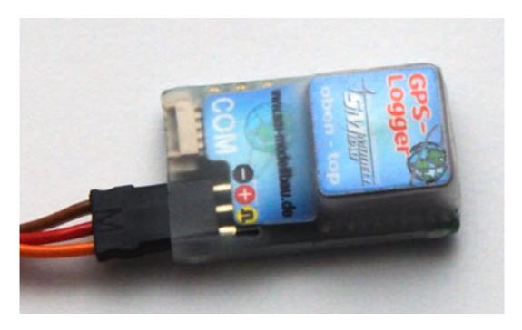
SM-Modellbau bietet nun auch einen GPS-Sensor mit internem Logger. Hierfür verfügt das lediglich 32 x 21 x 11 mm kleine und nur elf Gramm schwere Modul über einen Steckplatz für eine micro SD- oder SDHC-Speicherkarte. Eine Karte mit einer Kapazität von 2 GByte gehört dabei zum Lieferumfang. Der Stromverbrauch liegt bei moderaten 70 mA.
