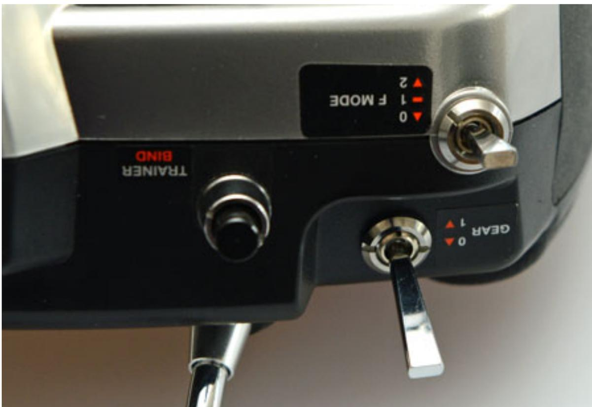
Hinten befinden sich auf einer Seite der Kippschalter für das Fahrwerk (Gear), ein Schalter für den Flight-Mode (für Heli gedacht) sowie den Binding-Taster. Das Binding startet man in dem zunächst der Empfänger angeschlossen und die Binding-Brücke gesteckt wird. Beim Einschalten des Senders ist nun die Bindig-Taste zu drücken und das Binding startet. hervorzuheben ist, dass in dem Modellspeicher auch der Empfänger des Modells eingetragen wird. Stimmen Empfänger im
