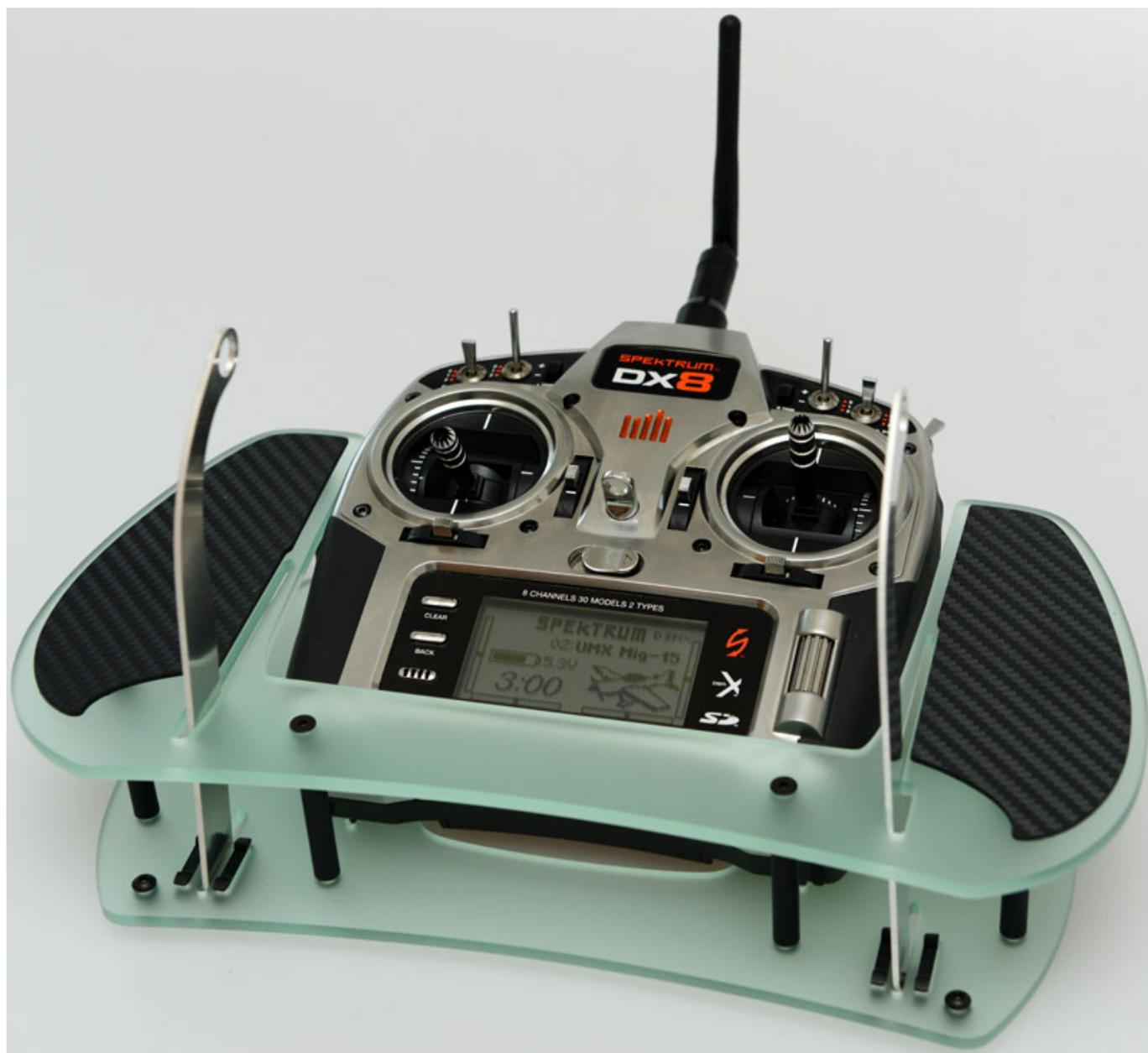
Für manche Piloten dürften die Knüppelhebel etwas kurz sein - gerade auch im Betrieb mit einem Senderpult. Abhilfe schaffen hier die 34 mm langen optionalen Steuerknüppel von Spektrum (SPMA4001), die also 10 mm länger sind als die Originalknüppel.
