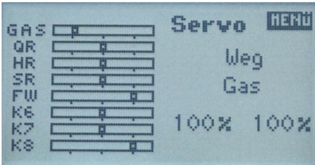
Über D/R-Expo kann der Pilot für die Servos eine Dual-Rate und ein Expowert eingeben. Diese sind auch von den drei Dual-Rate-Schaltern abhängig, d. h. es lässt sich für jede Schalterstellung getrennte Dual-Rate und Expo-Werte einstellen.
