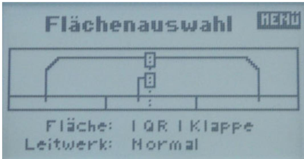
Als nächstes wird die Flügel/Leitwerkskonfiguration ausgewählt. Hier im Beispiel eine Fläche mit einem Querruder- und einem Klappenservo. Es lassen sich auch Flächentypen mit bis zu zwei Querrudern und zwei Klappen sowie ein Elevon-Modus anwählen. Für den Betrieb mit einem Deltaflügel wählt man den Elevon-Modus aus und kehrt für das rechte Ruder die Servodrehrichtung um.
