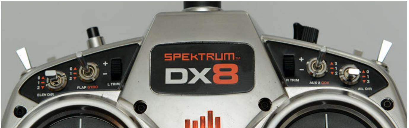
Schauen wir uns einmal die Schalterfunktionen für Flächenmodelle genauer an. Oben links gibt es einen Kippschalter mit drei Stufen für Klappen- oder Gyro-Steuerung und auf der gegenüber liegenden Seite einen Aux-Schalter für Zusatzfunktionen (s. Abb. oben). Außen befinden sich weiter zwei dreistufige Schalter für Höhen- und Querruder-Dual-Rates.
