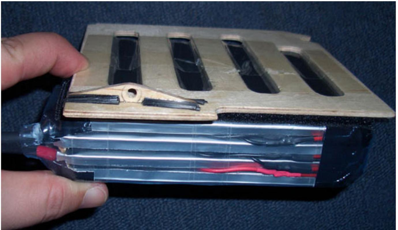
Hier noch ein Foto mit der Akkuhalterung und den Akkus im Rumpf befestigt. Man sieht, dass es im Rumpf schon sehr eng zugeht und der Akku darf nicht breiter als 40 mm sein, sonst besteht die Gefahr, dass sich der Einlauf durch den Akku staucht.
