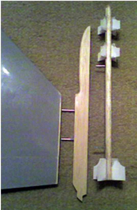
Steffen hat sich entschlossen den Raketenträger und die Rakete selbst über Stahlstifte zu befestigen, da eine Abbruchgefahr durch die exponierte Außenposition gegeben ist. Der Flügel ist an der Seite offen und es wurde ein Randbogen aus Balsa eingefügt und Löcher für kleine Röhrchen gebohrt, die dann die Stifte aufnehmen. Das selbe Prinzip wurde auch für die Verbindung Rakete zu Raketenträger angewandt. Da alles gesteckt ist, besteht so nicht mehr die Gefahr, dass etwas abbricht.
