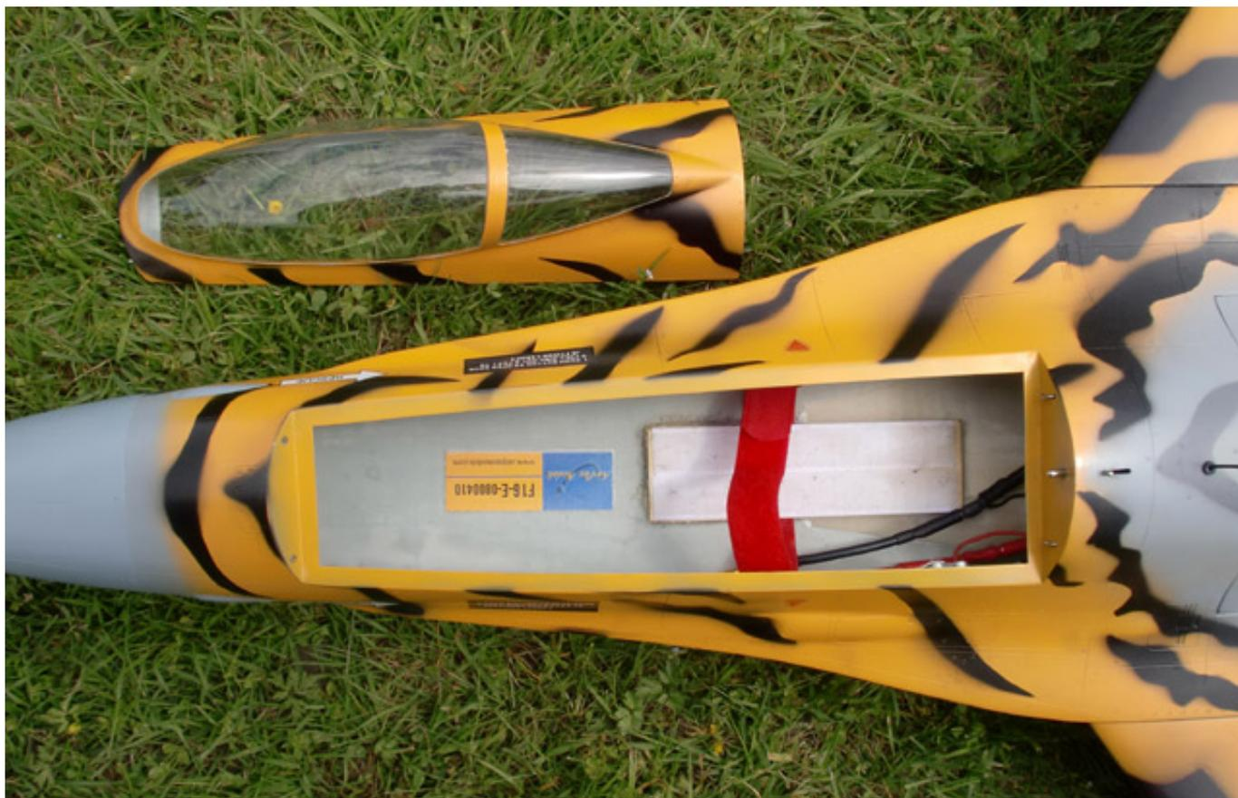
Für die Akkubefestigung hat Stephan ein Hozbrettchen eingeklebt. Der Akku wird über ein Klettband befestigt. Die Haube wird vorne über zwei Stifte gehalten und hinten über eine Kabinenhaubenverriegelung fixiert. Der Empfänger wird im Bereich des Impellers in eine Aussparung eingelegt und befestigt.
