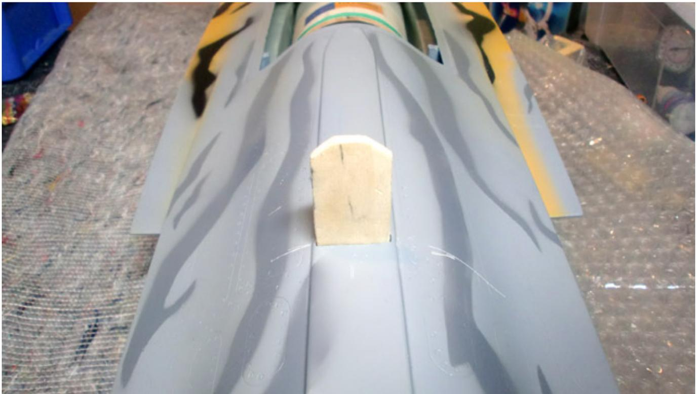
Nun wird das Seitenleitwerk sauber aufgesetzt und dann mit Harz oder Epoxy verklebt (s. unten).
