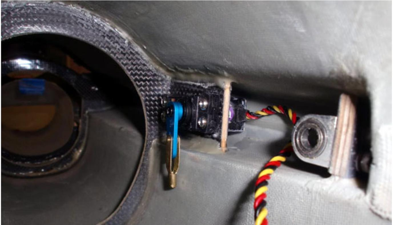
Der Hilfsspannt für das Seitenleitwerk muss selbst nach einer Papiervorlage ausgesägt werden. Dann wird der Spant eingeklebt nach dem man den entsprechenden Ausschnitt gemacht hat.
