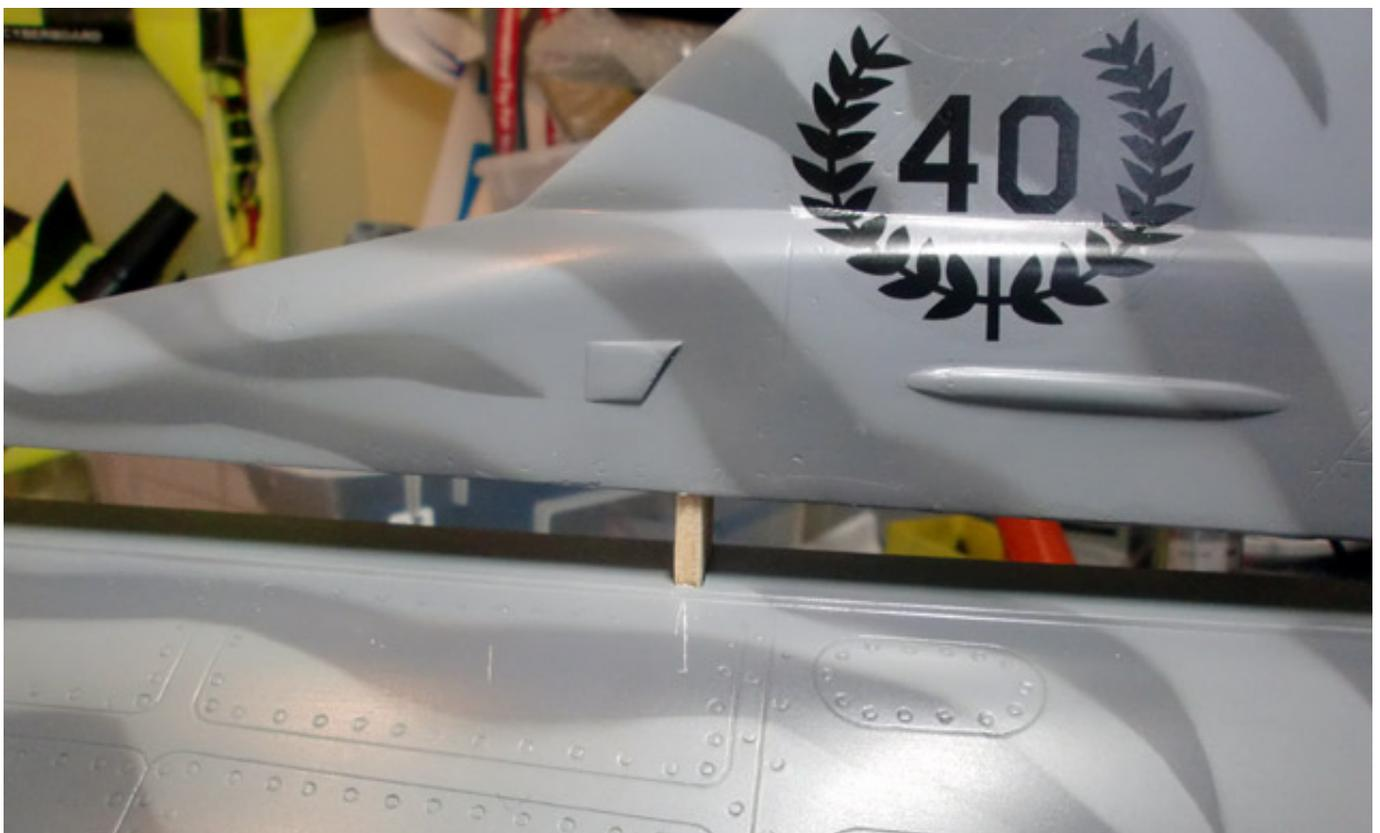
Nun werden die beiden Flächen angeklebt. Vorher sind die zu verklebenden Stellen an den GFK-Teilen abzuschleifen. Ganz zum Schluss werden die Tailerons eingebaut. Etwas schwierig ist dabei das Festklemmen der Anlenkhebel für die Tailerons. Als Letztes wird dann der Impeller in die vorbereitete Aufnahme montiert und das Schubrohr von hinten eingeschoben und aufgesetzt.
