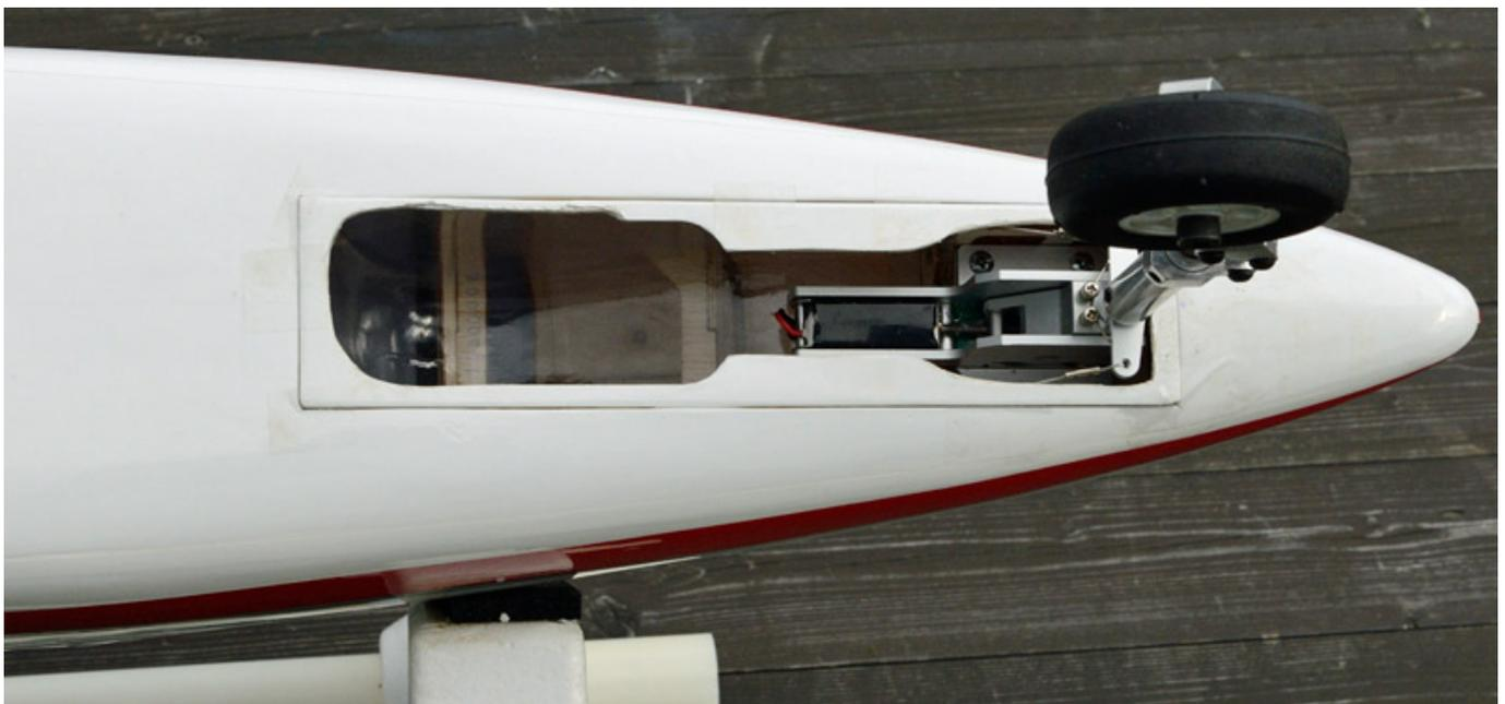
Die Anlenkung erfolgt über Seile. Beim E-flite 60-120 muss man dazu noch die vorgesehene angeschraubte Anlenkmechanik entfernen um beide Löcher für den Anlenkdraht frei zu haben. Sowohl Stahlkabel als auch Hülsen und Serovbefestigungen liegen dem Bausatz bei. Die Hülsen fixiert man am besten mit
