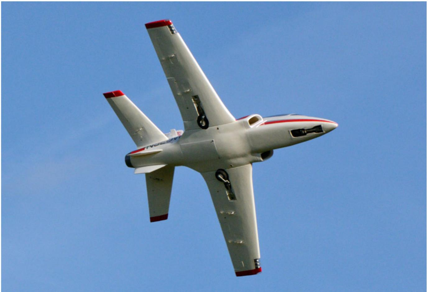
Die Geschwindigkeit bei dem Antrieb ist im mittleren Bereich. Um es scale zu fliegen braucht es aber auch keine hohe Geschwindigkeit, denn die Höchstgeschwindigkeit des Originals lag bei lediglich 700 km/h, was bei dem Modellmaßstab eine Modellgeschwindigkeit von ca. 120 km/h entsprechen würde. Wir haben mit GPS im Geradeausflug max. 150 km/h gemessen und aus Abwärtsfiguren auch mal 190 km/h. Das sollte doch wohl für ein Kunstflugmodell mehr als reichen.
