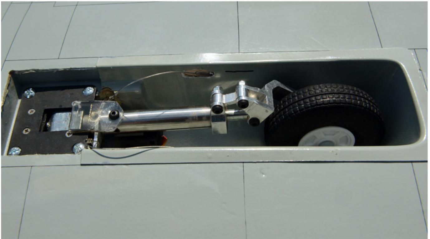
Alles kann nun in den Rumpf geschraubt werden und das Servo wird mit den Litzen am Doppel-Servohebel verbunden.
