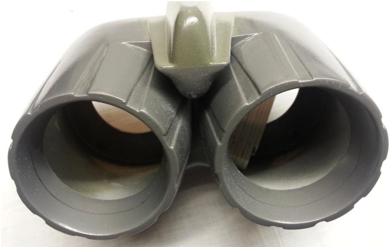
Wir haben aus der üblichen Schubrohrfolie mit 0,4 mm neue Schubrohre gefertigt und an das gekürzte Hosenrohr geklebt. Danach wurden diese Rohre mit einer Sprühdose mattschwarz anlackiert und nach dem Trocknen konnte alles wieder vernünftig montiert werden. Aber zuvor haben wir zur Montage der äußeren Schubdüsen Bohrungen vorgesehen.
