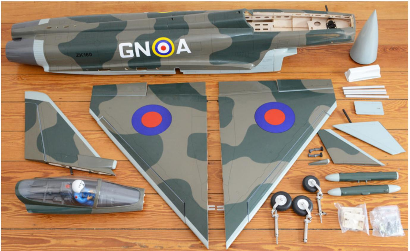
Der Bausatz besteht aus mehreren Teilen, welche größtenteils sauber mit bedruckter PVC-Folie bespannt sind. Ferner sind sämtliche Zubehörteile zum Bau im Set enthalten.
