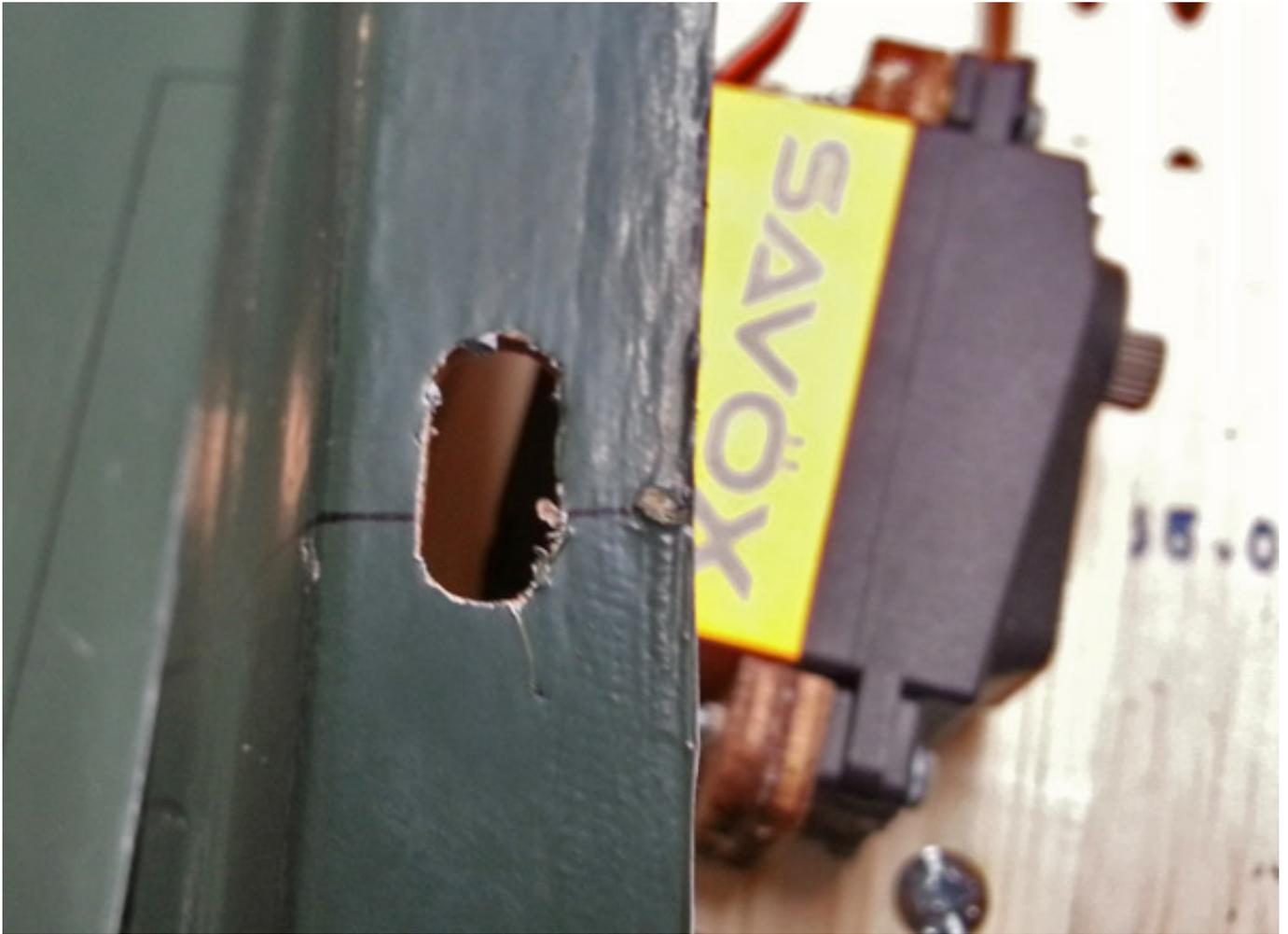
Die beiliegenden Steuergestänge können nun angebracht und eingestellt werden. Danach werden die Canards mit den Hebelwerken per Madenschrauben verbunden und fixiert.
