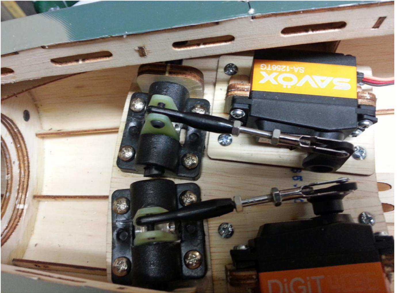
Die Nullstellung ist am Rumpf mit Anformungen festgelegt. Diese Stellung wurde später vorn etwas angehoben. Im Gegensatz zur vorgegebenen Mittelstellung nun mit 2,5 mm auf Höhe.
