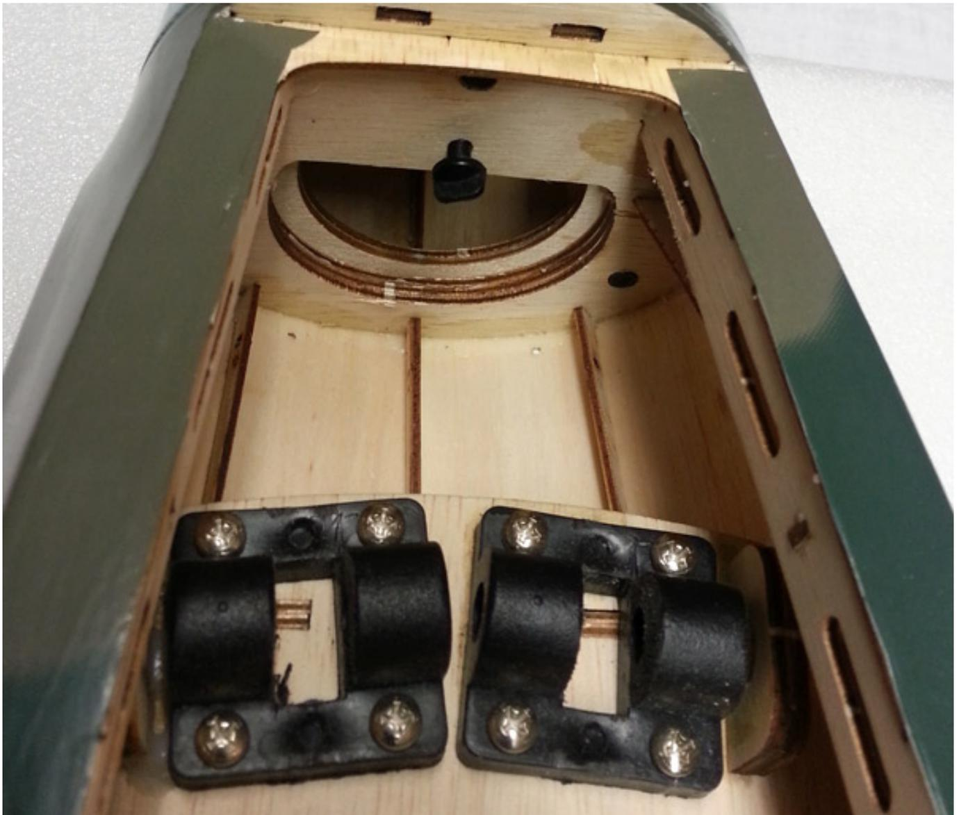
Die Canards sind stabil gebaut und werden in robusten Halterungen gelagert. Vorgesehen ist eine Pendel-Anlenkung in Entenkonfiguration.
