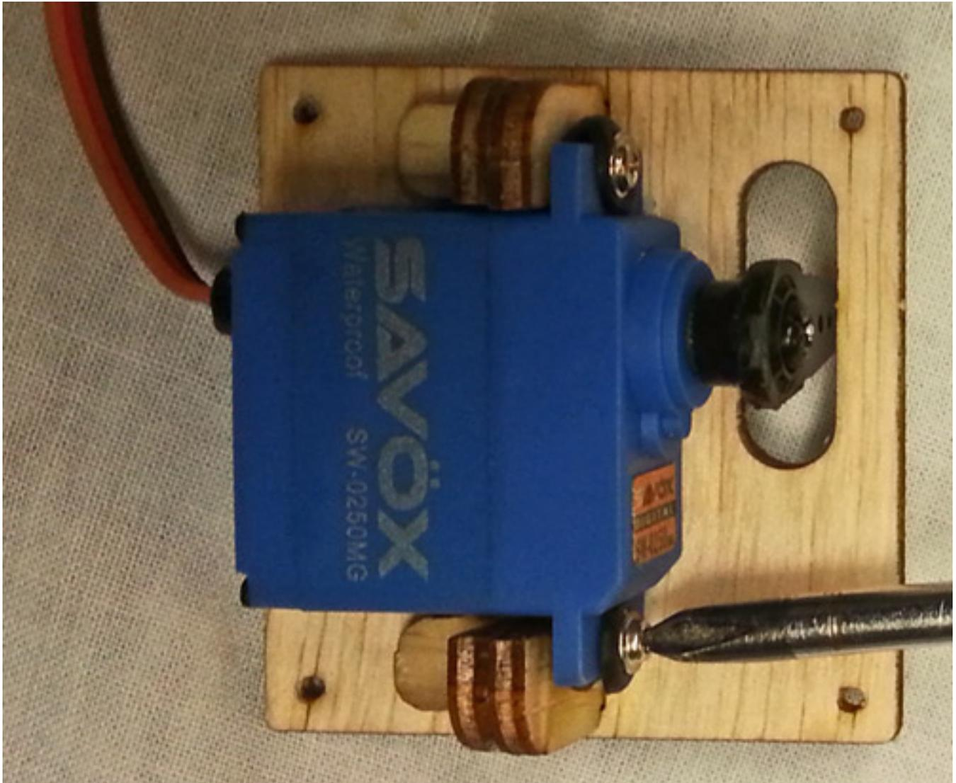
Die Deckel werden mit den Servos verschraubt und die Anlenkungsgestänge montiert. Alles passt gut und ist von solider Qualität. Allerdings war eine der Abdeckungen bei der Vorfertigung falsch gefräst, den Schlitz für den Servoarm hatte man falsch positioniert.
