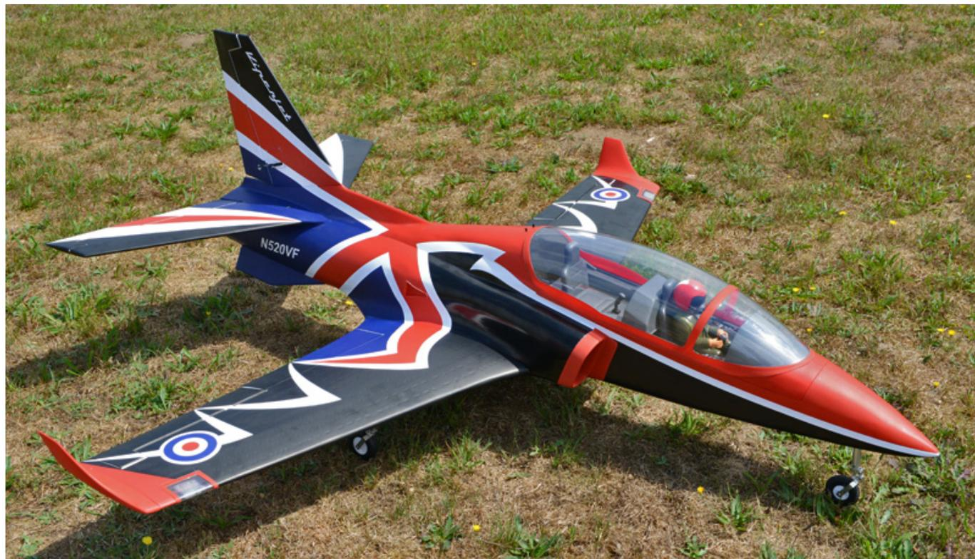
Das Modell wird als ARF-Version angeboten mit komplett fertiger Folienbespannung. Es kommt dem Original schon sehr nahe und als Dekor thront auf der Viper der Union Jack. Das Modell ist für 120-mm-Impeller ausgelegt und in Holzbauweise aufgebaut. Die Firma Pichler hat uns das Modell für den Test bereitgestellt.
