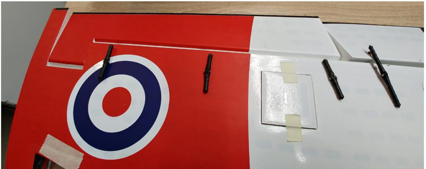
Bei den Landeklappen sind die längeren Stiftscharniere im Winkel zu montieren. Diese schauen zu gut einem Drittel aus den Bohrungen heraus und erzeugen dadurch einen außen liegenden Drehpunkt. Die Klappen müssen beim Verkleben der Scharniere auf korrekte Funktion getestet werden. Hier wieder wie gewohnt ein wenig Öl auf die Scharnier-Drehpunkte geben.
