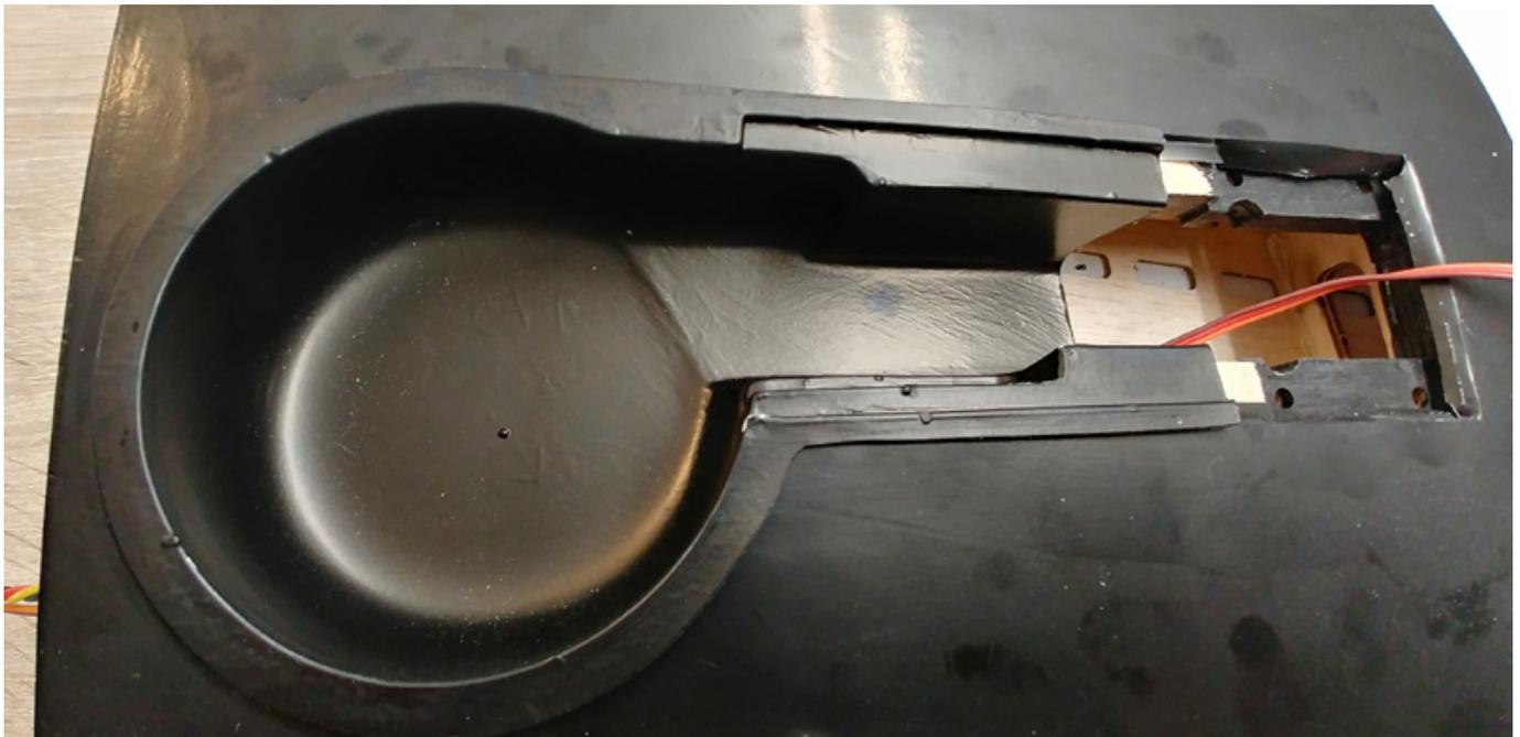
Beiliegende Radschächte werden eingeklebt. Wir montieren die Servos für Querruder, Landeklappen in allgemein üblicher Weise an die vorgefertigten Servoabdeckungen. Sehr schön sind die für alle Servos vorverlegten Fäden, an denen die Kabel durch die Hohlräume der Flächen gezogen werden können.
