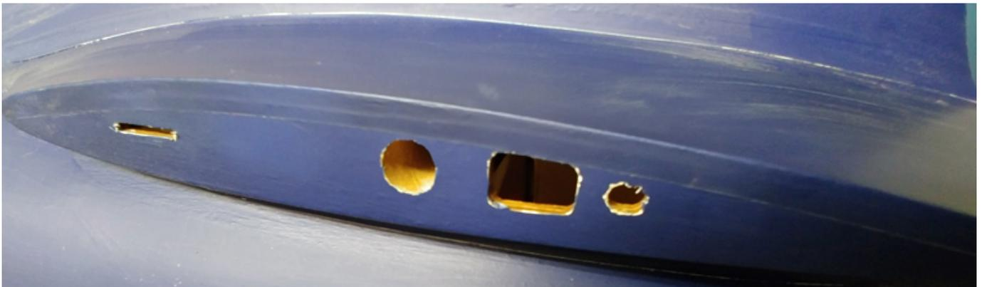
Die Nullstellung der Leitwerke ist am Rumpf durch Anformungen festgelegt. Der Rumpf ist fertig ebenfalls aus Holz gebaut und sehr gut verarbeitet. Es sind die Teile wie zum Beispiel die Lufteinläufe und die Kühleinlass-Attrappen anzukleben. Die untere Revisionsklappe ist fertig eingepasst und mit zwei Verschlüssen versehen. Der Raum für die Impellereinheit ist sehr gut zugänglich. Nun konnte der Impeller schon einmal probesitzen. Er passt gut auf den vorbereiteten Längsträger.
