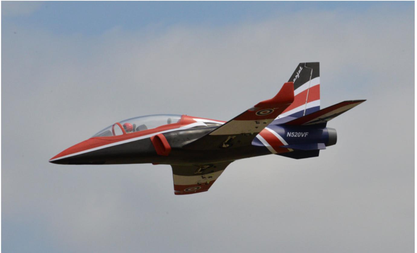
Den Antrieb den wir benutzt haben ist deutlich übermotorisiert. Der gleiche Impeller mit der Bezeichnung „DS-86-AXI HDS mit dem Tenshock X-501/6 ist die bessere Option, denn diese Kombination bietet ausreichende Leistung bei wesentlich geringerem Strom von ca.120 A und dadurch auch eine längere Flugzeit.
