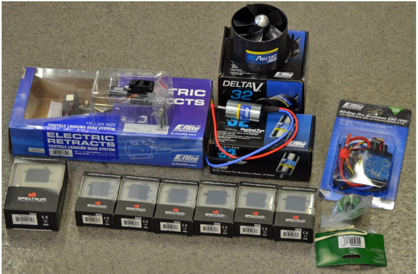
Für unser Testmodell wurde das vom Hersteller empfohlene Zubehör verwendet, bestehend aus: Delta 32 Impeller, Delta BL 32 Motor, E-flite 80-A-Steller mit BEC, 6 Stück Spektrum Servos A4010 von und ein Servo A5040 für das Höhenruder, Einziehfahrwerk EFLG 230, sowie eine Pilotenbüste.
