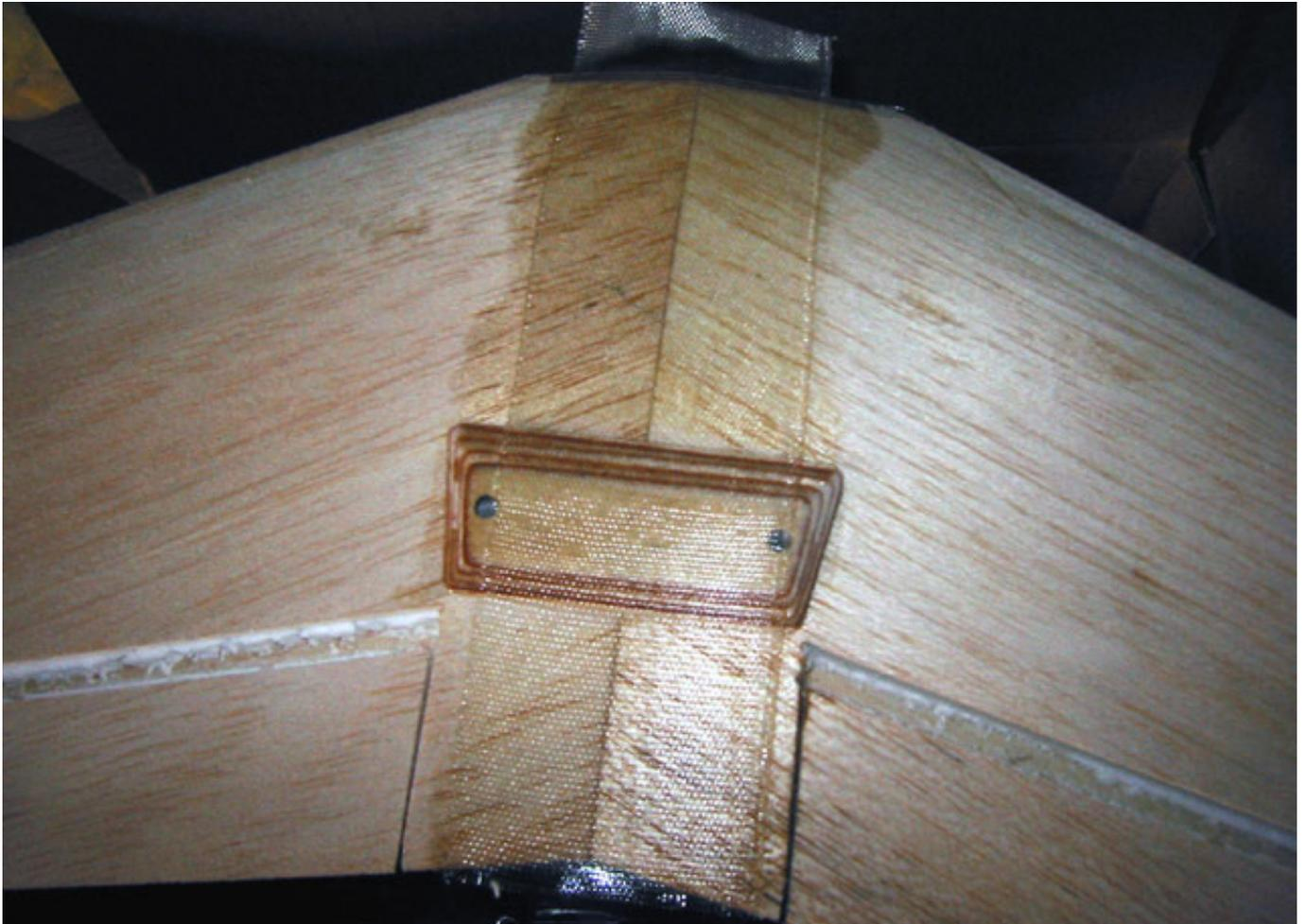
Die Impeller- und Fahrwerksaufnahmen sind aus sauber gefrästen Holzteilen erstellt, die auch einer sehr simple aber sinnvolle Weise zusammengeleimt werden und saugend an ihre Plätze passen. Zwischen der Rumpfwand und dem Impellerspant war rundherum noch ein halber Millimeter Platz, den es braucht um das Teil exakt auszurichten und mit eingedicktem Harz zu verkleben.
