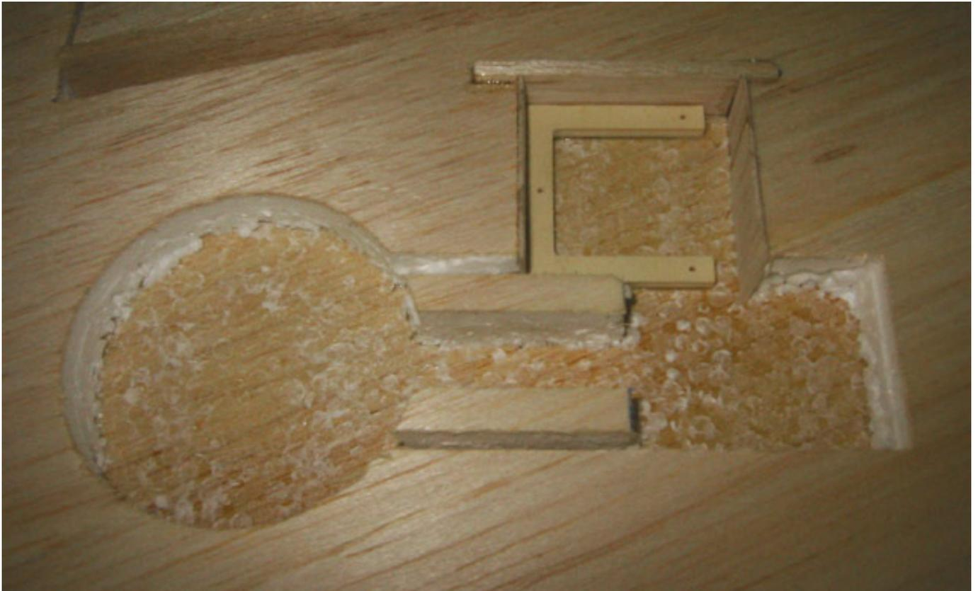
Als Fahrwerk verwendete Chris das pneumatisches WeMoTec Mini 45 mit elektronischem Ventil. Die gefrästen Holzteile passen genau für die Mechaniken, so dass sich der Einbauort von alleine ergibt.
