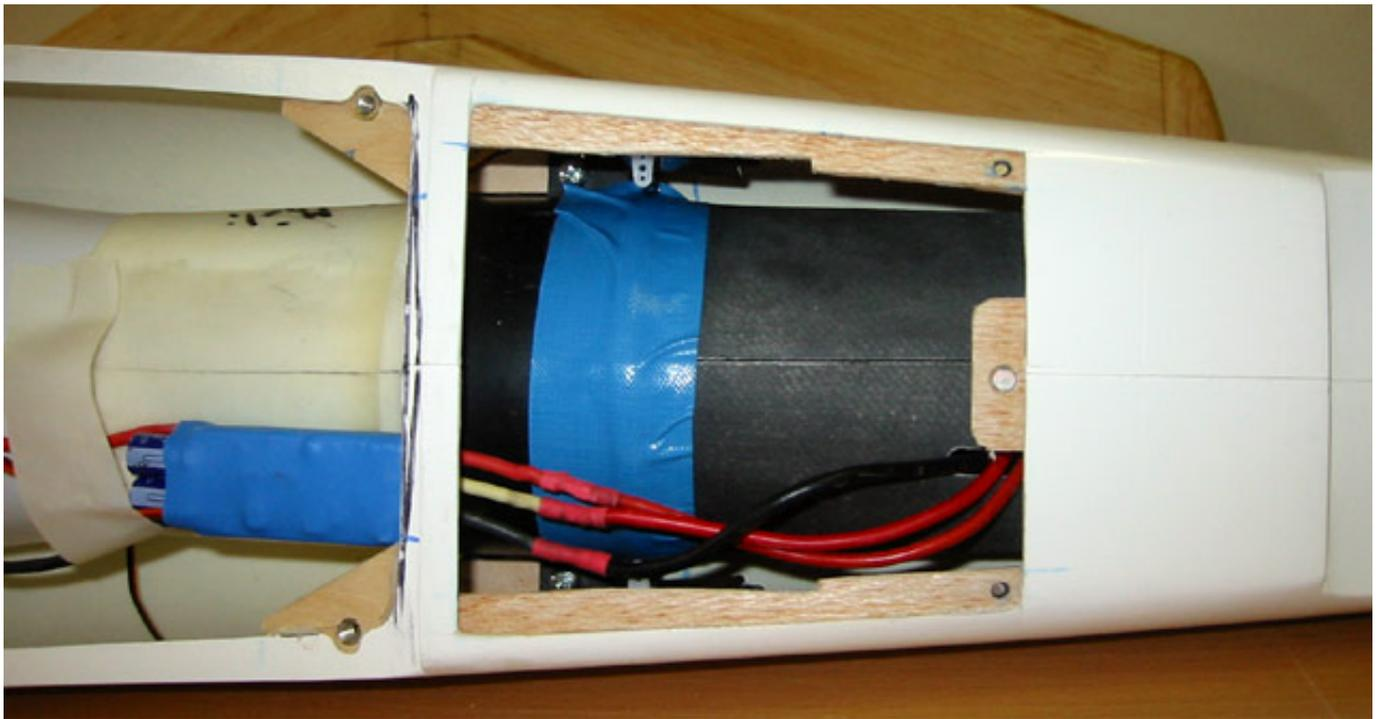
Der Regler wird einfach auf dem Einlaufkanal befestigt.
