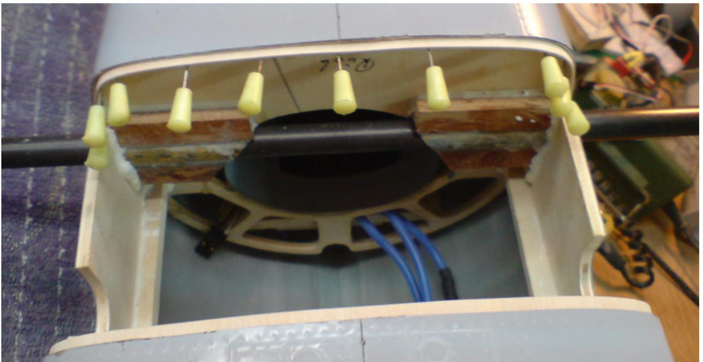
Die Spanten des Rumpfgerüsts wurden bis auf den letzten Spant alle mit Belzell-Kleber mit der Rumpfaußenhaut verklebt. Dadurch, dass bei der Herstellung der Rumpfhülle als letzte Lage Abreißgewebe verwendet wurde, braucht im gesamten Rumpf nichts mehr angeschliffen werden und die Verklebungen halten Bombenfest.
