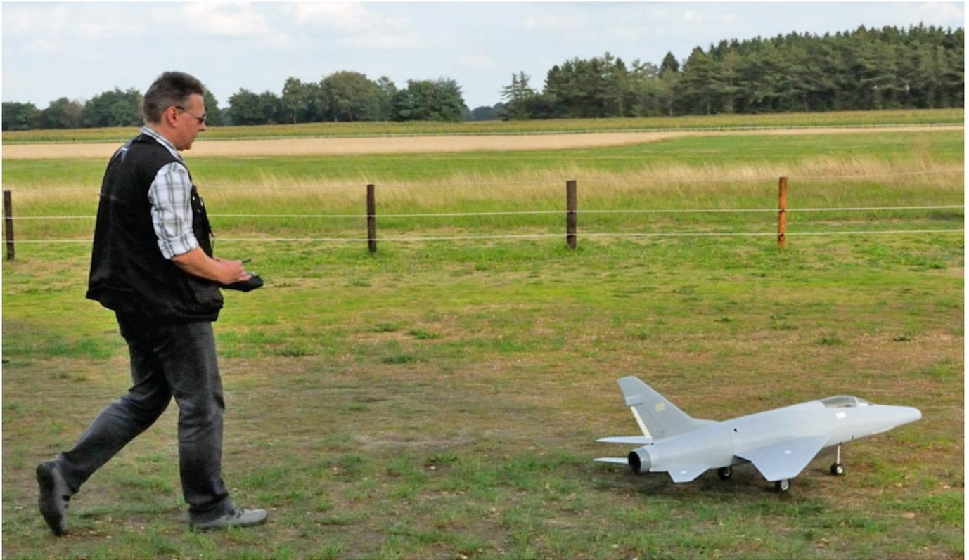
Nach dem alles so weit montiert und eingestellt war, konnte der Erstflug erfolgen, allerdings noch ohne Lackierung und trotz Gewichtseinsparung mit 200 g Blei in der Schnauze. Das Gewicht betrug mit dem 8-S-Antrieb und dem Ballast ziemlich genau 4,5 kg.
