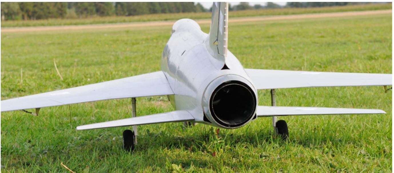
Als Antrieb wurde ja der WeMoTec Midi Fan Classic mit Mega 22/45/1,5 an 8 S eingesetzt. Der Antrieb bringt eingebaut im Modell ca. 3,4 kp Schub. Aus den praktischen Erfahrungen heraus kann man sagen, dass das Modell scalemäßig
