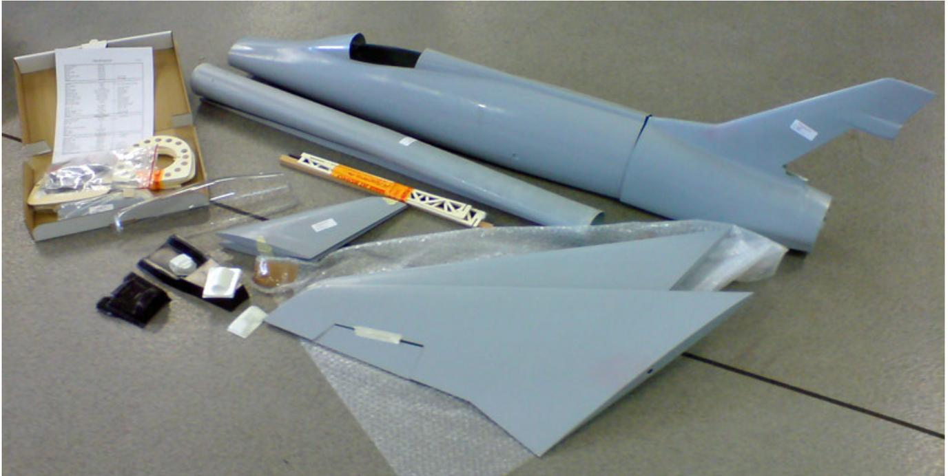
Bei dem Baukasten handelt es sich um die Umsetzung der F-100 D-Version (Einsitzer) im Maßstab 1:10. Er besteht aus dem zweiteiligen Rumpf, den Flächen und den Höhenleitwerken, einem Tiefziehteil für die Cockpit-Verglasung, einige Tiefziehteile für den Cockpit-Ausbau, einem Einlasskanal und diversen Spanten in Pappelsperholzbauweise, sowie einigen Kleinteilen.
