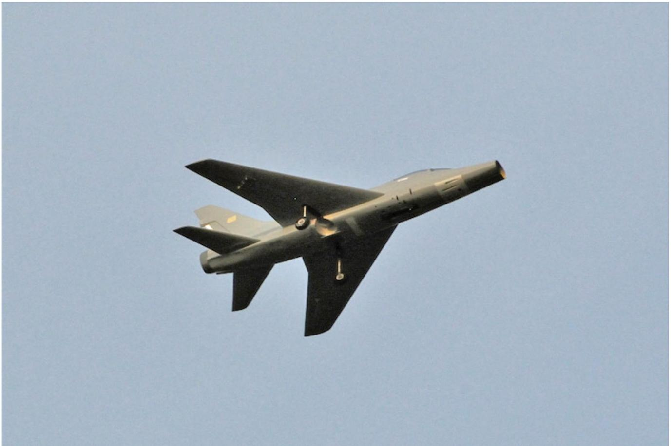
Beim Erstflug stellte ich dann vor der Landung fest, dass das Bugfahrwerk nicht ausgefahren werden konnte (s. Foto oben). Nach einem erneuten Versuch entschlossen wir uns ohne Fahrwerk zu landen. Trotz der fehlenden Landeklappen kann die F100 sehr langsam gemacht werden und mit hohem Anstellwinkel zu Landung hereingebracht werden. Dabei ist aber mit dem Gasknüppel immer die Sinkrate zu kontrollieren, da bei zu wenig Fahrt das Modell stark durchsackt.
