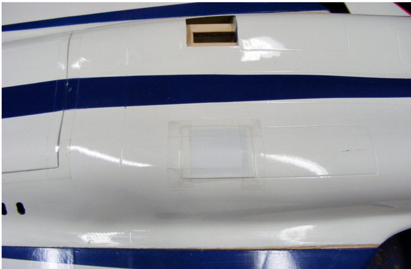
Als Antriebsakku kommt ein 4 S, 4000 mAh LiPo zum Einsatz. Nach dem ersten Auswiegen wurde noch eine Akkuhalterung aus Karbon-Wabenplatte hergestellt und mit dem Rumpf verklebt. Zum ordnungsgemäßen Fixieren des Akkus kam ein Klettbandverschluss zur Anwendung.
