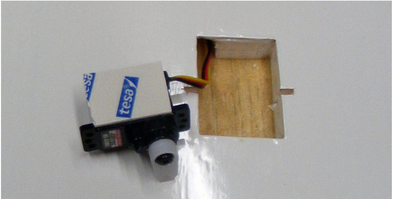
Als Abdeckung wurde eine handelsübliche Servoschacht-Abdeckung aus ABS verwendet. Um das Gewicht gering zu halten, wurde anstatt handelsüblichen 5-Minuten-Epoxy ein Zweikomponentenklebstoff aus der Industrie verwendet, der wesentlich leichter ist und bessere mechanische Eigenschaften besitzt. Dieser Kleber ist über fast jeden technischen Handel (z.B. Kfz-Teilehandel usw.) erhältlich.
