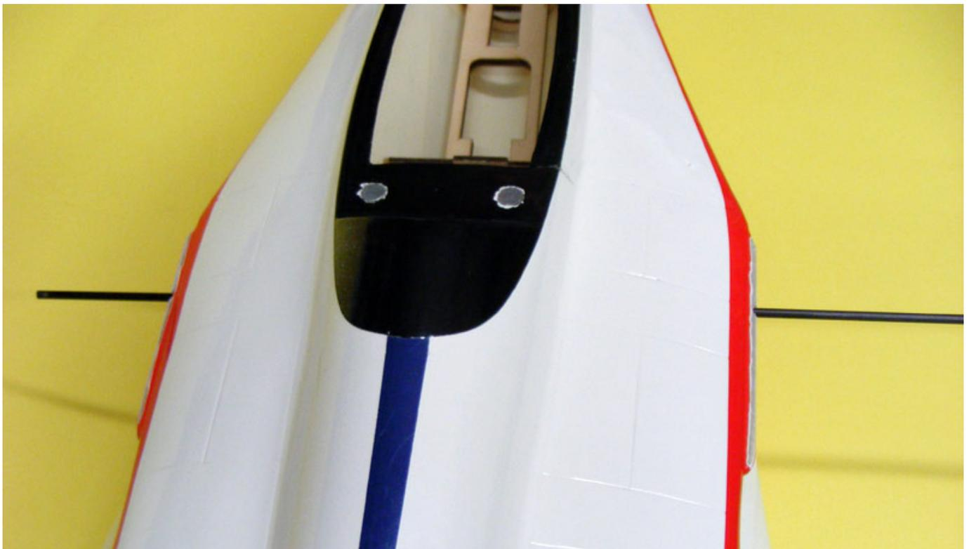
Damit der Kohlefaserstab später nicht dem Antriebsakku im Weg ist, wurden innen im Rumpf noch zwei Hilfsspannten aus Pappelsperrholz angefertigt, die den Kohlefaserstab abstützen.
