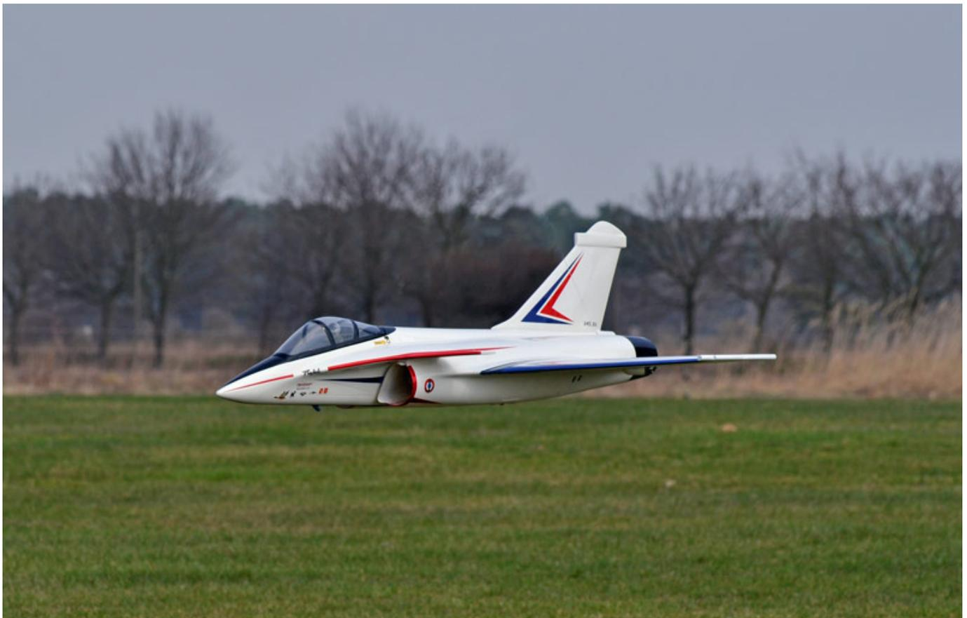
Der Schwerpunkt beträgt 55 bis 60 mm, die Ausschläge für Höhe in Neutralposition +6 mm und +/-5 mm Ausschläge für Höhe und Quer mit je 40 % Expo. Beim Start muss von Anfang an kräftig Höhe gezogen werden. Zur Landung kann die Rafale Delta-typisch mit Schlepptank und hoher Anstellung sehr langsam bis an den Platz herangeführt werden um anschließend butterweich auf den Rasen gelegt zu werden.
