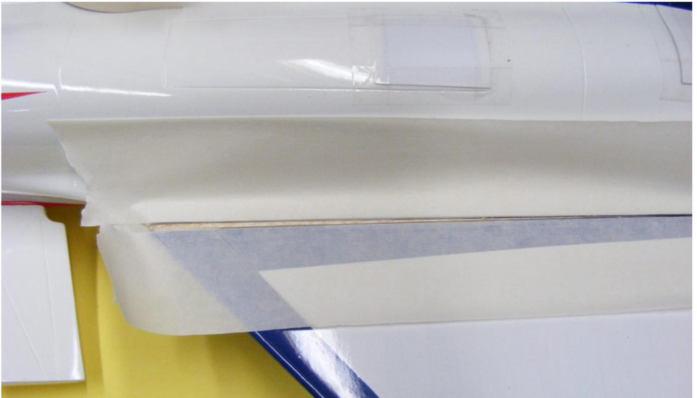
Der Spalt ist nun verschlossen und die Fläche kann ohne übermäßigen Kleberauftrag mit dem Rumpf verklebt werden. Dass dazu natürlich das Loch für das Servokabel und die Verdrehsicherungen der Fläche gebohrt werden müssen, versteht sich von selbst. Nach dem Ausrichten und Verkleben wurde der Balsaholzkeil noch etwas mit blauer Farbe behandelt und ist bis auf kurze Entfernung nicht mehr zu sehen.
