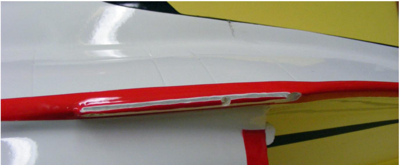
Nachdem alles ausgehärtet ist, kann der Kohlefaserstab in der Mitte zwischen den beiden Spannten herausgetrennt werden und ist damit den weiteren Einbauten nicht mehr im Wege.
