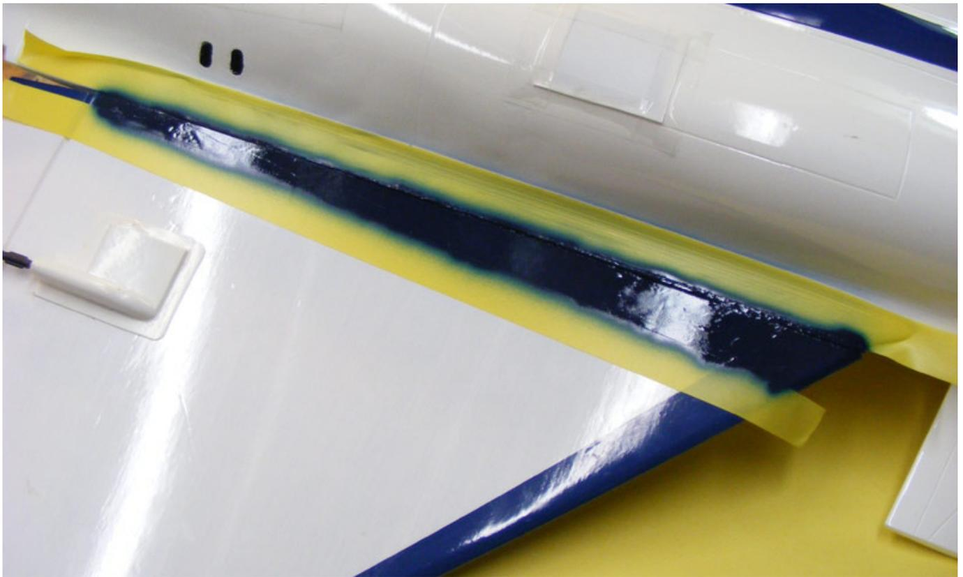
Die Montage des Seitenleitwerkes erforderte noch einmal etwas Arbeitsaufwand. Die Leitwerksflosse passte nicht exakt in die dafür vorgesehene Aussparung im Rumpf, so dann diese mit einem Handschleifer und einem Fräser etwas nachgearbeitet werden mussten. Nach erfolgter Verklebung mit eingedickten 24-Stunden-Epoxydharz war der Rohbau nun fast abgeschlossen.
