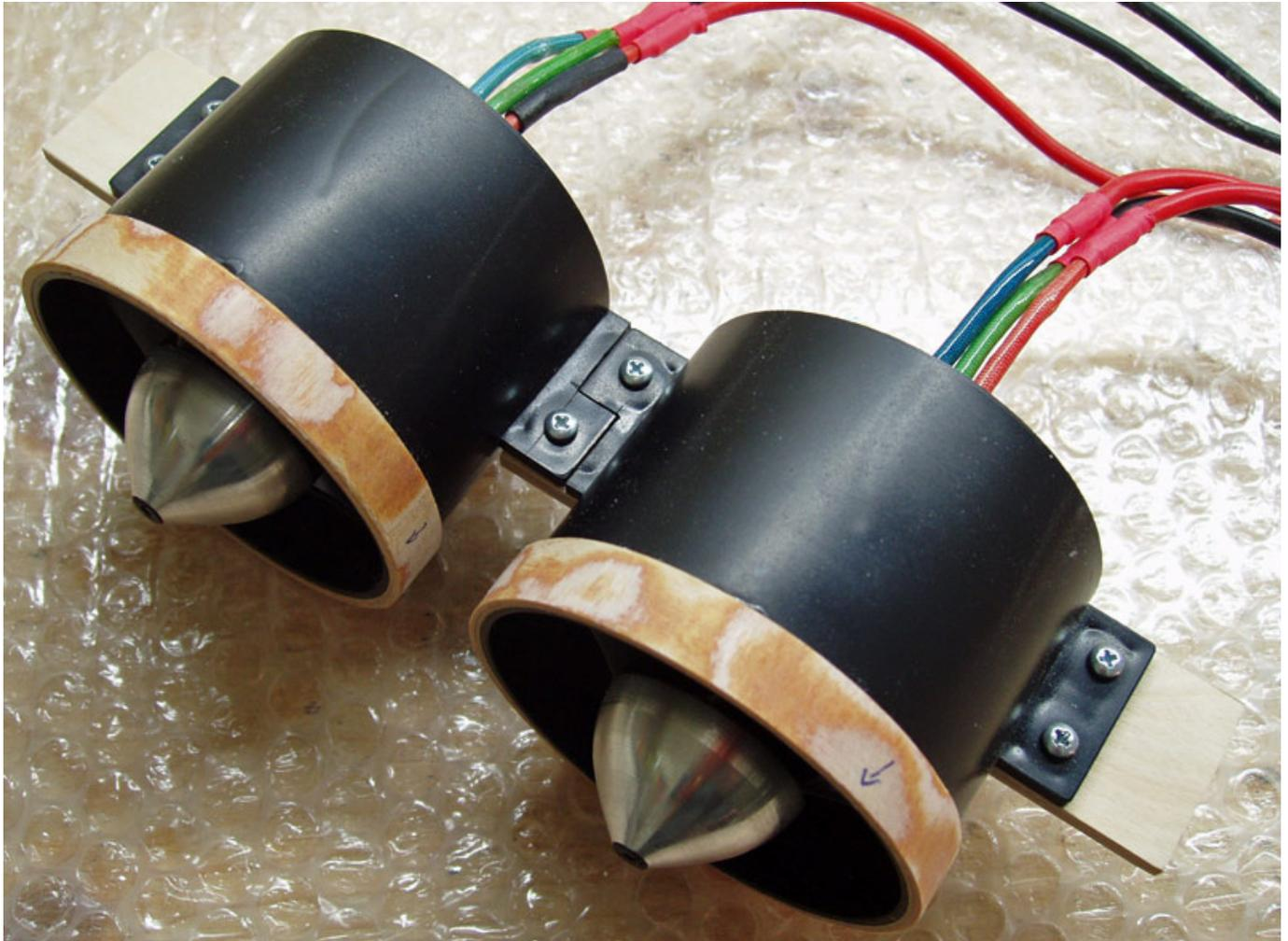
Als Schubrohre wurden die käuflich zu erwerbenden Schubrohre von Wemotec verwendet, die saugend auf den Impellermantel gesteckt werden können. Es kann aber auch herkömmliche Plastikfolie verwendet werden, welche allerdings schwieriger im Rumpf auf den Impeller zu befestigen ist.
