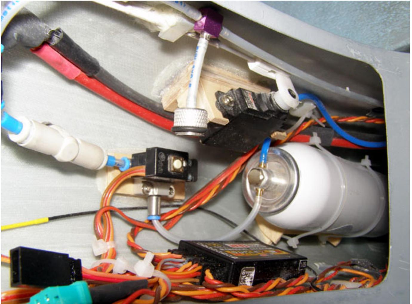
Die Akkuhalterung wurde so gestaltet das man Akkus unterschiedlicher Gewichtsklassen verwenden kann. Der vordere Anschlag ist so gebaut das man den Akku verschieben kann. Im hinteren Bereich des Akkus kann man dann nach Belieben ein Distanzstück als Anschlag mit Klettverschluss befestigen. Der Akku für die Parallelstromversorgung wird unter dem vorderen Anschlag fixiert.
