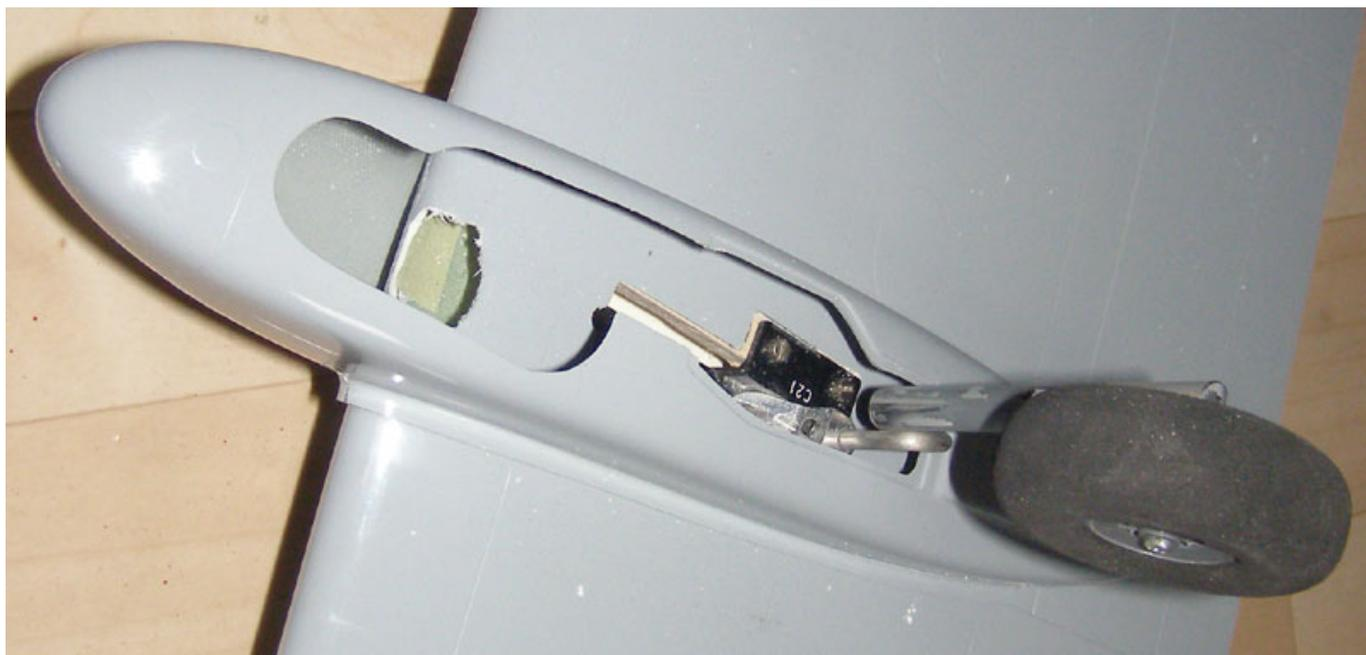
Das Bugfahrwerk wurde bei HOBBYFLY ([www.hobbyfly.de](http://www.hobbyfly.de)) bezogen. Es wurde im Bereich der Radaufnahme verkürzt (s. Foto unten), da das Bugrad der A-10 kleiner ist.
