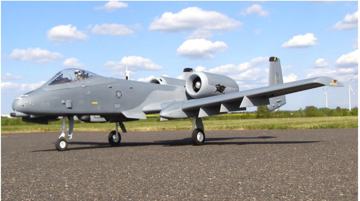
Der Hersteller Jetarrows aus Tschechien bietet eine A-10 im Maßstab 1:13 in GFK-Bauweise, die auch für ein Einziehfahrwerk vorbereitet ist. Entwickelt wurde das Modell von Ivan Langer, einem ehemaligen Mitarbeiter von Graupner und Aero-naut. Michael Kühl baute das Modell Anfang 2011 auf und berichtete uns über den Bau und die Flugeigenschaften der A-10.
