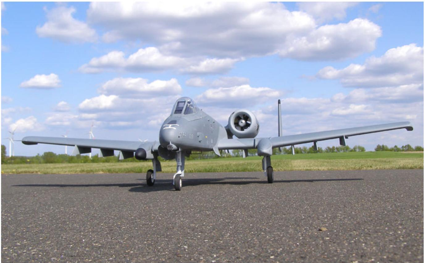
Das komplette Modell wurde mit einem Schleifvlies aus dem KFZ- Bereich geschliffen und mit Wasser und Geschirrspülmittel entfettet. Danach wurde Lackiert. Zuerst wurde alles hellgrau Lackiert. Dann wurden Schablonen für das dem entsprechende Lackierschema geschnitten und Grau überlackiert. Der Scheibenbereich des Cockpits wurde noch vor dem Lackieren mit schmalen dichten Klebeband am Rand und Malerkrepp abgeklebt. Die Farben wurden mit Revell Farbverdünnung verdünnt.
