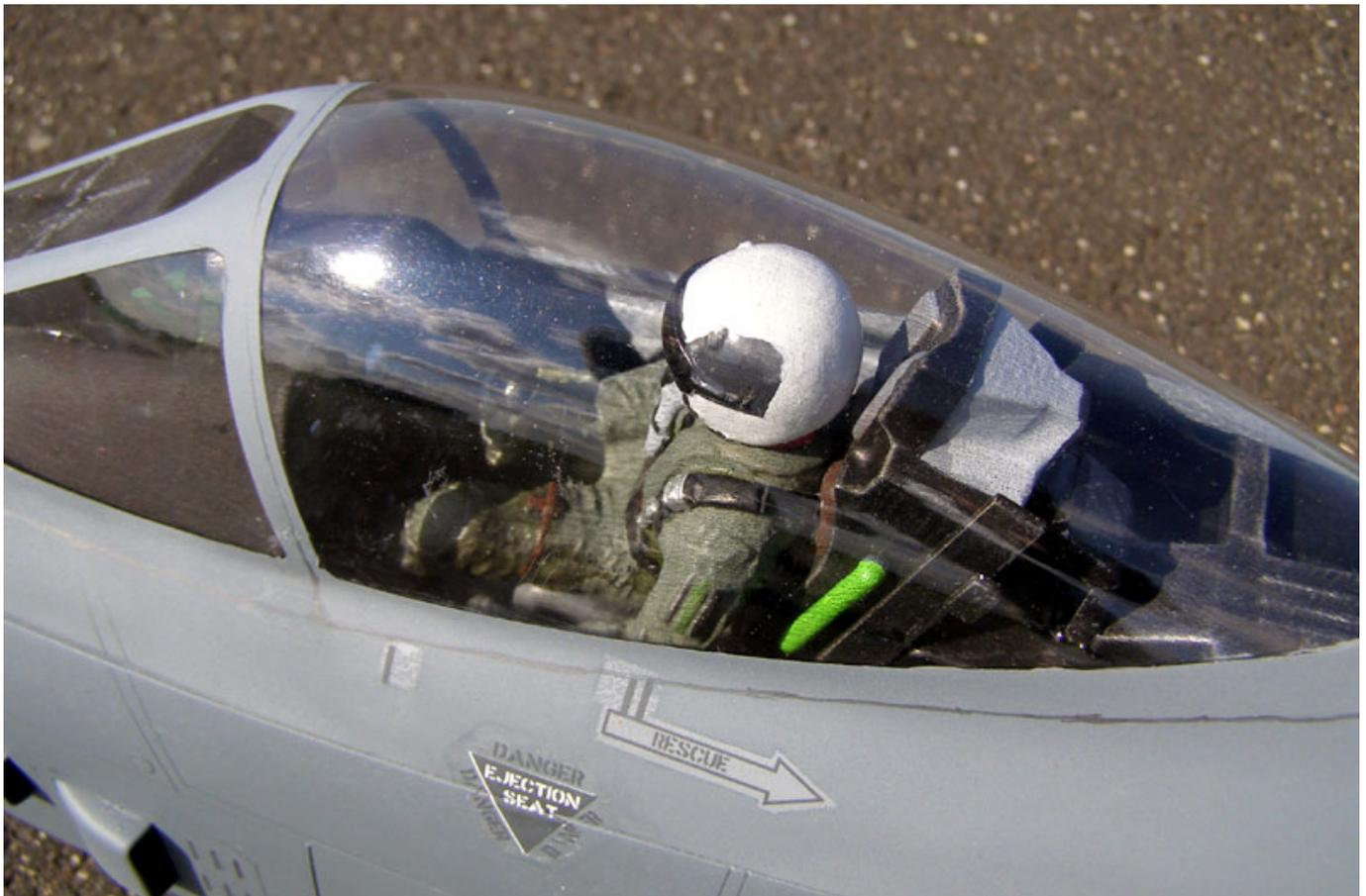
Das Lackieren funktionierte mit den Revellfarben einwandfrei. Danach wurde noch mal leicht geschliffen und entfettet. Als alle Bezeichnungen angebracht waren wurde mit mattem Klarlack überlackiert. Dabei löste sich anfänglich das Dekor an. Nach dem Trocknen der Farbe zog sich das Dekor jedoch wieder schön glatt. Die Fahrwerke und Räder wurden mit weißer Farbe lackiert.
