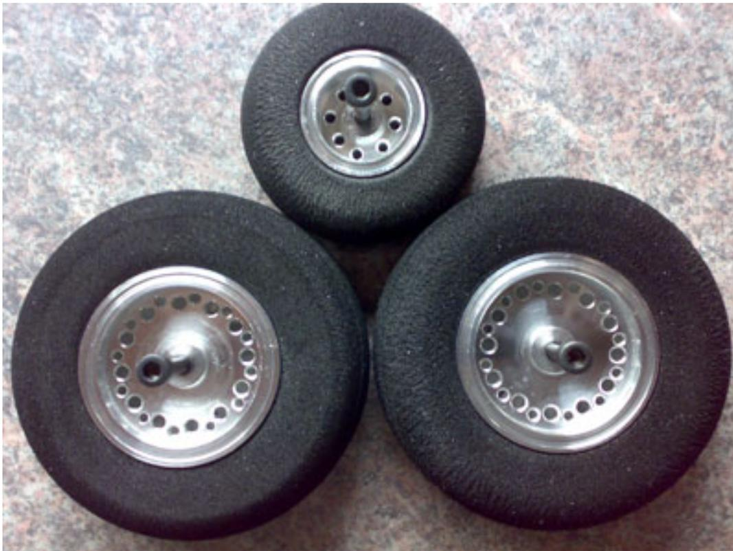
Michael entschloss sich alle Aufnahmen mit 3-mm-Flugzeugsperrholz zu verstärken. Der Einbau des C 21 Fahrwerks machte bei den Hauptfahrwerken nur geringe Änderungen notwendig. Die Anlenkung und Funktion des Bugfahrwerks war hingegen etwas schwieriger umzusetzen.
