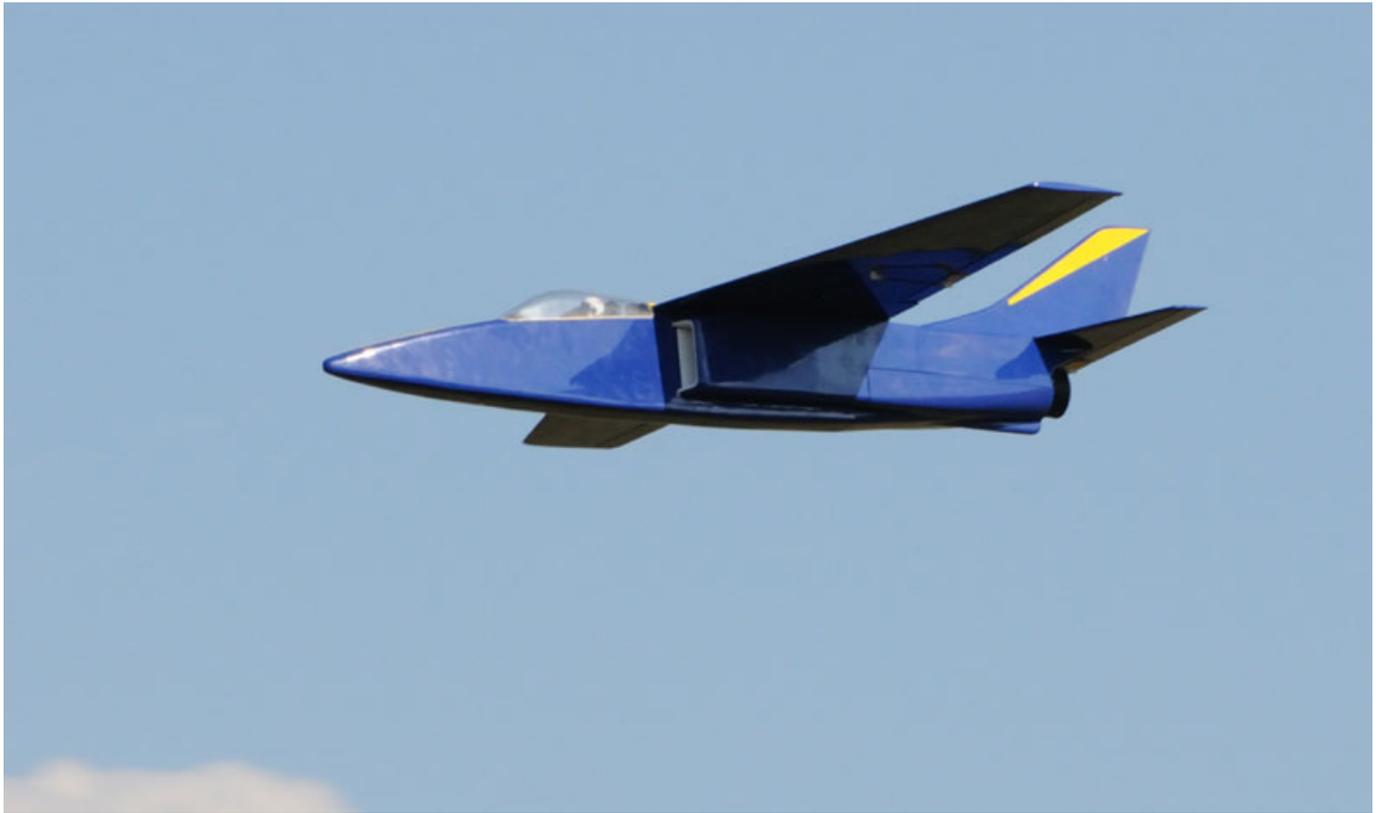
Nach dem Betätigen des Auslösers gibt man dann nach ca. einer Sekunde Vollgas und schaltet nach zwei weiteren Sekunden dann auf die normale Flugphase ohne Höhenrudertrimmung um. Bei unserem Erstflug war erstaunlich, dass überhaupt keine Trimmung nötig war, weder auf Quer- noch auf Höhenruder.
