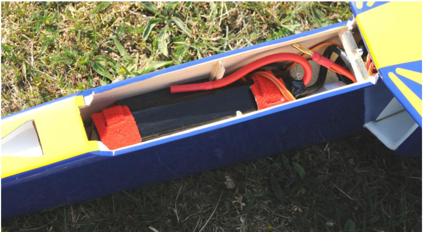
Das Gewicht des Rumpfes mit Kabinenhaube beträgt 760 g. Der Flügel des EIT 2 wiegt 326 g und ist damit 35 g leichter als des Vorgängers. Durch die veränderten Dimensionen wirkt das Modell mehr Jet-like. Die Form wird aber natürlich auch von baulichen Belangen mit bestimmt.
