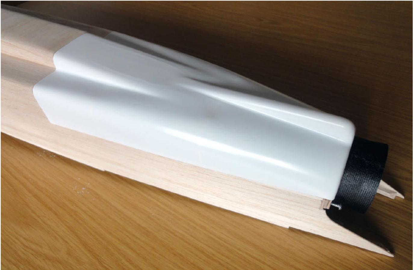
Bei der Modellhandhabung ist durch einen kleiner Stoß gegen das Seitenleitwerk dieses "sauber" abgebrochen. Auf Grund der Befestigung und des Materials kann dies leider sehr schnell passieren. Wir empfehlen daher die Befestigung des Seitenleitwerks zu verstärken und dies auch schon prophylaktisch auszuführen.
