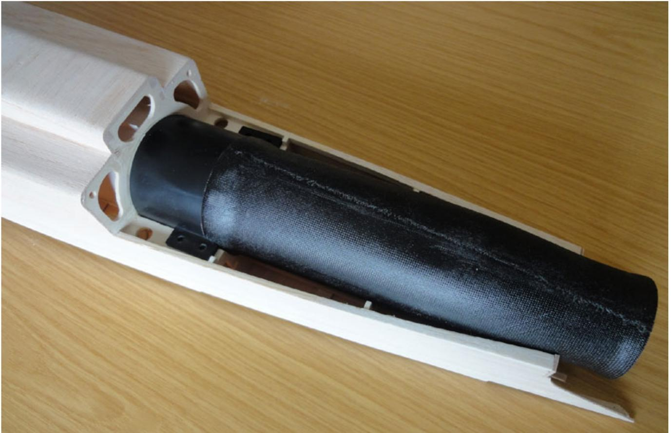
Eine Impellerabdeckung garantiert schnellen Zugang zur Antriebseinheit. Diese wurde für den EIT 2 neu konstruiert. Sie besteht nun aus einem mit Spanten verstärkten Tiefziehteil.
