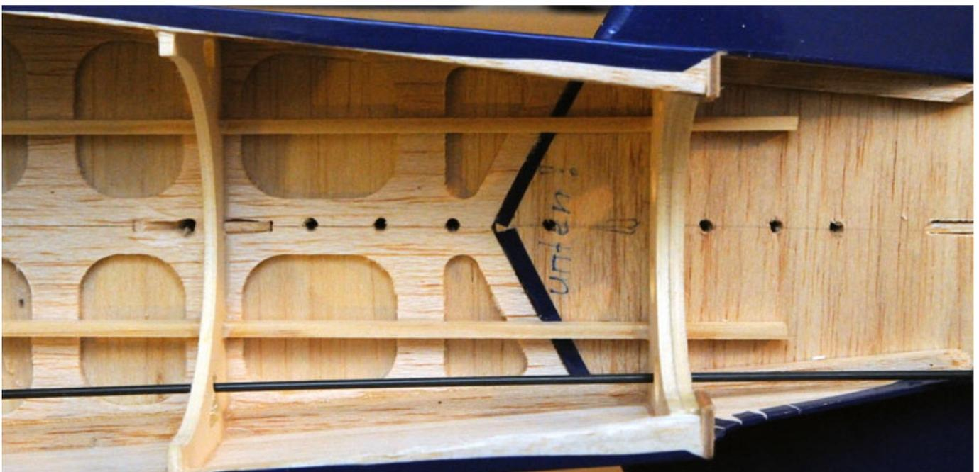
Ist das Seitenleitwerk abgebrochen, so klebt man es vor Ausführung der Verstärkungsmaßnahmen stumpf auf und fixiert es es mit einigen Nadeln. Das Modell wird mit Seitenleitwerk nach unten auf einen Modellständer aufgelegt. Impellerabdeckung und Schubrohr werden nun entfernt. Es werden dann ca. sechs bis acht (je nach dem ob das Seitenleitwerk schon abgebrochen ist oder nicht) 3 mm Löcher mit einem Handbohrer senkrecht in den Rumpf gebohrt, so das die Bohrungen in das Seitenleitwerk hineinragen.
