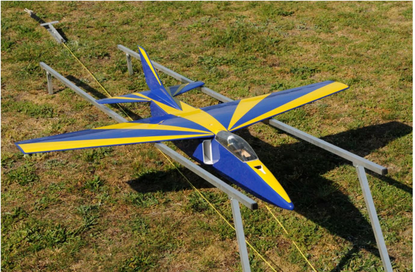
Ein EMC Megarubber Allround (ca. 10 mm Durchmesser) mit 7,4 m Länge, muss man zum Starten lediglich auf die doppelte Länge ausziehen. Zum Start sollte man eine Flugphase mit ca. 2 mm Höhenruder programmieren. Die Neutralstellung des Höhenruders ist dann erreicht, wenn Höhenleitwerk und Ruder unten eine Flucht bilden. Am besten einmal ein Lineal zum Einstellen anhalten.
