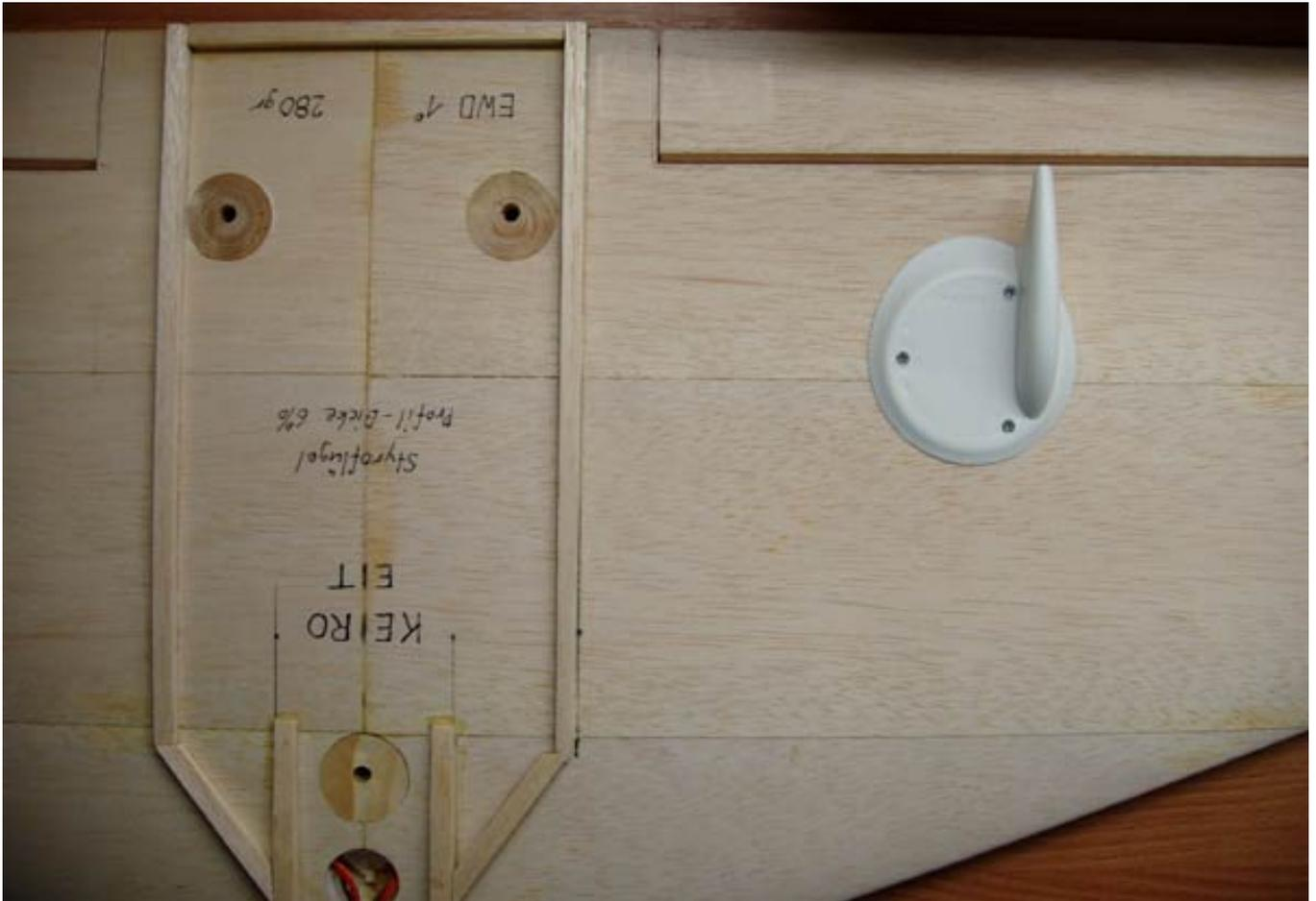
Hier einmal ein Blick auf den noch nicht mit Bügelfolie bezogenen Flügel. Die Servoaufnahme ist (siehe Foto) so Bestandteil des EIT-Baukastens.
