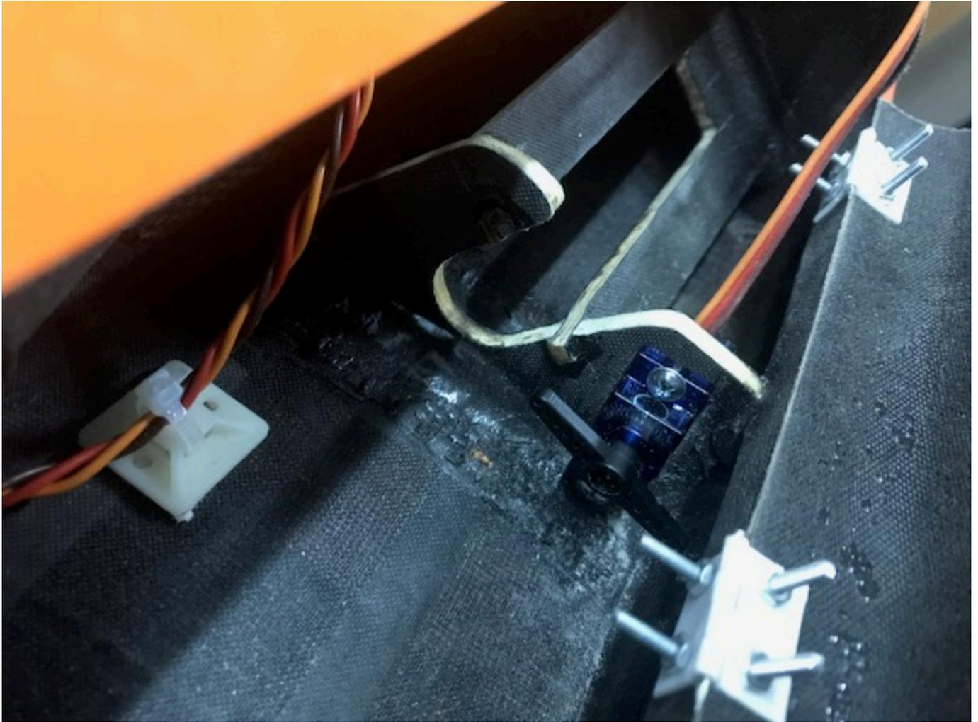
Angesteuert mit kleinen Servos, ist das Klappenthema schnell durch. Nach Kürzen der Schrauben und Sichern der Muttern geht's mit dem nächsten Schritt weiter.
