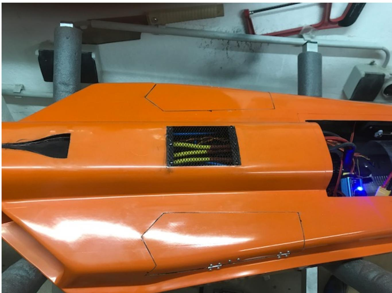
Da der Regler an Ort und Stelle war konnte der Fan eingebaut werden und die Kabel passend abgelängt werden. Ebenso die Servos für die Tailerons. Dazu wurden schon passende Brettchen vom Hersteller eingeklebt.
