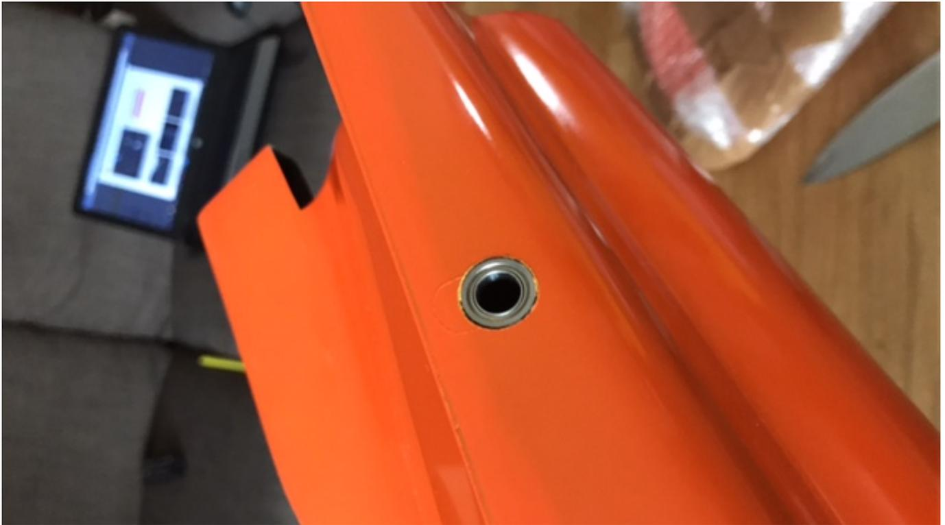
Nachdem die Arbeiten Erledigt sind wurde das Behotec C21 Fahwerk eingeschraubt. Die Spanten dazu sind schon fertig im Rumpf verklebt, so dass dies schnell von der Hand geht. Mit dem Anlenken des Bugrades und der Tailerons sind die Ruderanlenkungen schon fertig. Nachdem die schweren Hauptkomponeten ihren Platz hatten, konnte der Schwerpunkt getestet werden.
