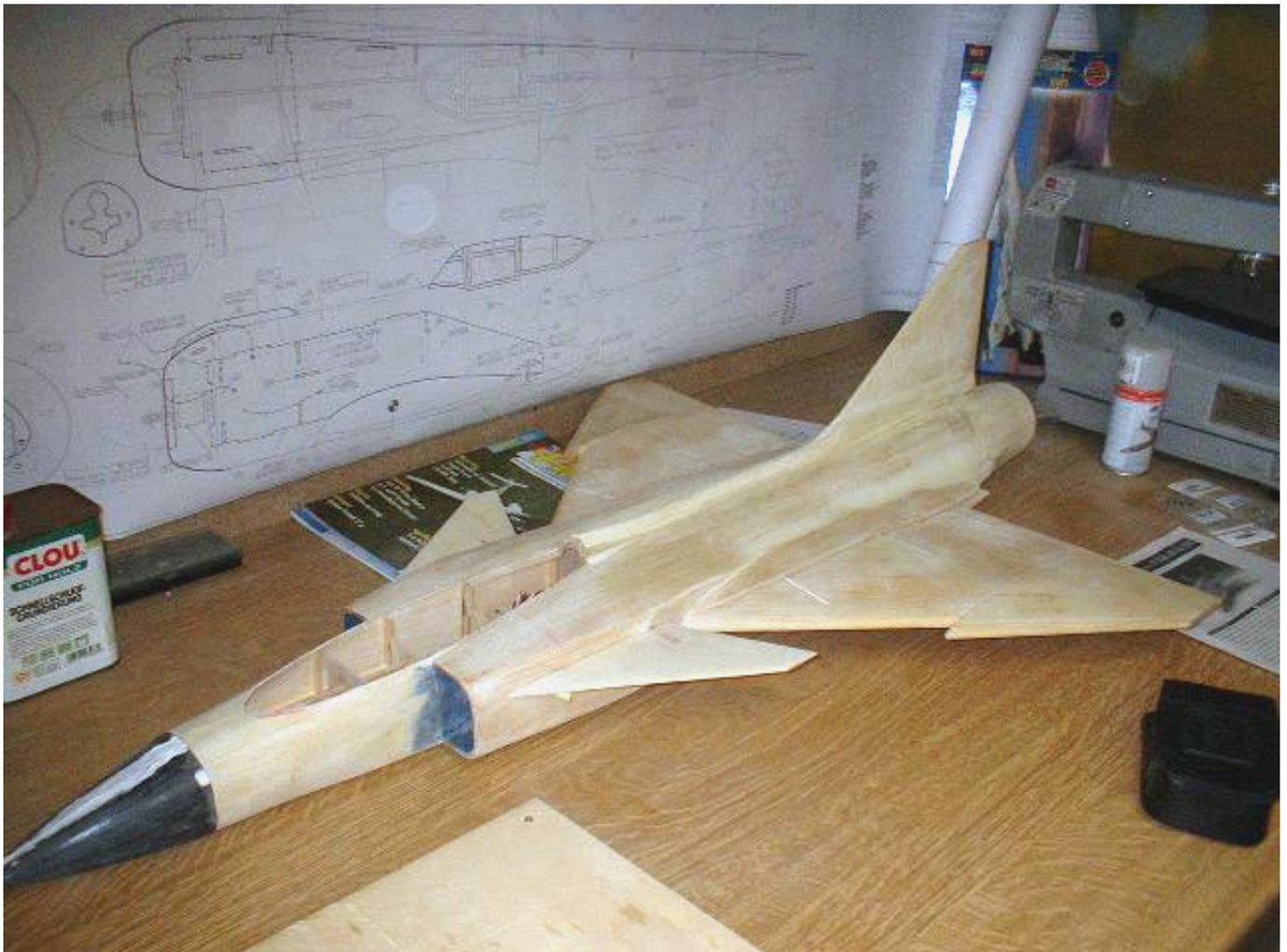
Hier der fertige, mit 49 g Glasfaser laminierte Rohbau. Die Canards sollen laut Hersteller eine EWD von 0 Grad haben, was auch so passt.
