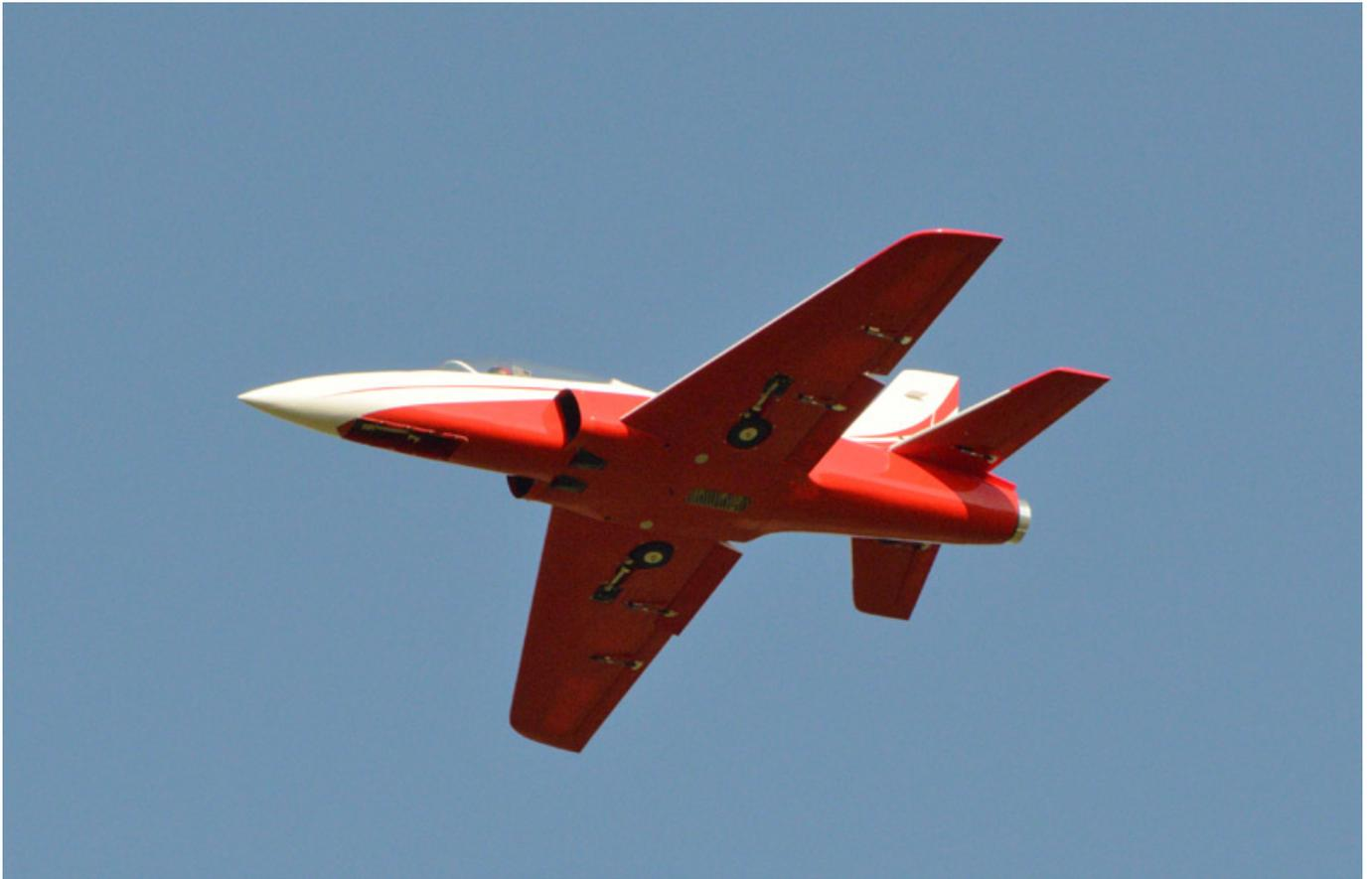
Bei der Landung kann man nach der Landekurve schon das Gas komplett rausnehmen und volle Klappen setzen, leicht anstellen und ausschweben lassen. Die Segeleigenschaften des Modells sind sehr gut. Selbst bei dem schwereren Modell waren sie noch ausgezeichnet. Bei geringem oder gar keinem Wind sollte man die Klappenstellung noch etwas größer machen als der Hersteller sie in der Anleitung angibt.
