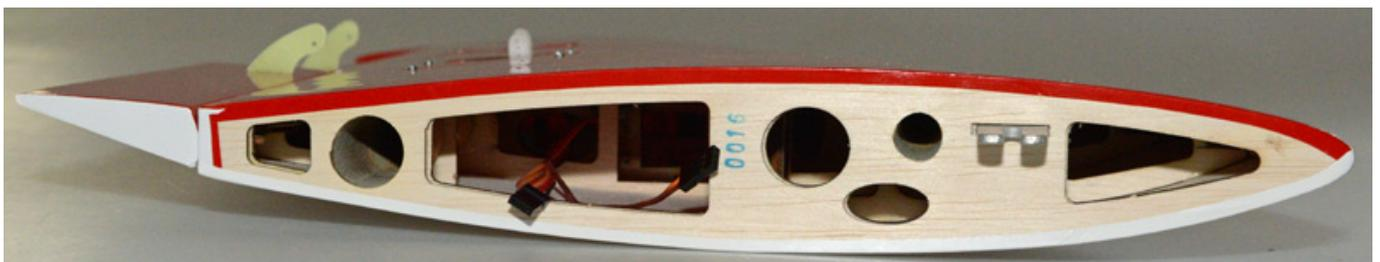
Nun kann man sich an die Montage des Hauptfahrwerks machen. Hierzu muss man die Folie mit einem scharfem Skalpell entsprechend entfernen (s. Abb. unten).
