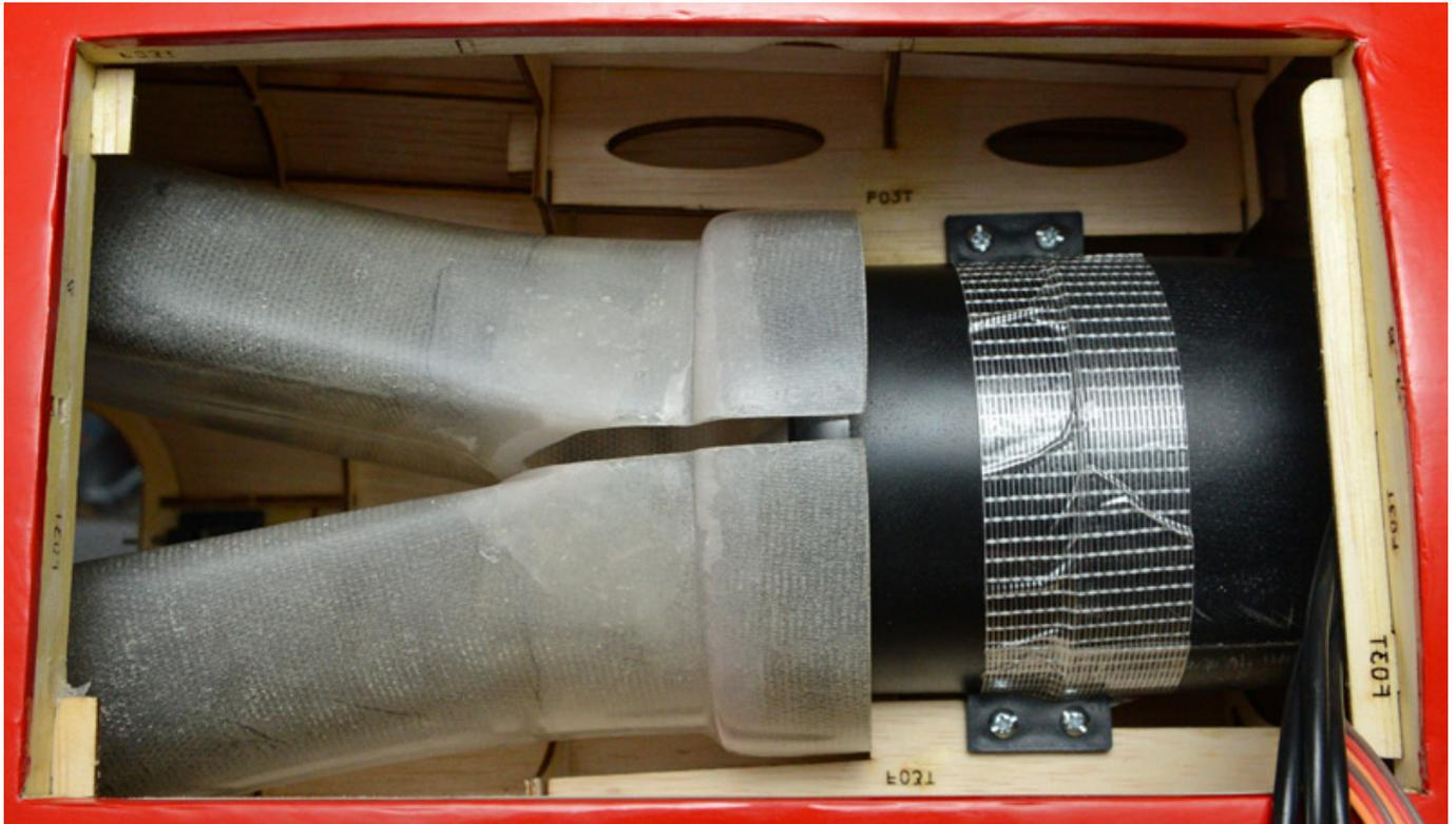
Es liegt noch ein Holzrahmen bei, der an dem vorgesehenen Punkt aber nicht befestigt werden kann, da dort das Flächensteckrohr verläuft. Der Ring soll eigentlich das Hosenrohr zusammenpressen. Wir haben ihn wie auf dem Foto zu sehen (s. Foto unten) montiert. Hier hat er keine tragende Funktion sondern dient dazu die diversen Kabel zu führen.
