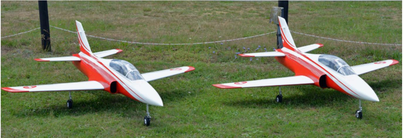
Das Gewicht lag durch Verzicht auf eine extra Empfängerstromversorgung - Dank Einsatz des Jeti 120 lite mit BEC und des 8-Zellen-Antriebs - sogar noch unter der Herstellerangabe (4,8 bis 5,2 kg) und zwar bei 4,55 kg. Es wurde parallel noch ein zweites Modell mit 9 S Antrieb aufgebaut, das aber eine Empfängerstromversorgung aufwies und mit fast 5,7 kg deutlich schwerer war.
