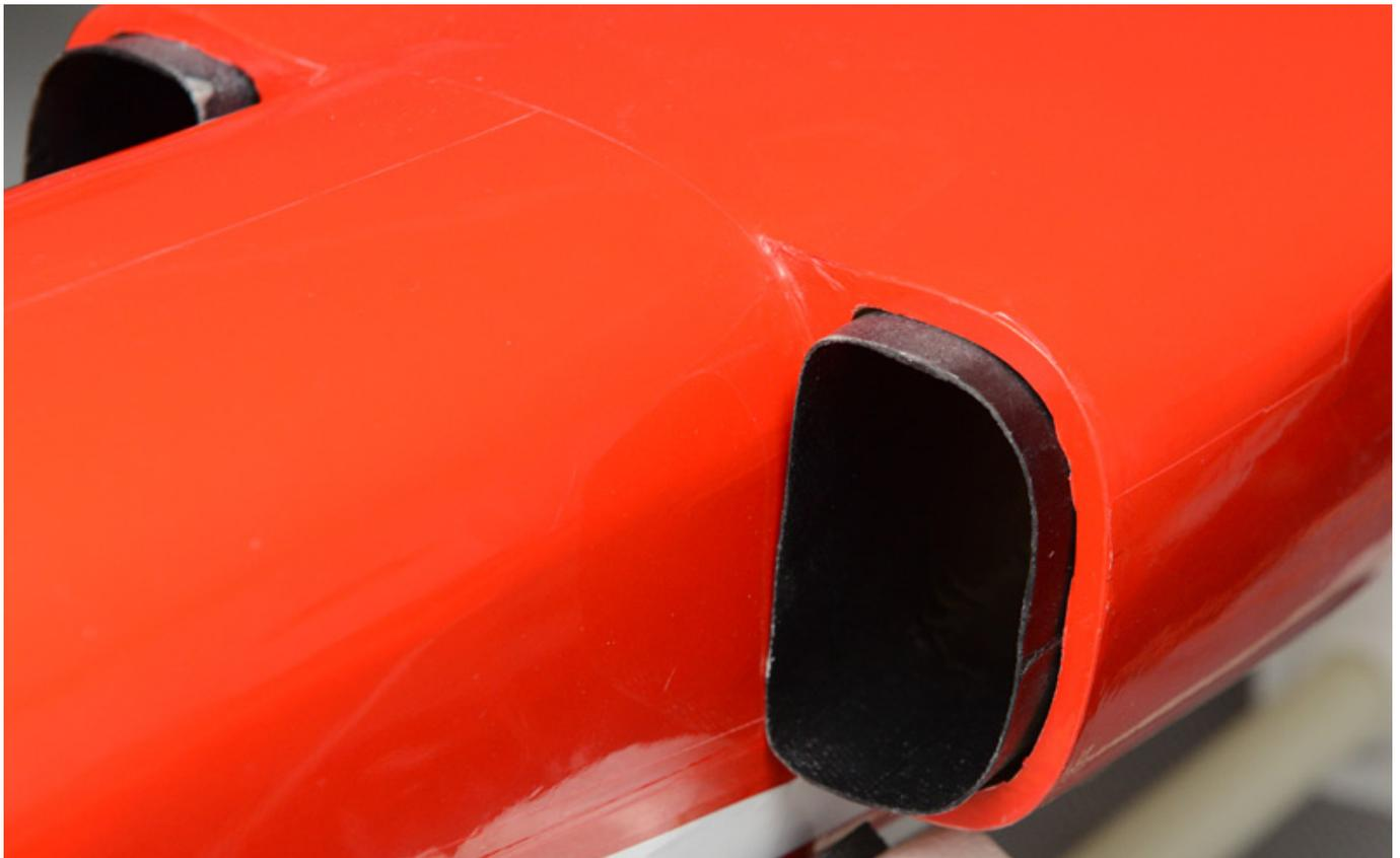
Nun muss man die Tiefziehteile entsprechend zuschneiden und auf die Düseninläufe schieben und befestigen (s. Abb. unten). Weiter sind zwei Dreiecke freizuschneiden und dort zwei weitere Tiefziehteile aufzukleben. Man sollte bei letzteren unbedingt mittelflüssigen Sekundenkleber mit Aktivator einsetzen damit es auch hält. Die Düseninläufe sollte man nur an zwei Punkten mit einem Tropfen Sekundenkleber fixieren und dann mit Tesafilm die Teile am Rumpf fixieren.
