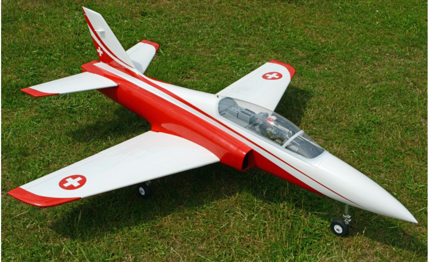
Der Sport-Jet Phoenix Preceptor in Holzbauweise mit Bügelfolienbespannung, der seit der ersten Jahreshälfte 2015 erhältlich ist, wurde für 90-mm-Impeller konstruiert und hat eine Flügelspannweite von 1,4 Meter, also schon ein stattliches Modell.
