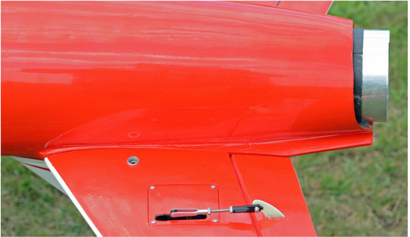
Zum Abschluss nun eine Servoverlängerung am Seitenruder anbringen, in den Rumpf durchfädeln und dann das Seitenleitwerk festkleben. Am Seitenleitwerk sind noch zwei Stabilizer anzubringen. Hier muss man die Folie entfernen und diese dann mit Sekundenkleber festkleben. Eventuelle Lücken lassen sich mit ein paar Tropfen UHU holzfest Wackel-Stop oder Holz-Weißleim verschließen.
