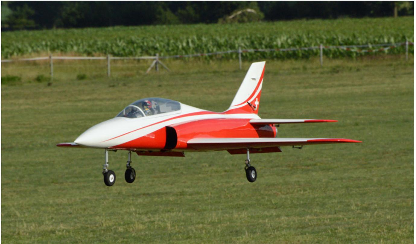
Wir haben auch noch zwei Videos von dem zweiten, schwereren Modell (5,7 kg) mit dem 9 S-Antrieb (5.800 mAh LiPo-Akkus) mit JETFAN-90 Impeller und HET 650-58-1760 Motor gedreht, um die Flugeigenschaften mit dem geänderten Schwerpunkt zu dokumentieren. Das zweite Video ist mit 128 mm, das erste mit ca. 132 mm Schwerpunkt entstanden.
