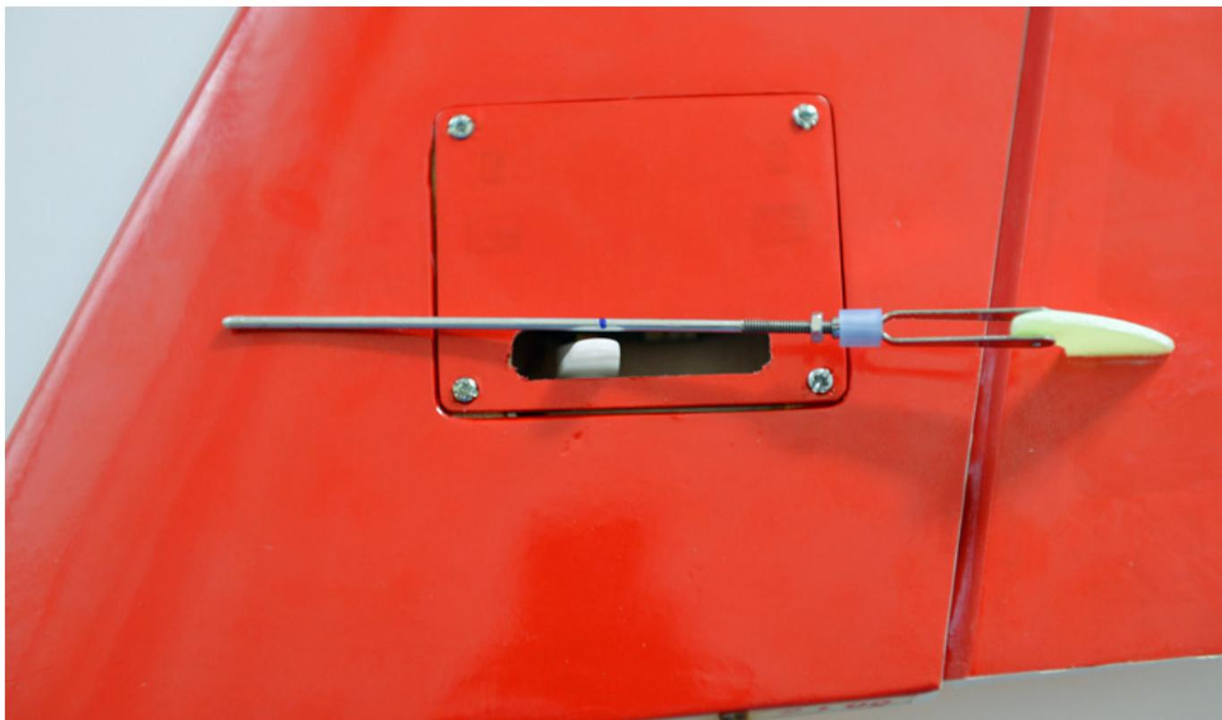
Dann wird das Loch des Servohebel auf 1,8 mm (nicht wie in der Anleitung beschrieben auf 2 mm) aufgebohrt, die Stange vorsichtig um 90 Grad gebogen (im nicht montiertem Zustand biegen!) und durch das Loch des Servoruderhorn gesteckt und dann mit einem Saitenschneider gekürzt.
