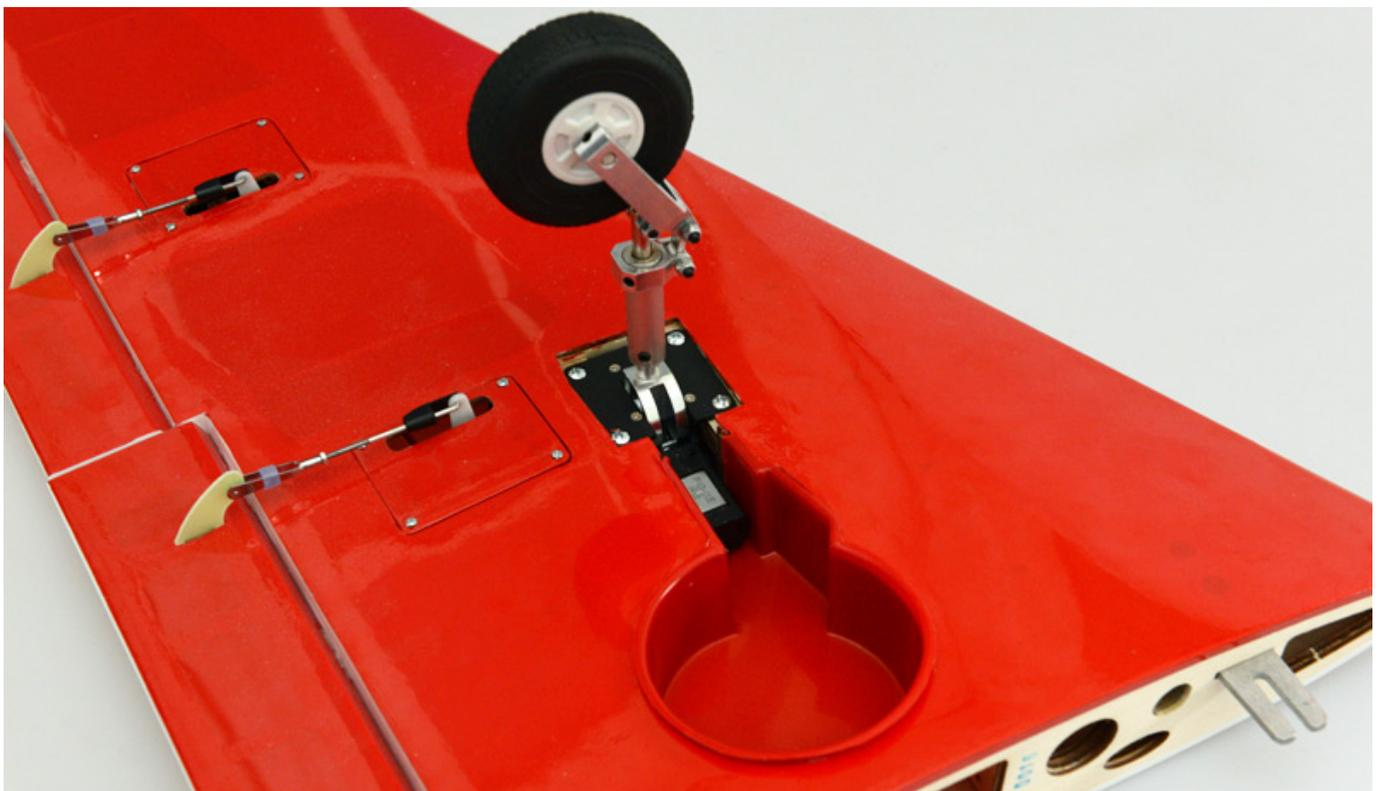
Nun wäre das Tiefziehteil für das Hauptfahrwerk entsprechend mit einer kleinen Schere zu trimmen (nur kleinen Rand stehen lassen und auf der Fahrwerksseite öffnen). Da eines unser Tiefziehteile aber stark beschädigt war haben wir die
