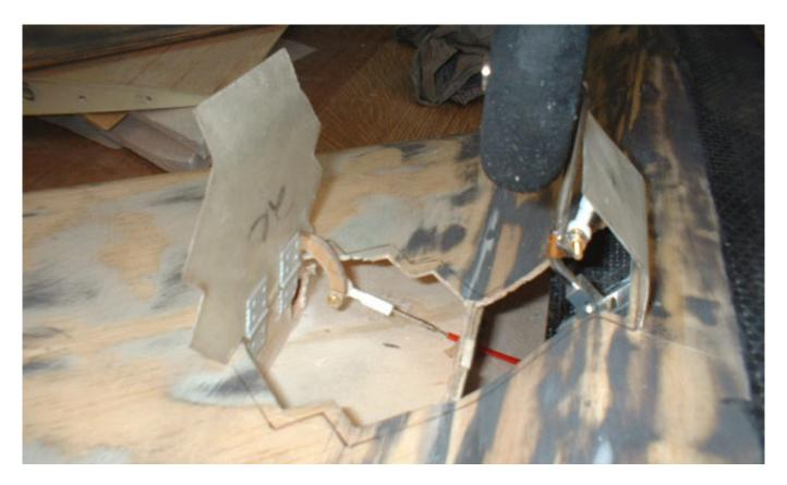
Als Stahldraht wurde ein drei Millimeter draht verwendet. Bei dem Fahrwerk lagen 1/10"-Drähte bei, die aber für zu dünn befunden wurden. Das Fahrwerk ist original auch nur für Modelle bis ca. 1,8 kg vorgesehen, tut aber hervorragend seinen Dienst mit dem dickeren Stahldraht.
