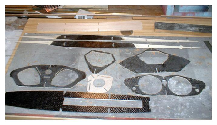
Da die Kraftüberleitung in Zelle wegen dem Einziehfahrwerk gleichmäßig erfolgen muss, hat Ulf die original Balsspanten zum Teil mit Kohlefaser verpresst.
