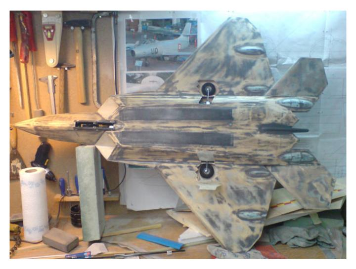
Anzumerken ist noch, dass der Cockpitausbau nicht so von RBC geliefert wird, sondern in Eigenregie entstanden ist. Hier wurde Styrodur, Balsareste und PET-Flaschen verwendet. Das Head-Up-Display stammt z. B. von einer grünen PET-Falsche. Die Decals stammen übrigens von Tailor Made Decals (Ralf Schneider).
