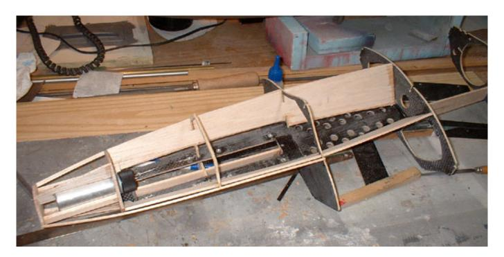
Auch die Seitenteile an dem das Hauptfahrwerk befestigt wird wurden verstärkt hergestellt. Hier wurde ein Sandwicht bestehend aus zwei Balsa-Brettern und innen und außen Kohlefaser angewandt (siehe Bild unten).
