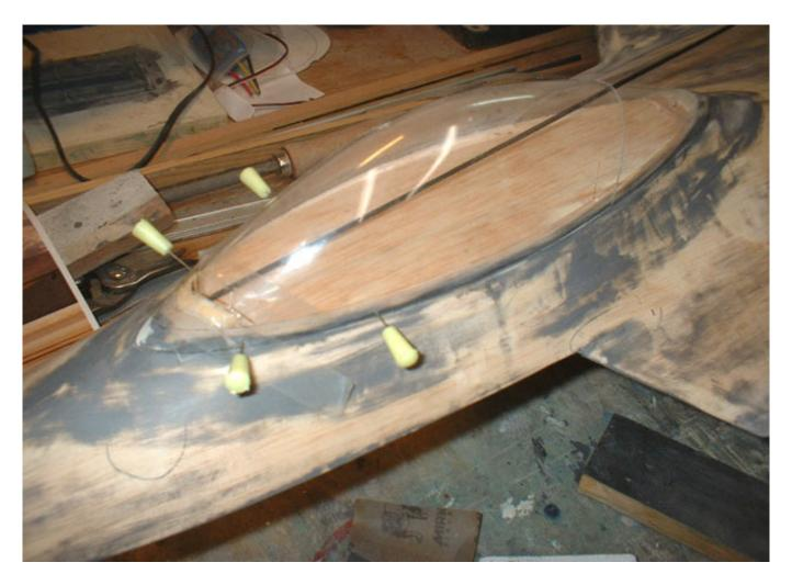
Das Modell wurde mit 49er Glasgewebe beglast, verspachtelt und verschliffen. Weiter wurden noch die Gestängeabdeckungen wie beim Original angebracht und zwar aus Styrodur mit zwei Lagen Glasgewebe.
