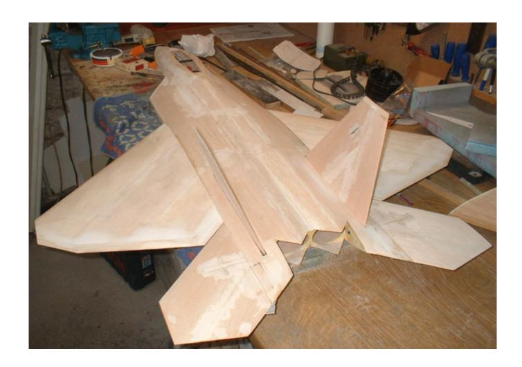
Kabinenhaube ist hinten geteilt, damit sie mit einem Servos hochgestellt werden kann. Zum Akkuwechsel lässt sich die Haube aber komplett abnehmen. Die Befestigung erfolgt über Magnete.
