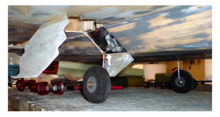
Die komplette Bugfahrwerksmechanik (siehe Foto unten) ist in eine Platte aus Balsa/Kohle-Sandwichmaterial eingebaut, inkl. Servo für die Bugklappen (siehe Kugelköpfe) und Lenkservo. Durch diesen Aufbau ist auch der Service relativ einfach.
