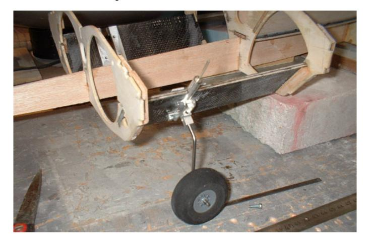
Hier einen Einblick in den unfertigen Rohbau (unten). Der Aufbau bis zur Beplankung ist nicht sehr stabil. Am besten man nutzt eine untergelegte Platte und versieht diese mit Hilfslinien um so zu kontrolliert, ob sich der Aufbau im Laufe der Bearbeitung verzieht.
