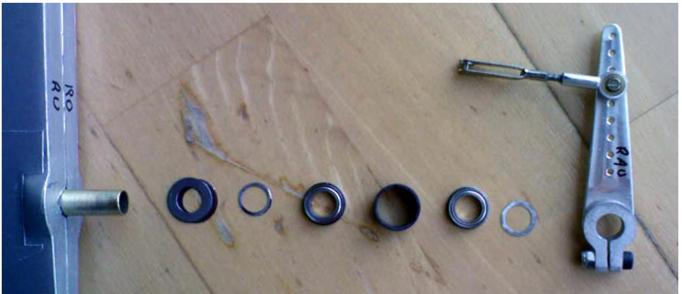
Zum Vermessen wurde ein Alurohr durch die Lagerstellen geschoben.
