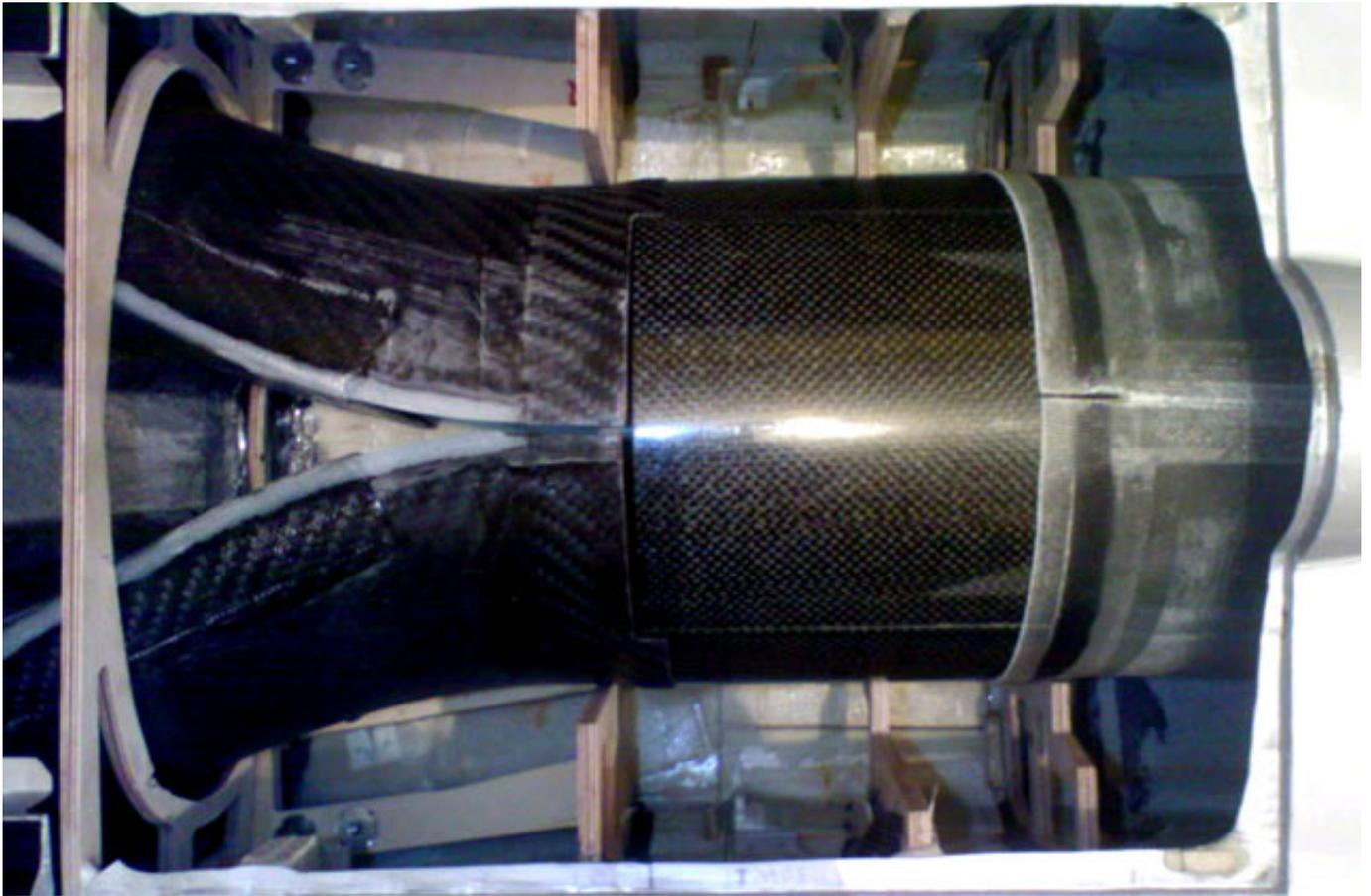
Die Lagerung für das Pendelleitwerk besteht lediglich aus GFK und Steffen entschloss sich hier zu einer Modifikation auf eine kugelgelagerten Variante.
