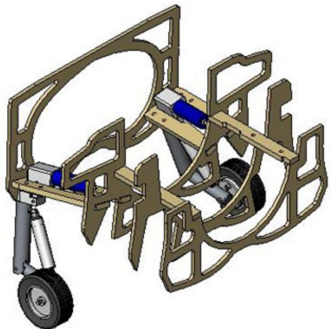
Steffen hat dann für den Fahrwerkseinbau ein Spanntensatz im CAD entworfen.
