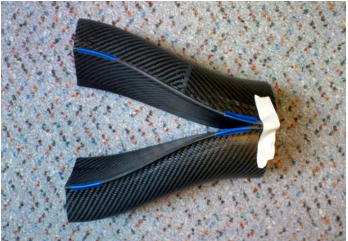
Und hier im vormontierten Zustand mit dem TurboFan 4000. Düse und Einlauf sind noch auf den Impelleraußendurchmesser anzupassen.
