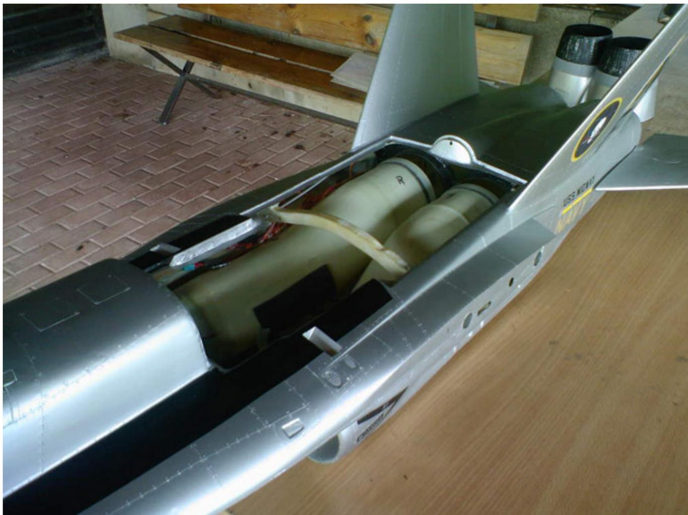
Die Einläufe und Spannten wurden dann entfernt, so dass der Rumpf bis auf die Flügelsteckung leer war.
