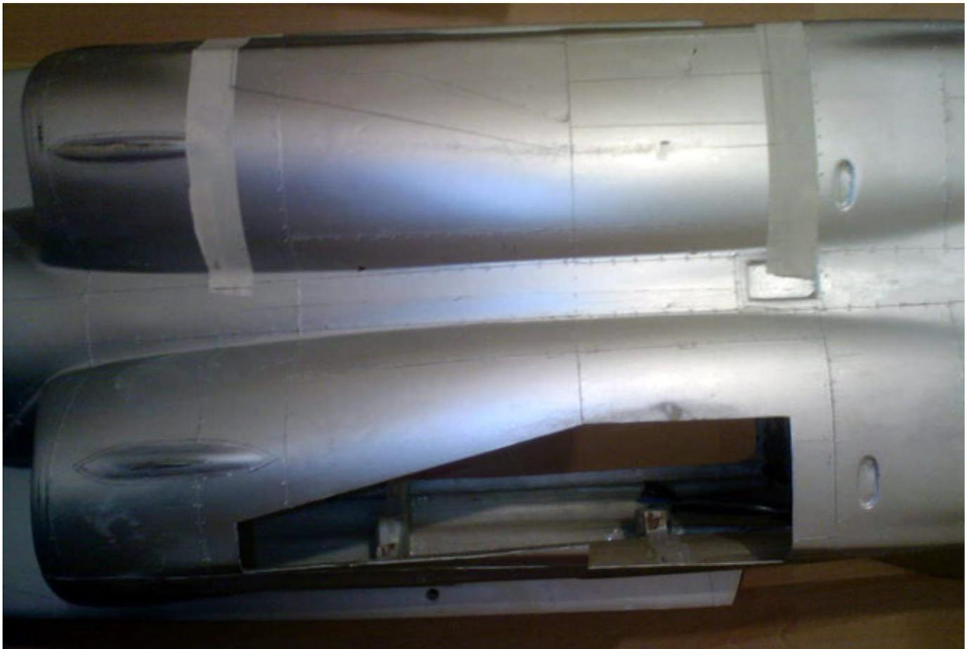
Nun wurden die Servos für die Klappen des Bugfahrwerks eingesetzt.
