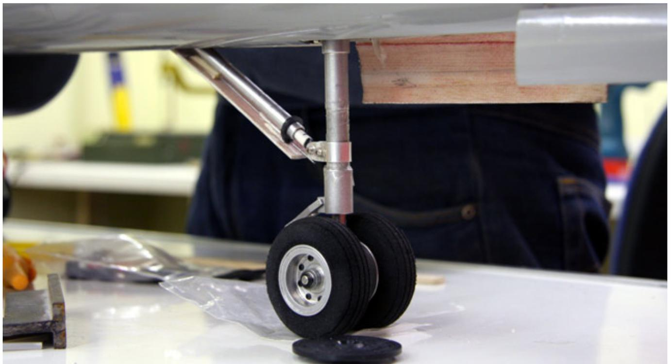
Das Bugfahrwerk ist hier bei dieser F-18 mit einer Strebe, wie beim Original, ausgeführt.
