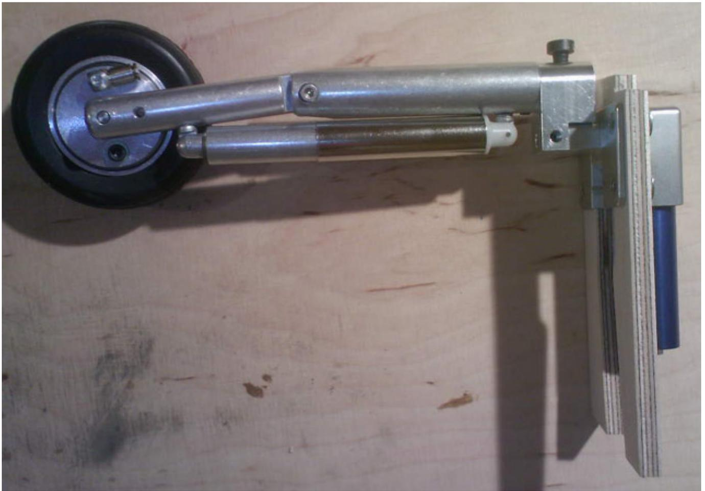
Und nun wurde das Hauptfahrwerk probeweise eingesetzt.
