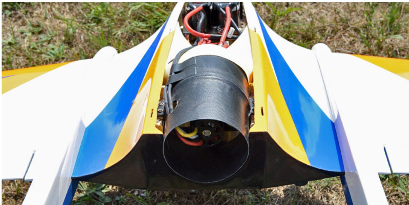
Unser Testmodell wurde, wie ja schon zuvor erwähnt, mit einem 90er WeMoTec Midi bestückt mit einem HET 650-68 Motor (1600 kv) ausgestattet.
