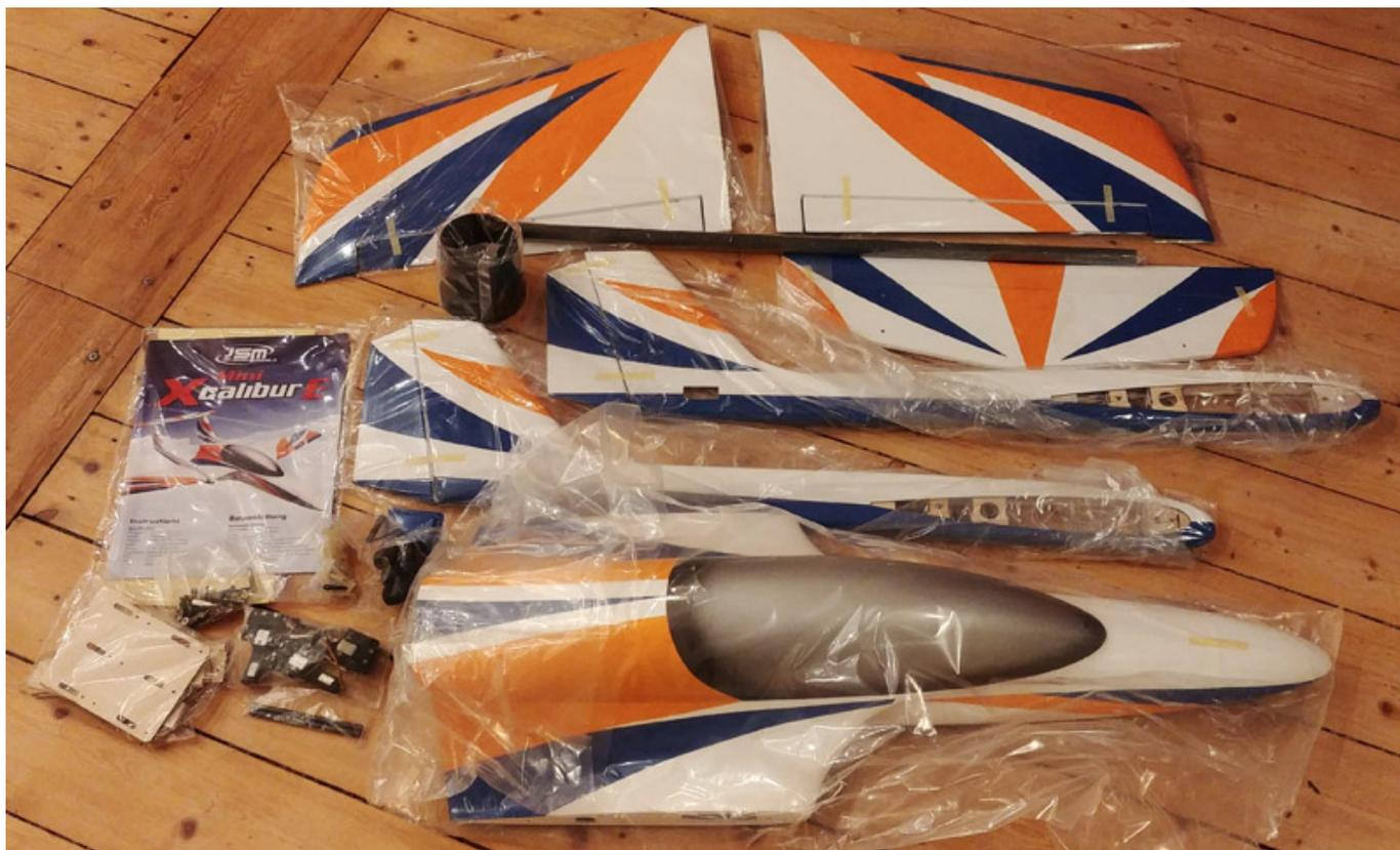
Das Modell ist in Mischbauweise erstellt und wird als ARF-Version angeboten. Der Rumpf inklusive Rumpfnase und Kabinenhaube besteht aus GFK, alle anderen Teile sind in Holzbauweise erstellt und mit Folie bebügelt. Es liegt dem Bausatz eine hervorragende deutsch/englisch-sprachige und farbig bebilderte Bauanleitung bei. Der Bausatz hat, ohne weitere Komponenten, ein Gewicht von 2.211 Gramm.
