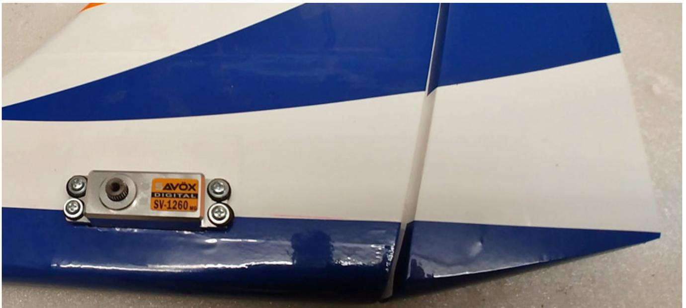
Die Querruder werden montiert und die Servos in die Tragflächen verbaut. Für die Kabeldurchführungen sind netterweise Bindfäden in den Flächen vorbereitet.
