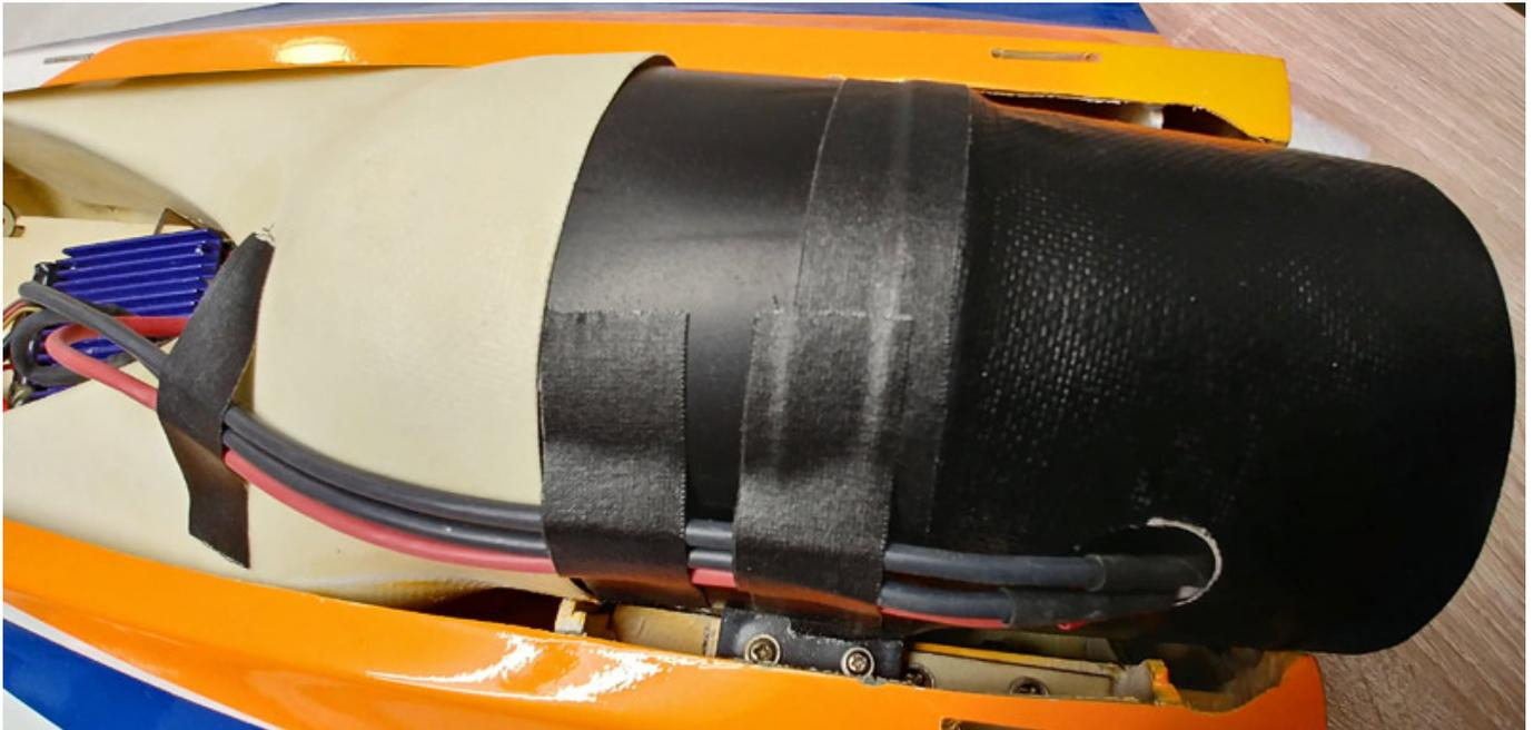
Wir bauen den gelieferten WeMoTec Impeller problemlos an seinen Platz und verbinden die Anschlusskabel mit unserem Regler. Dieser liegt im Rumpf vor den Einläufen und wird mit Klettband fixiert. Als Schubrohr haben wir eines von WeMoTec, passend zum Impeller, mit einer Länge 80 mm montiert.
