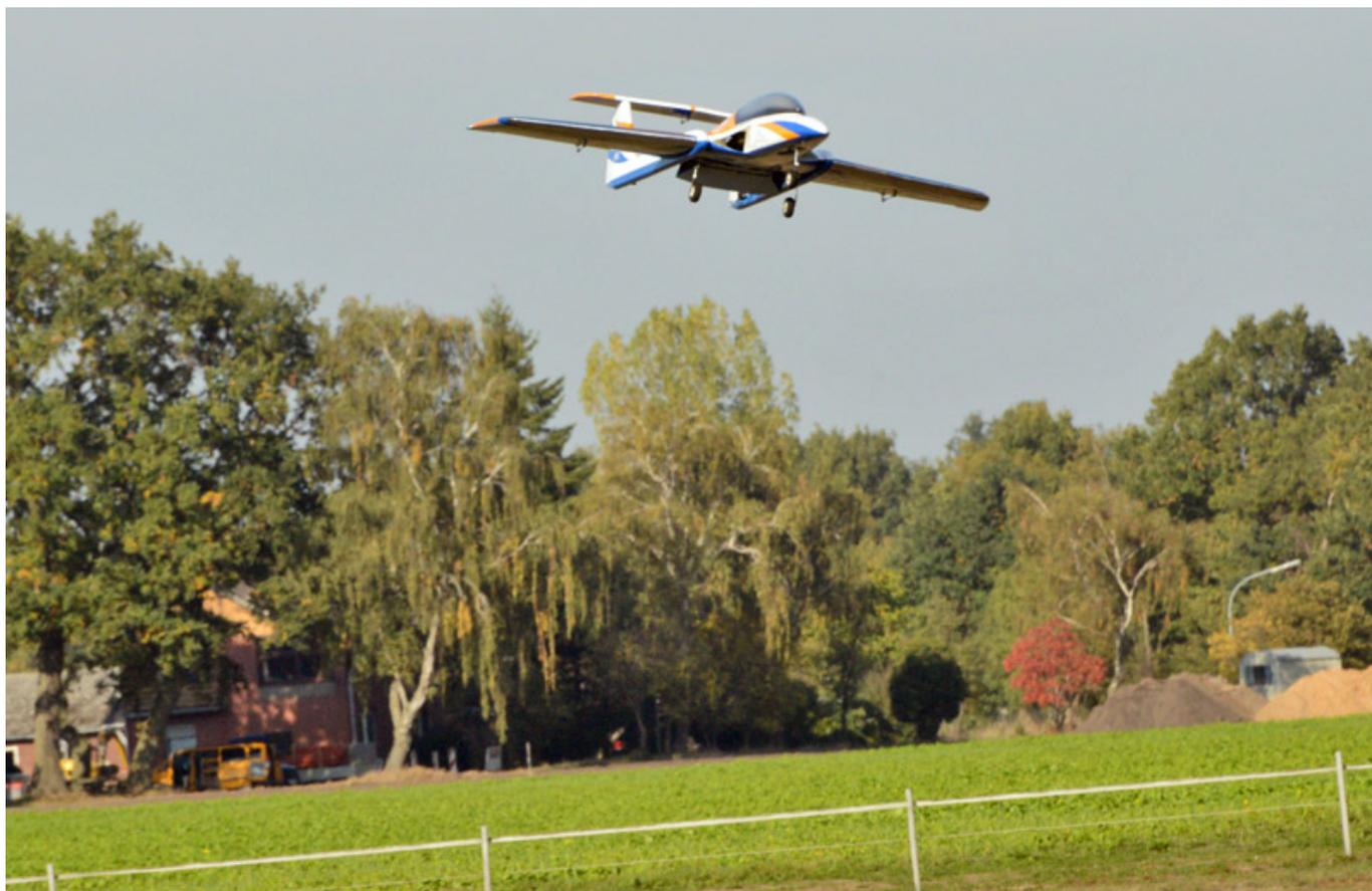
Die Langsamflug-Eigenschaften sind ebenfalls sehr ausgewogen. Was das Modell überhaupt nicht mag, sind enge Kurven mit Rückenwind und reduzierter Leistung. Dann kippt der Xcalibur unvermittelt ab und muss mit Gaszugabe und Gegensteuern abgefangen werden.
