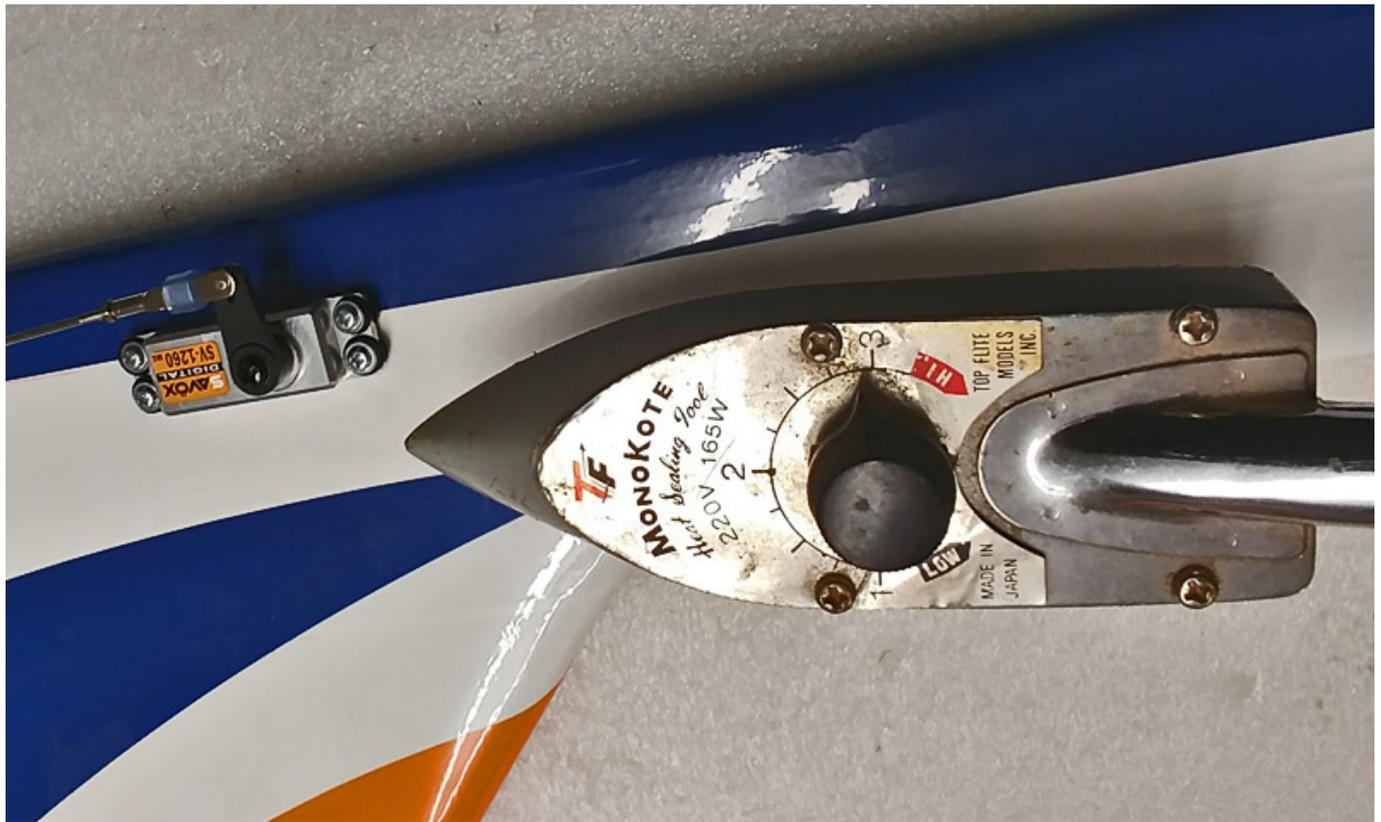
Einige Teile, wie zum Beispiel die Bohrungen in den Leitwerkträgern, mussten zudem nachgebohrt und nachgefeilt werden. Ein Gewinde in den Leitwerksträgern musste auch nachgeschnitten werden (siehe Foto), damit man das Höhenleitwerk auch einwandfrei befestigen kann.
