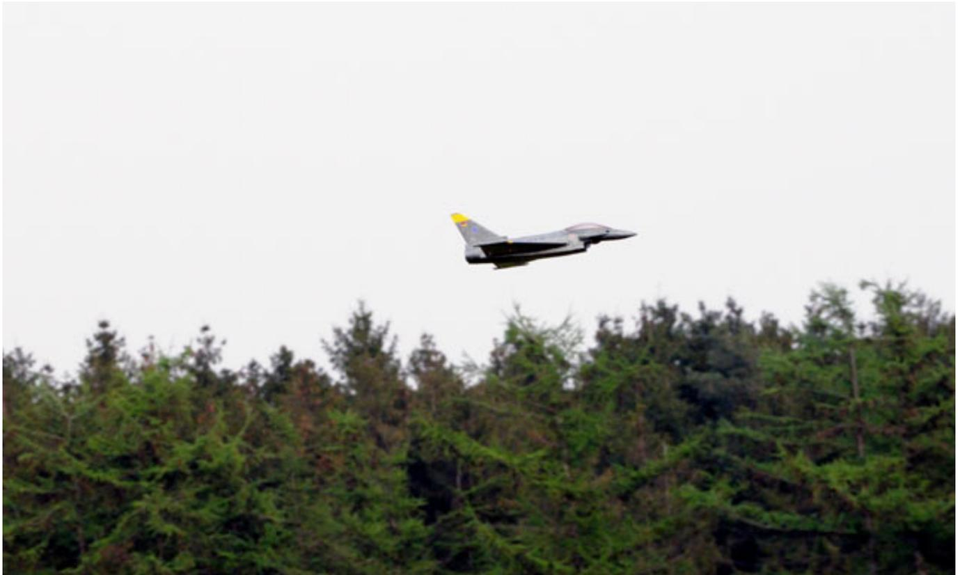
Der Carson Eurofighter ist im mittleren Geschwindigkeitssegment einzuordnen. Wer es besonders schneller liebt, der kommt um ein Tuning daher nicht herum. Leider kommt man nicht so einfach an die Impeller heran. Für den Normalgebrauch ist die Geschwindigkeit aber OK aber die Vollgasphasen sind dabei sehr ausgeprägt. Einige setzen 4 S Akkus ein. Der Strom liegt dann bei ca. 55 A. Wie lange der Motor das aber mit macht, sei dahingestellt. Es stellt sich dann ein Schub von fast 800 p ein.
