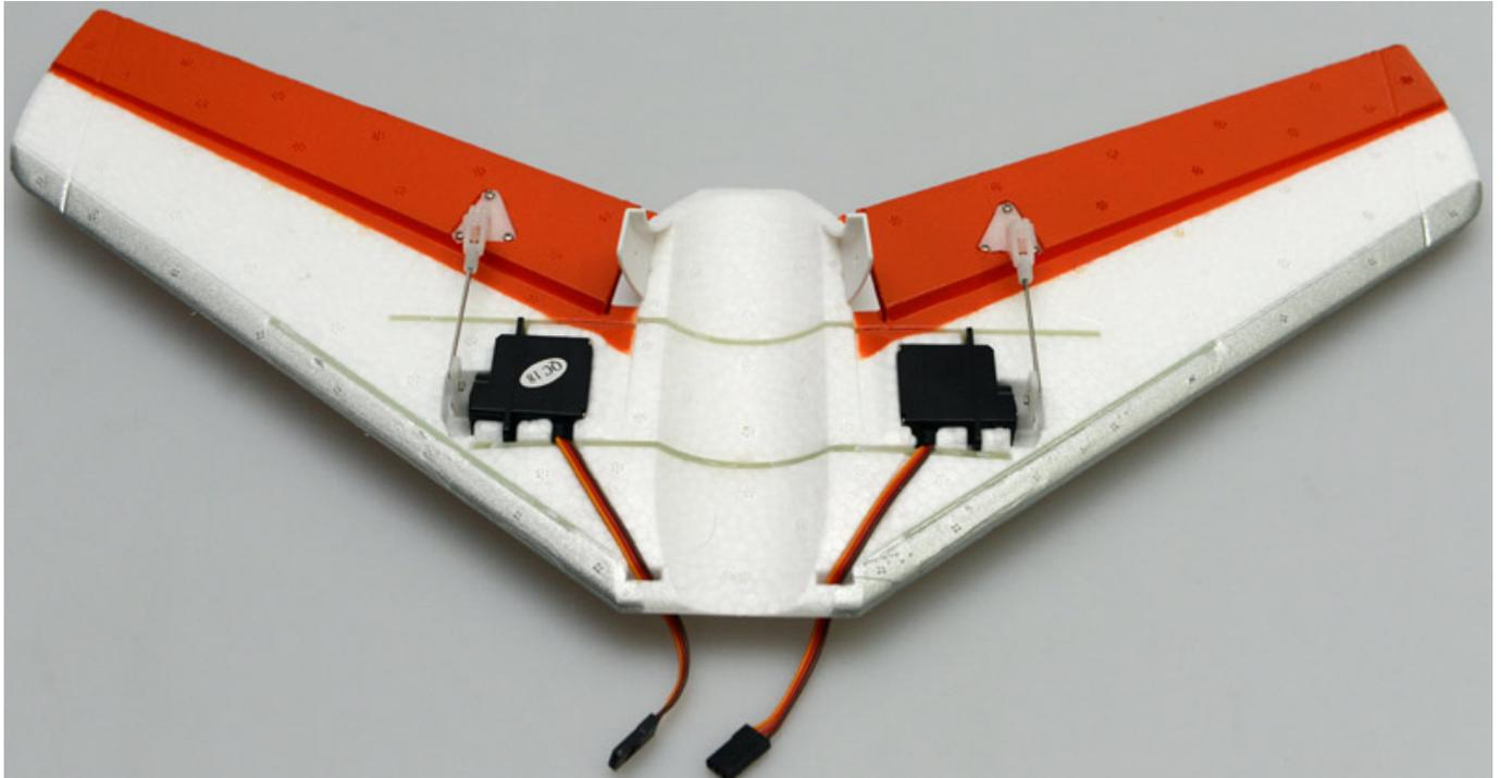
Die Stecker auf beiden Seiten entsprechend mit Labels ("L" und "R") versehen. Man sollte überprüfen ob die Servostecker auch bis Anschlag eingeschoben sind.
