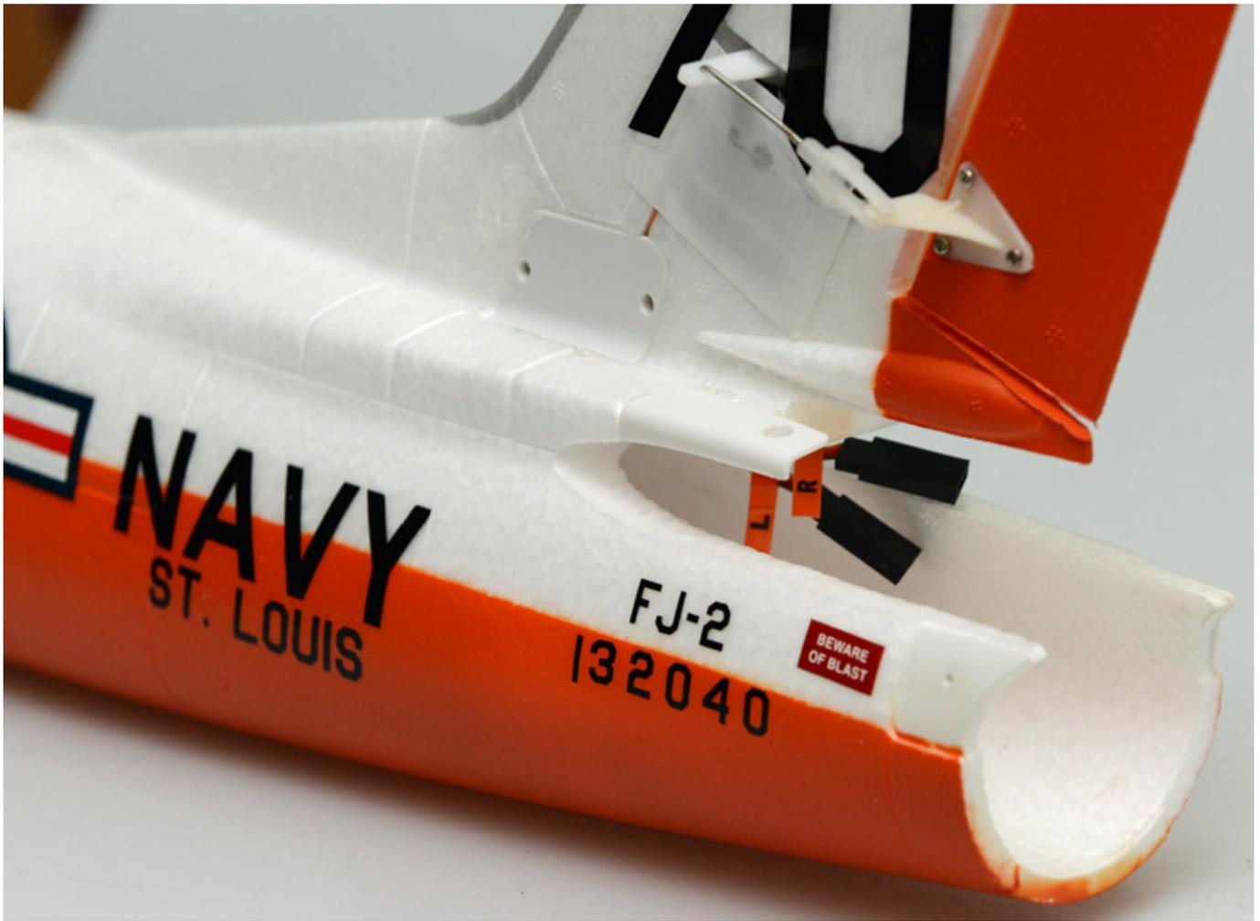
Nun muss man die beiden Kabel vorne im Rumpf orten und dann vorsichtig die Kabel, bzw. Stecker in Richtung Rumpfinneres ziehen, so, dass sie fast im Rumpf verschwinden. Erst jetzt das Höhenleitwerk endgültig aufsetzen und mit Vier Schrauben befestigen. Die Kabel dürfen auf keinen Fall noch in den Strömungskanal ragen und das Leitwerk darf die Kabel auch nicht einquetschen.
