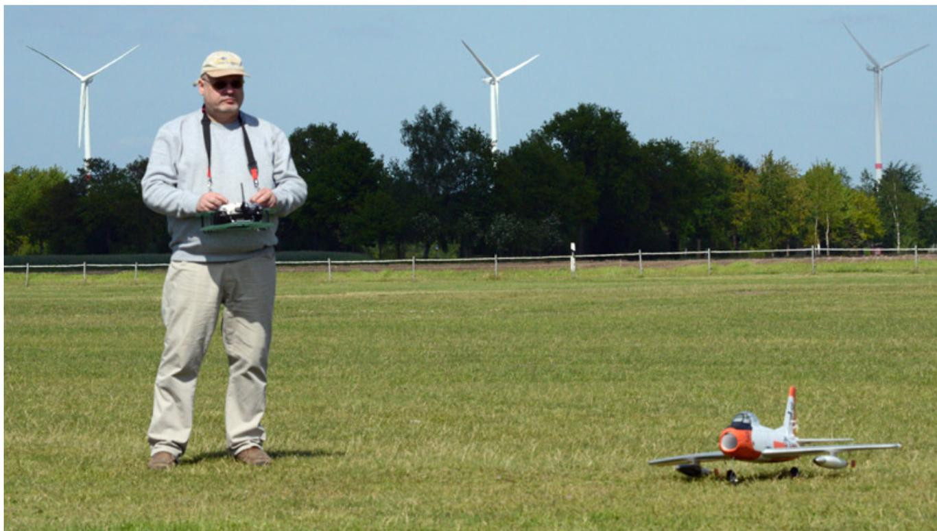
Der Start auf Rasen ist aber mit dem Standardantrieb überhaupt kein Problem und die Rollstrecke ist nicht besonders lang. Es zeigte sich auch, dass der in der Anleitung angegebene Schwerpunkt (155 mm von Flügelvorderkante am Rumpf gemessen) sehr gut passt. Positiv ist, dass das Modell relativ unempfindlich gegenüber Schwerpunktänderungen ist.
