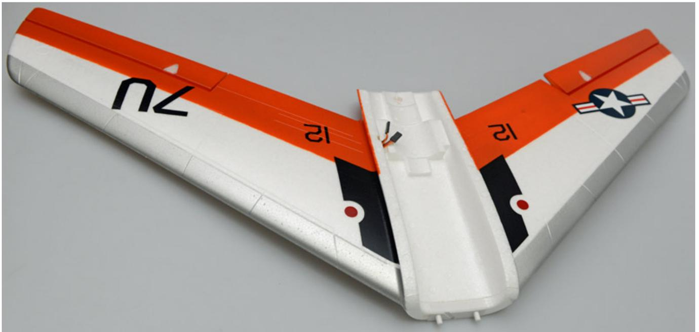
Als erstes steckt man den Flügel halb in den Rumpf, schließt die beiden Servokabel an (Anschlussfolge egal da an Y-Kabel angeschlossen), verstaut die Servostecker in den dafür vorgesehenen Ausschnitt. Nun verschraubt man den Flügeln mit einer M3-Gewindeschraube. Die Mutter befindet sich in einem Plastikstück hinter dem Impeller (s. Abb. unten).
