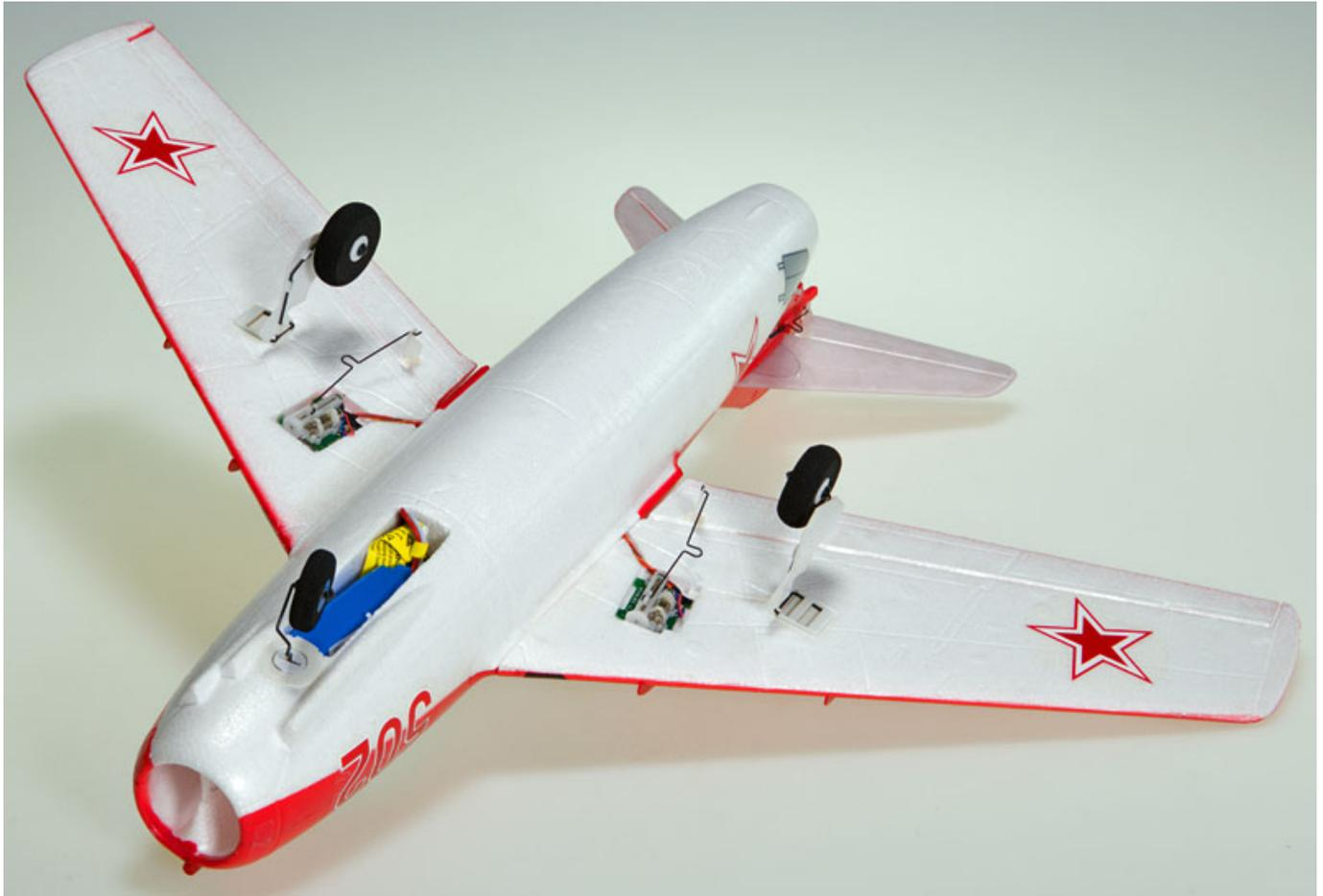
Das Modell kommt auch fertig abgestimmt beim Piloten an. Nach dem Anschluss und Binding des Empfängers waren alle Ruder absolut in Neutralposition. Hier war also kein Nachjustieren erforderlich. Eine Justierung erfolgt bei Bedarf mit einer Pinzette, in dem die jeweilige Runderanlenkung geweitet oder verengt wird.
