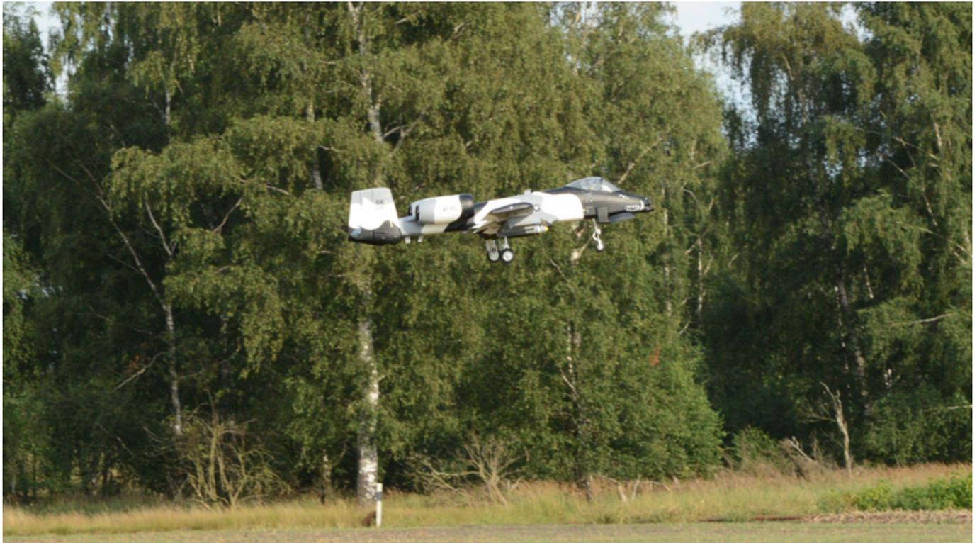
Beim Landen sollte man sehr lange mit Schleppegas anfliegen und die frühzeitig die großen Landeklappen setzen. Ggf. kann man bei den Höhenrudern über einen Mischer noch etwas Tiefe von 1 mm bei gesetzten Landeklappen zumischen um bei Schleppegas das Sinken des Modells zu gewährleisten. Dann ist das Landen auch kein Problem. Das Gas sollte man wirklich erst kurz vor dem Aufsetzen ganz wegnehmen.
