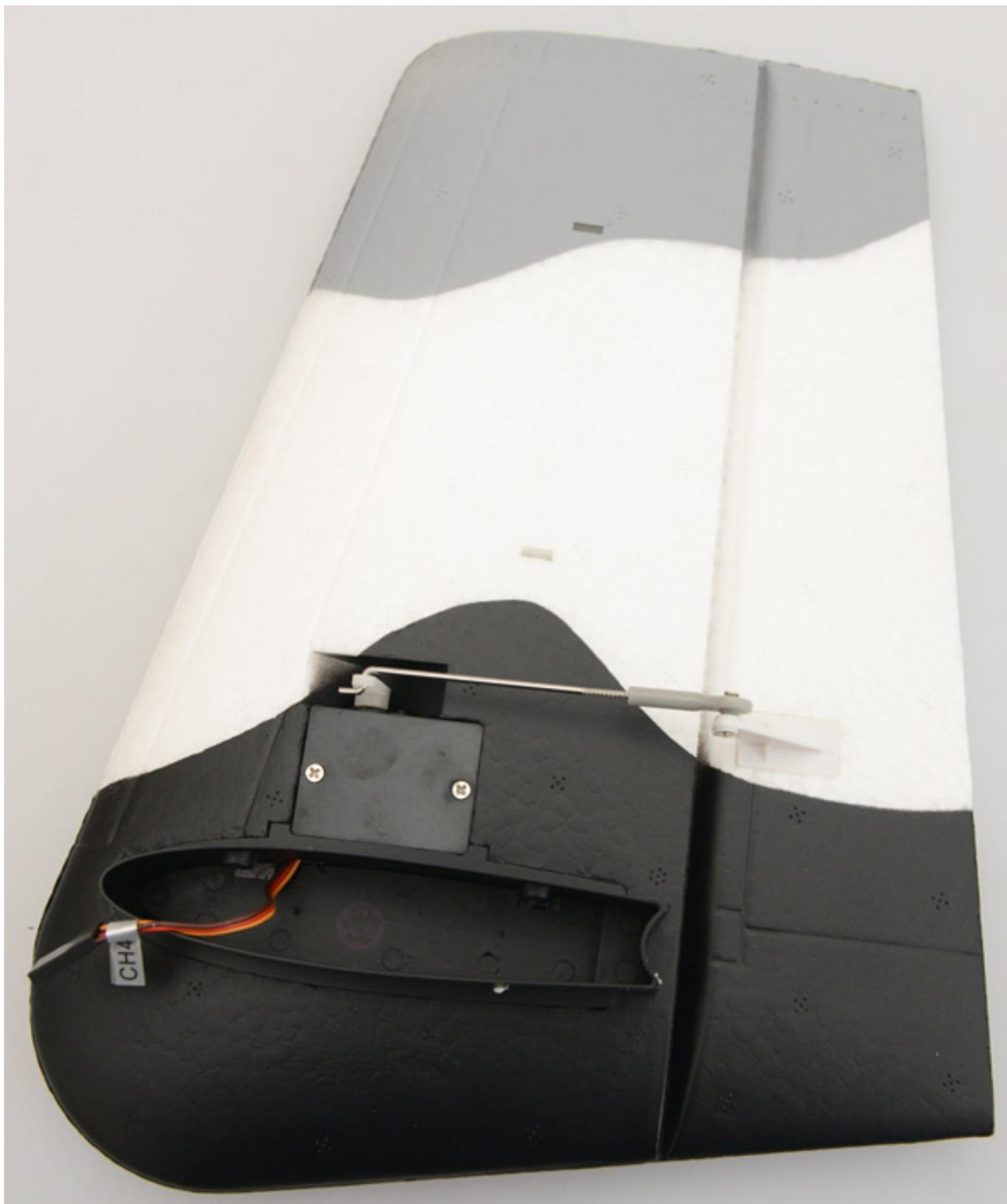
Zuvor müssen die Servokabel in die schon vorhandenen Verlängerungskabel angesteckt werden (s. Abb. unten).
