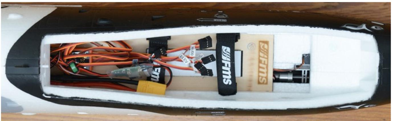
Um den im Handbuch vorgegebenen Schwerpunkt von 80 bis 85 mm erreichen zu können haben wir uns statt für einen leichten 5.500 mAh 6S-Akku von Red Power (im Vertrieb von [Pichler](#)) entschieden, der lediglich 670 Gramm wiegt. Diese Akkus fliegen wir mittlerweile in einigen Modellen und haben sehr gute Erfahrung mit diesen Akkus gemacht.
