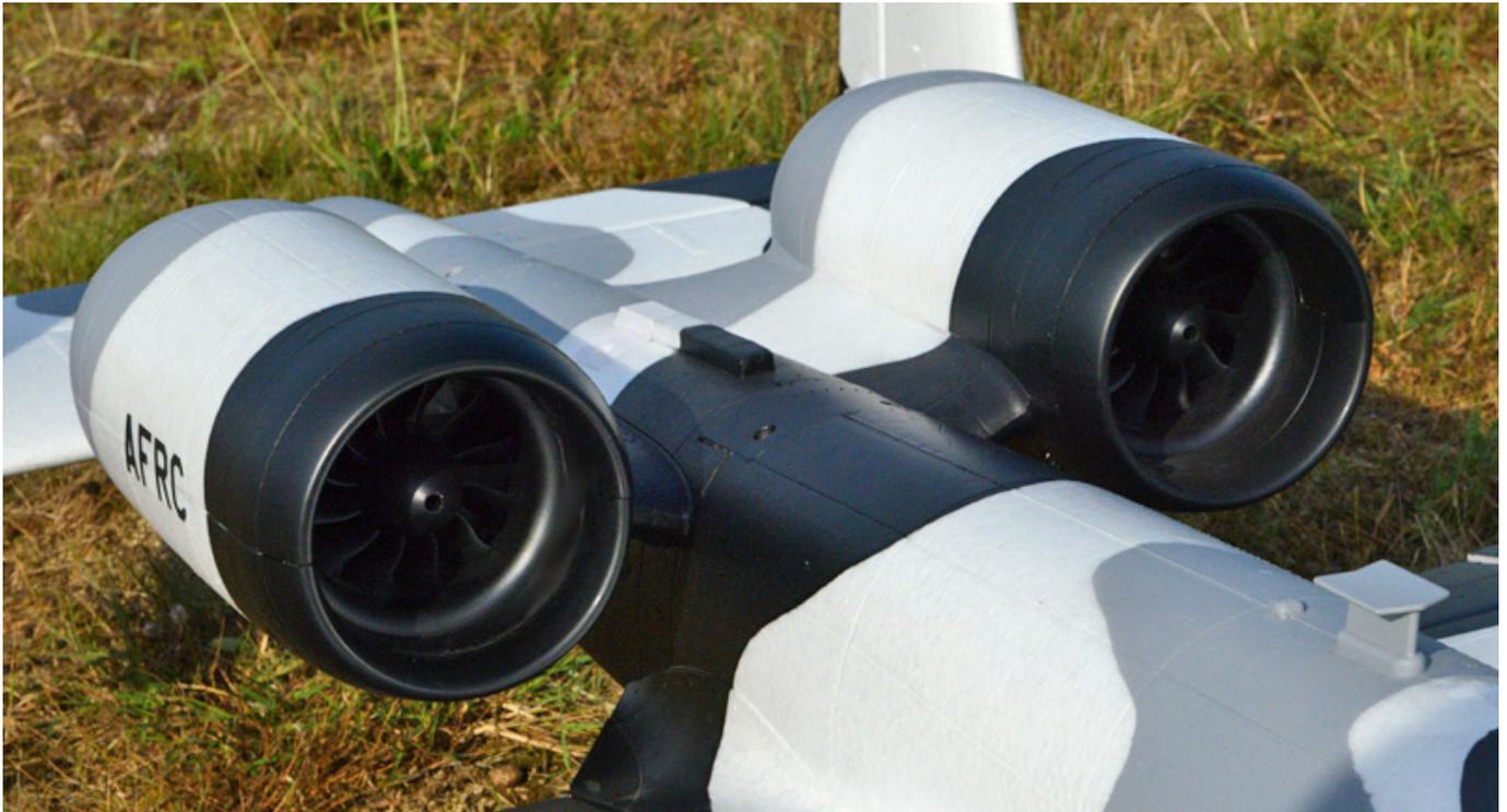
Das Modellgewicht mit dem Red Power 6S LiPo-Akku mit 5.500 mAh lag komplett mit Waffenattrappen bei 4,41 kg. Der Antrieb macht einen guten Job denn er liefert ca. 4,2 kp Schub bei einem Strom von ca. 138 Ampere. Die 500 mAh mehr Akkukapazität des Red Power Akkus gegenüber der Hersteller-Akkuempfehlung (5.000 mAh) zahlen sich also bei dem hohen Strom aus. Das Verhältnis von Gewicht zu Standschub liegt ca. 0,95. Das ist ein sehr und überzeugender Wert.
