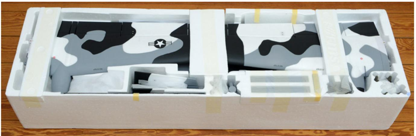
Das Modell besteht aus wenigen EPO-Komponenten als da wären Rumpf und Cockpit, zwei Flügelhälften, Höhen- und Seitenleitwerk, zwei Holme sowie jede Menge Waffen-Attrappen, Kleinteile und das Handbuch mit den Montageanweisungen in englischer und deutscher Sprache. Die Nase und die Kanone neben der Nase sind aus Kunststoff und daher sehr robust. Da sollten eigentlich alle Hersteller so ausführen - die Realität sieht aber leider anders aus.
