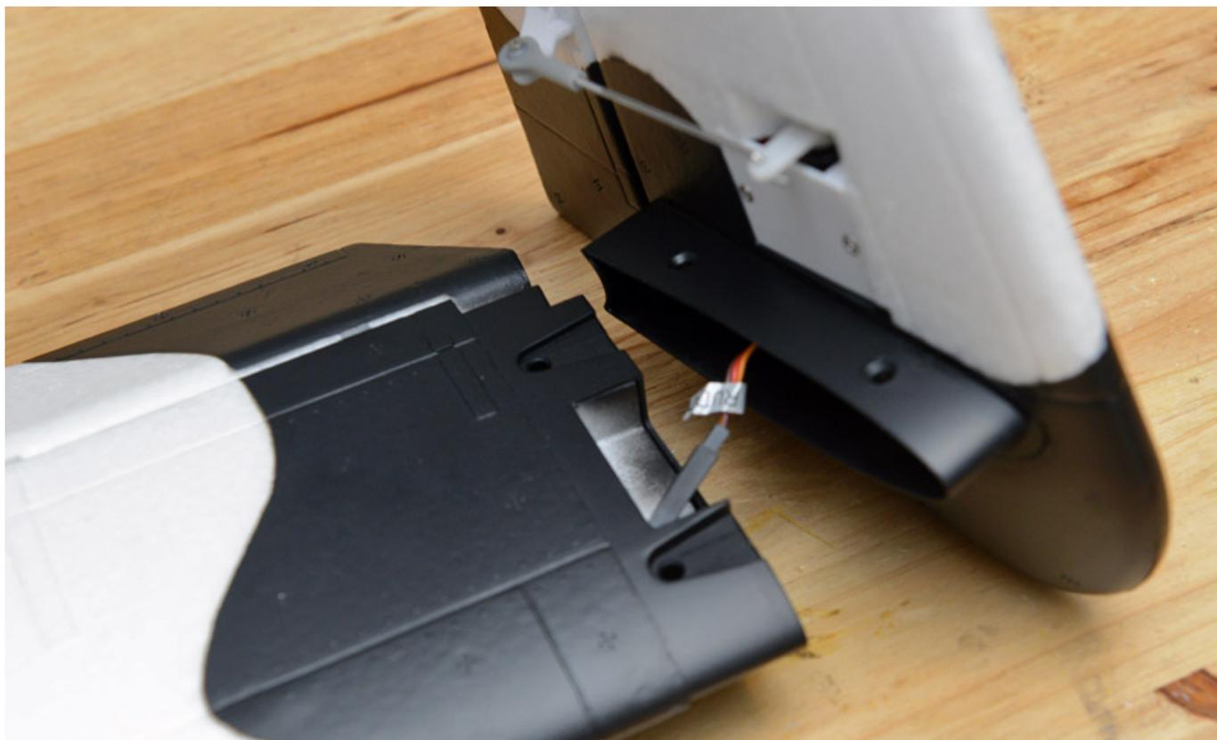
Dann wird das zusammengesetzte Seiten-/Höhenleitwerk mit vier Schrauben unten am Rumpf befestigt (s. Abb. unten). Vorher werden die drei Servokabel an den dort bereits verlegten Servo-Verlängerungskabel angesteckt.
