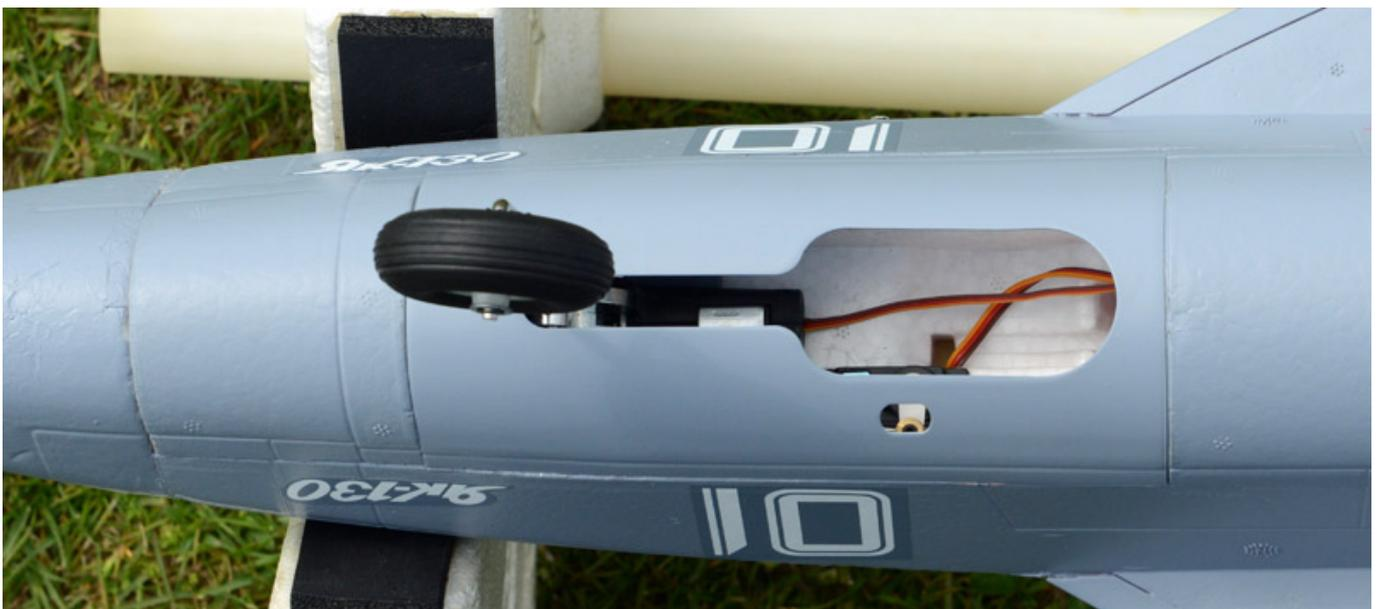
Die Anlenkung des Bugfahrwerk musste noch für die den Geradeauslauf leicht verstellt werden. Das kann man aber leicht mittels der Servoanlenkung korrigieren.
