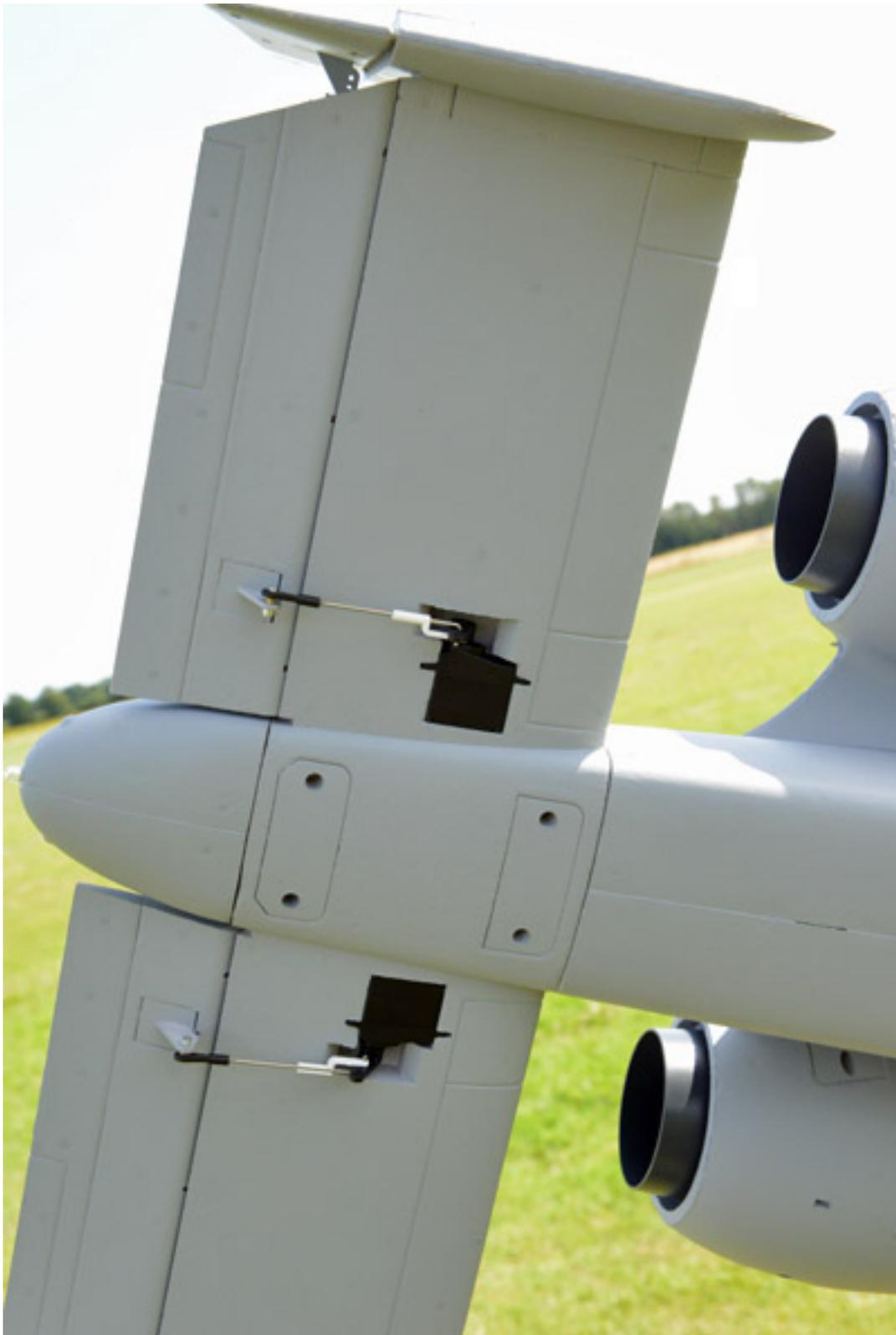
Nun müssen die Anlenkungsgestänge noch an den Rudern montiert werden.
