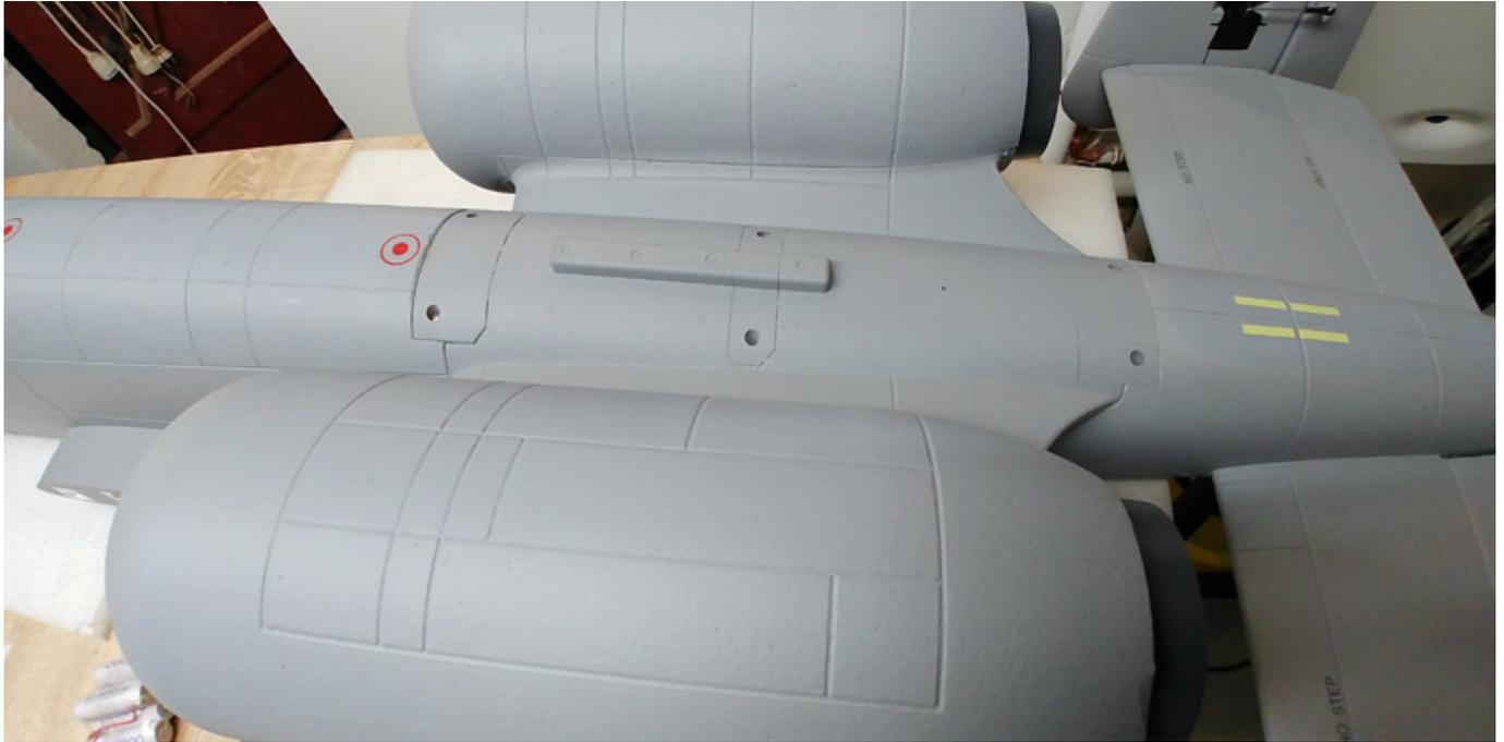
Wir haben uns beim Antrieb für die 90-mm-Impeller-Variante mit dem optionalen Gondelaufsatz entschieden. Der Umbau ist nicht besonders schwierig.
