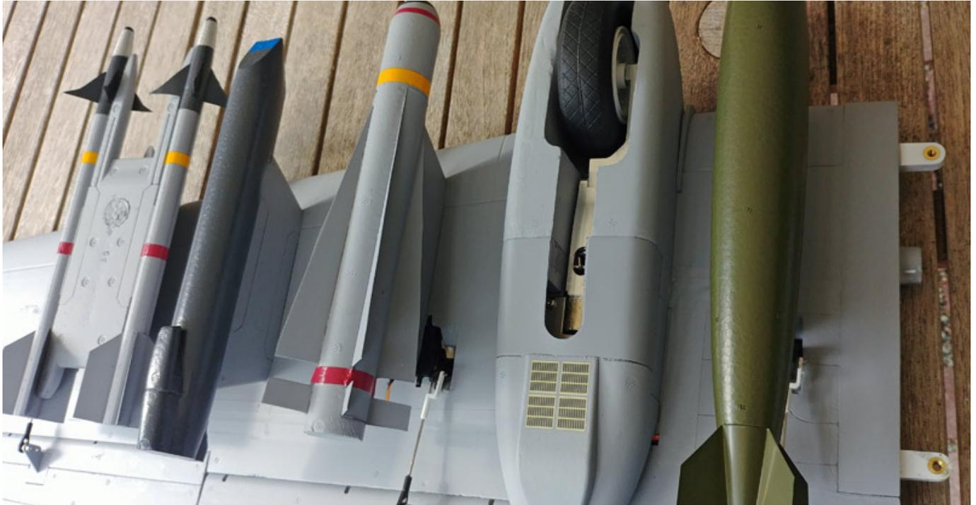
Die dem Bausatz beiliegenden Waffenattrappen werden an den Flügeln mit gut durchdachten Schiebevorrichtung befestigt. Die Waffen können zum Transport abgenommen werden.
