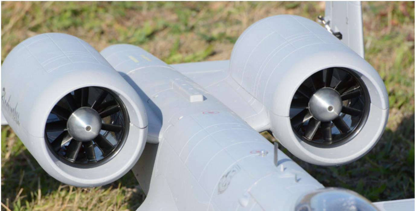
Der ermittelte Strom in der Version mit WeMoTec Midi Fan evo 90-mm-Impeller mit HET 650-58-1970 beträgt pro Antriebsstrang maximal 94 Ampere, bzw. nach 20 Sek. noch 87 Ampere. Der gemessene Schub liegt knapp über 6 kp. Das lässt einiges an Performance erwarten, denn das ist ein Schub-/Gewichtsverhältnis von ca.1:1.
