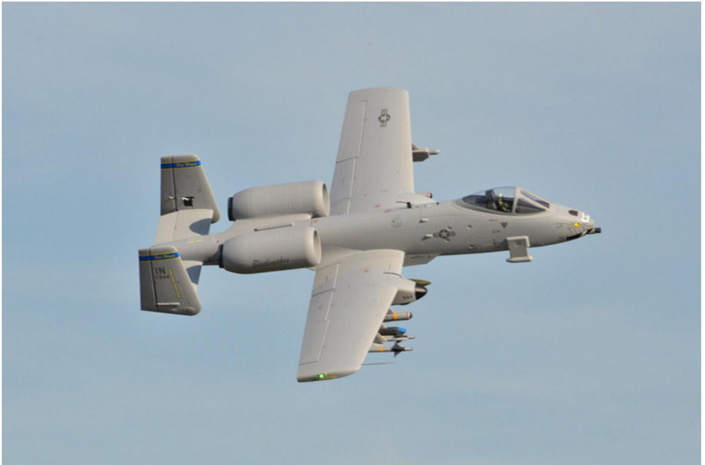
Durch den Umbau auf die 90-mm-WeMoTec-Impeller steht ein beachtlicher Schub von über 6 kp zur Verfügung. Die Leistung kann zum moderaten Fliegen auf gut ein Drittel zurückgenommen werden. Hierdurch kommt man mit den 4.500 er Akkus auf gut acht Minuten Flugzeit. Der Sound ist bei der 90er-Antriebsvariante noch ein Tick besser als bei der Standardversion.
