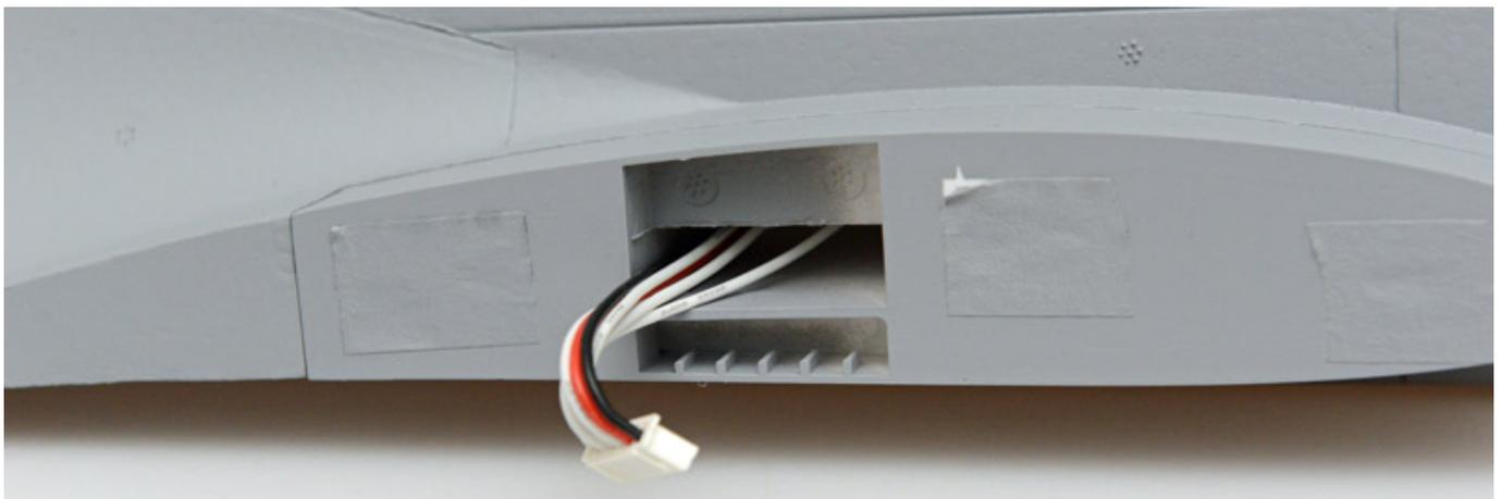
An den Flügeln ist für die Verbindung für Servos und Hauptfahrwerk ein Multi-Pin-Stecker vorhanden.
