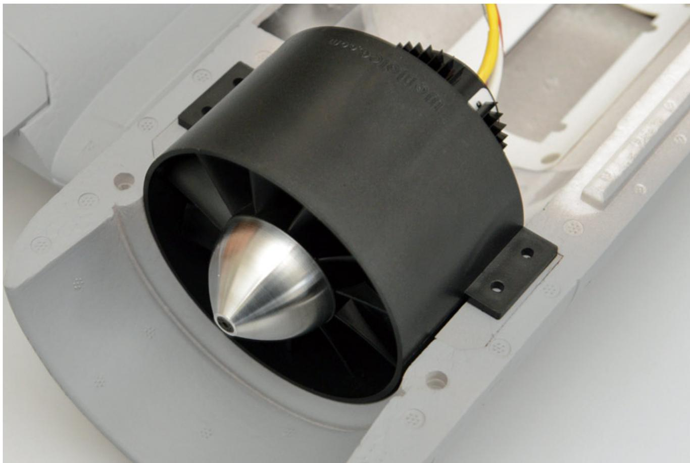
Mit einer Handmaschine sind die WeMoTec-Einlaufringe außen im Durchmesser auf 101 mm zu verkleinern (siehe dazu Abb. oben: WeMoTec 90-mm-Impeller hier noch ohne Einlaufring). Das macht man am besten mit Schleifpapier bzw. einem Schleifblock. Nach dem Zusammenbau wird der 90-mm-Gondelaufsatz so montiert wie der Standard-Gondel-Aufsatz.
