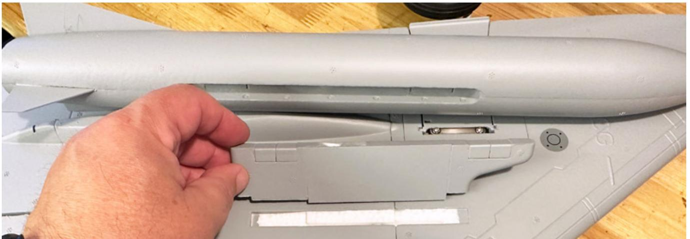
Diese werden eingesteckt und mit dem beiliegendem Kleber mit dem Flügel verklebt. Die Zusatztank-Attrappen werden auf den Träger aufgesteckt und über Magnete gehalten.
