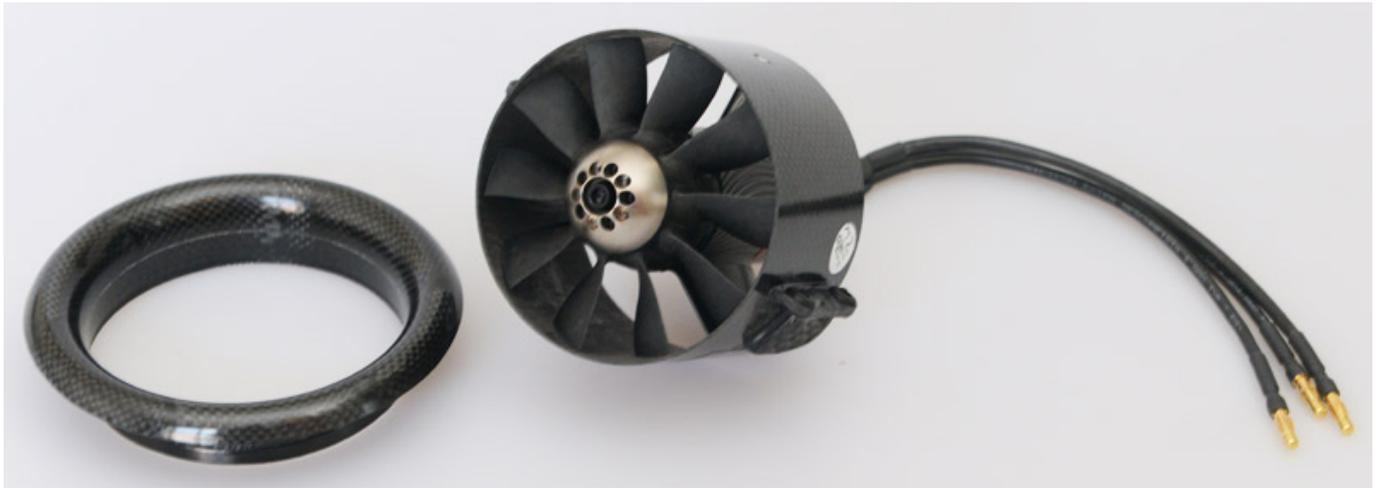
Bei der Kit-Version sollte man als allererstes den Antrieb einbauen. Was man zuvor noch erledigen muss ist die Anpassung an den mitgelieferten und für das Modell zu großen Einlauftring. Der Durchmesser auf den man kommen muss liegt bei ca. 100 mm, bzw. knapp darunter. Das lässt sich mit einer Schieblehre während der Bearbeitung gut kontrollieren.
