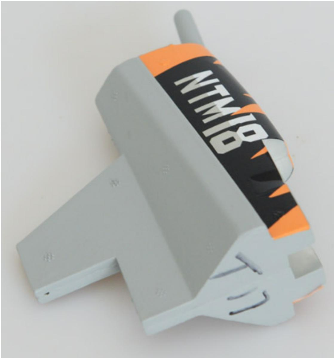
Das hintere Abschlussstück wird ebenfalls mit dem mitgeliefertem Kleber montiert.
