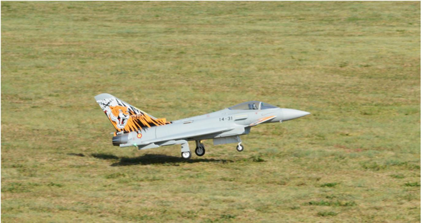
Der neue Freewing Eurofighter hebt bei Vollgas bereits nach kurzer Strecke ab und kann sofort stark an Höhe gewinnen. Das fühlt sich irgendwie mehr als ein Schub/Gewichtsverhältnis von 0,8 an. Das muss wohl an den Strömungsverhältnissen im Flug liegen. An der Oberseite sind übrigens noch zwei Öffnungen, die sich durch Unterdruck bei zunehmendem Schub auch zunehmen öffnen und für zusätzliche Luft sorgen.
