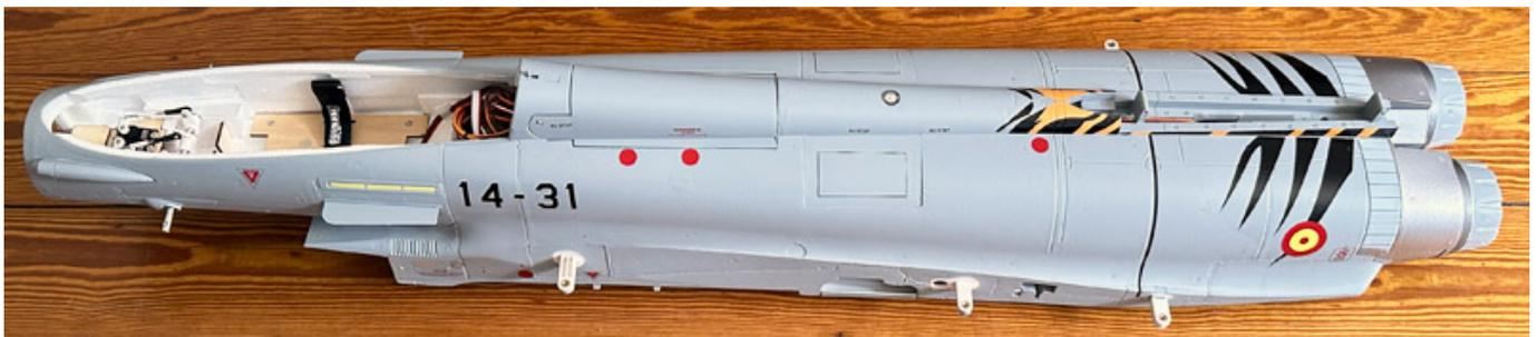
Alle Servos (4 x 9 g, 2 x 9 g Metallgetriebe und 3 x 17 g Metallgetriebe) sind bereits eingebaut, inklusive der Anlenkungen. Benötigt wird ein Siebenkanal-Empfänger für Regler, Seitenrudder, Ruder in den Flächen, die Canards, Fahrwerk und Luftbremse, die ebenfalls schon fertig und betriebsbereit eingebaut ist.
