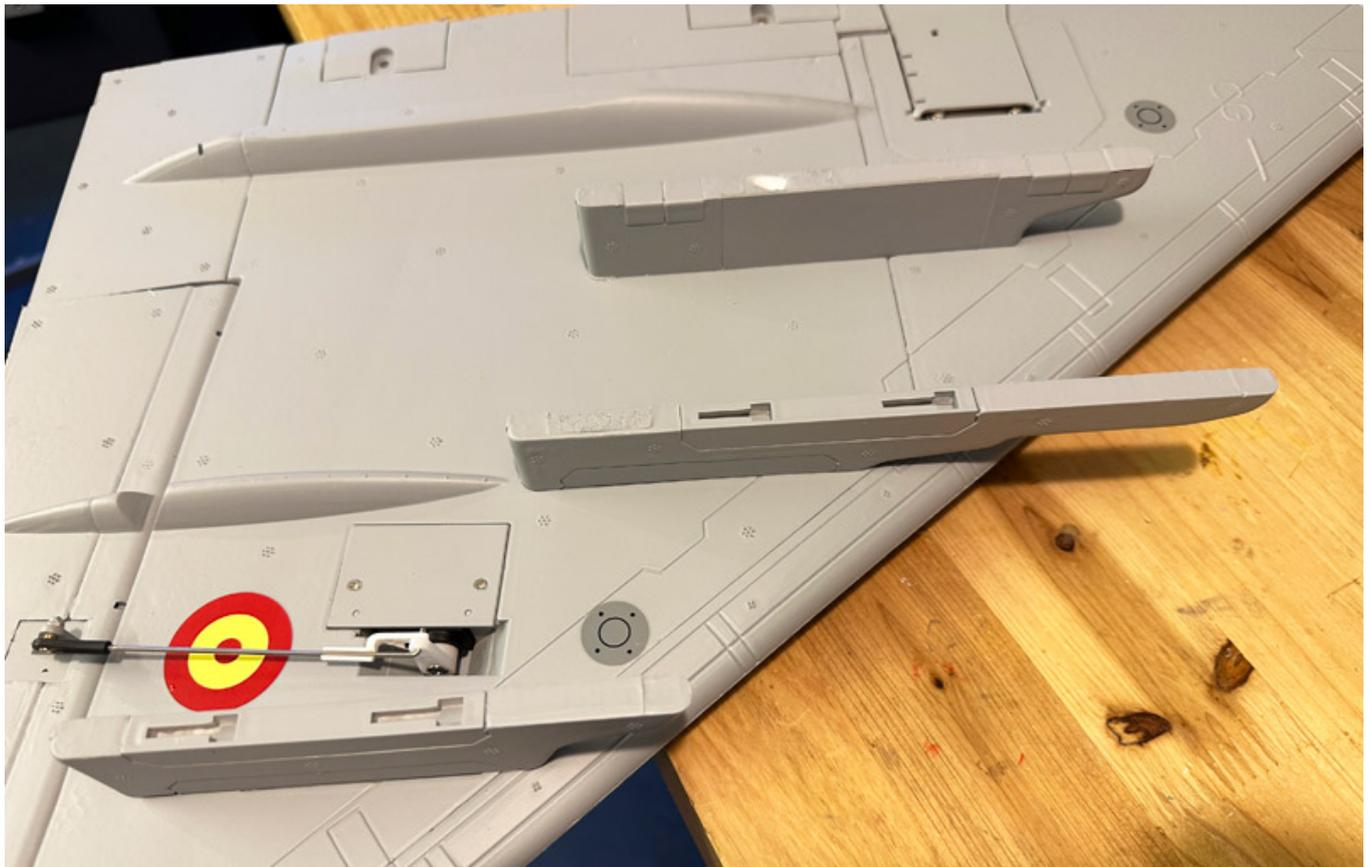
Die beiden äußeren Waffenträger werden nur gesteckt und damit ist die Flügelmontage auch schon abgeschlossen.
