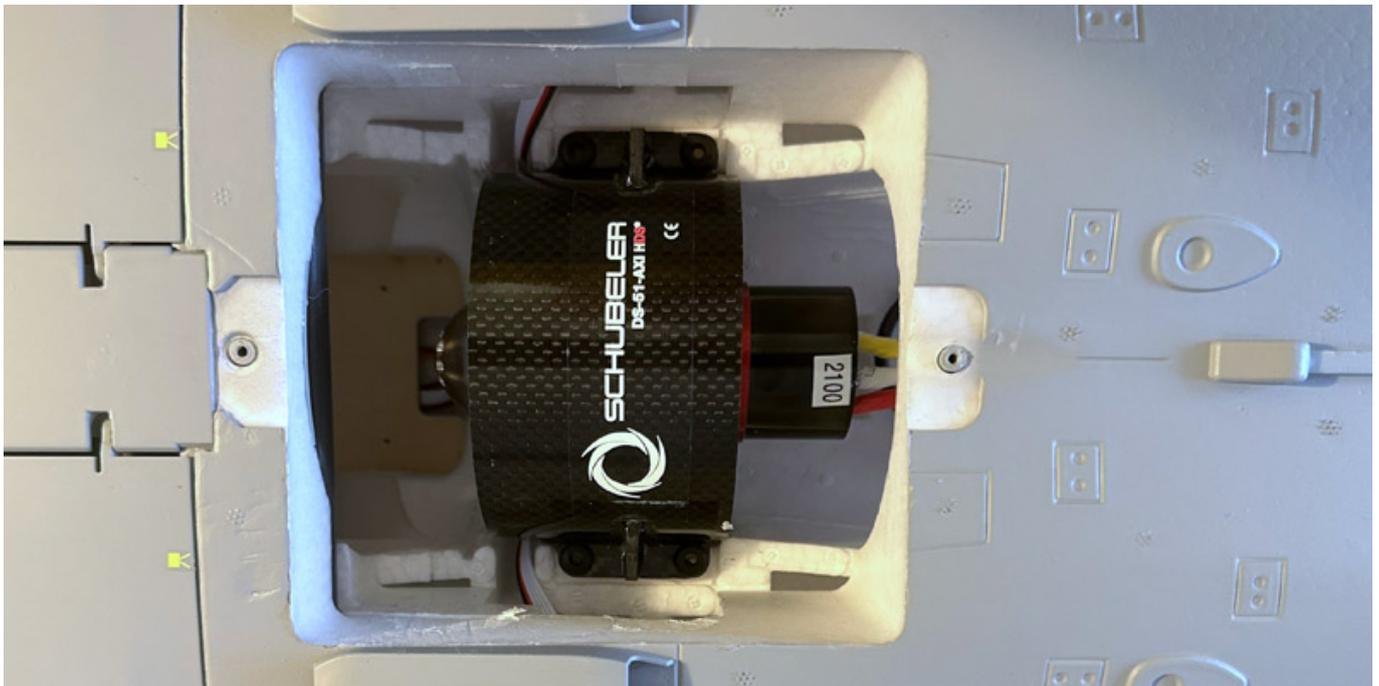
Die Befestigung erfolgt mit vier Schrauben wie zum Beispiel SPAX Z2 3x20 oder Stabilit 1.B 3,0x16. Die hinteren (zur Düse gewandten Seite) vorgebohrten Schraublöcher passen exakt zu der Befestigung des DS-51 HSD. Für die vorderen beiden Schrauben kann man mit 1,5 mm etwas vorbohren und dann lassen sich die Schrauben eindrehen. Die Impeller-Abdeckung passt ebenfalls ohne Modifikation.
