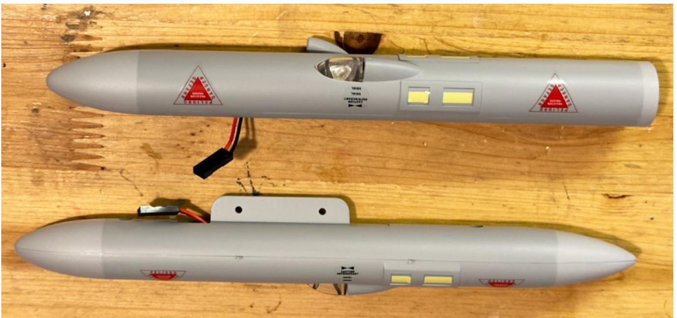
Die beiden ESM/ECM-Pods-Attrappen am Flügelende werden eingesteckt und verschraubt, Da hier auch Beleuchtung eingebaut ist, muss man die Servostecker
