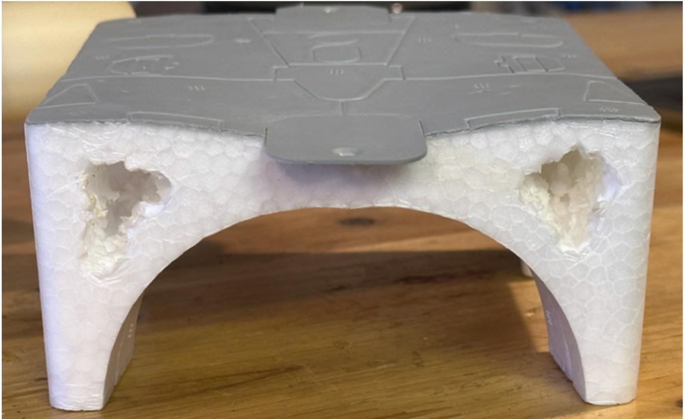
Eine andere Methode, bei der man allerdings mehr Gewicht hinzufügen muss, weil die Position nicht so weit wie die Düsen vom Schwerpunkt entfernt sind, ist die Impellerabdeckung (s. Abb. oben). Da lassen sich hinten Hohlräume schaffen, um so bis zu 150 Gramm Bleikugeln einzubringen und zu verkleben. Das reichte bei unserer Konfiguration aber nicht ganz aus.
