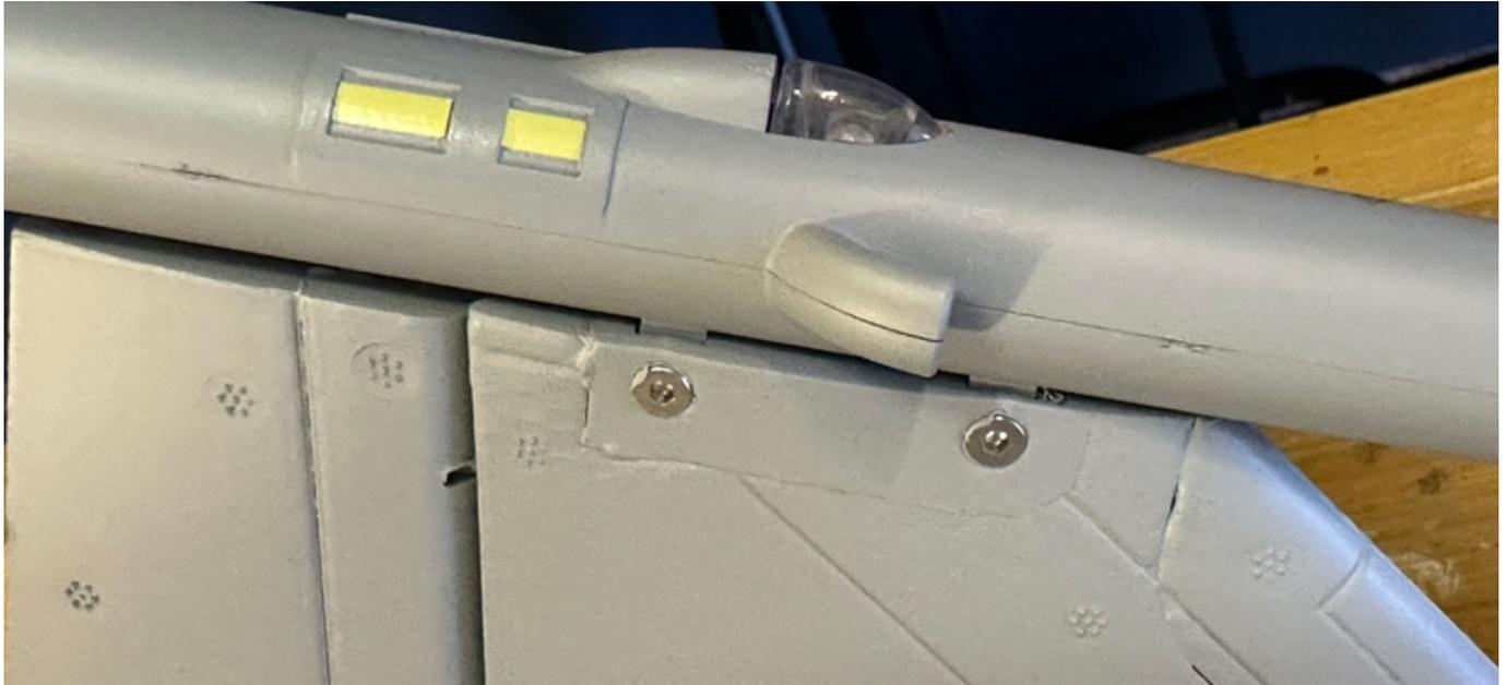
Als nächstes wird die Aufnahme für die beiden Zusatztanks montiert.
