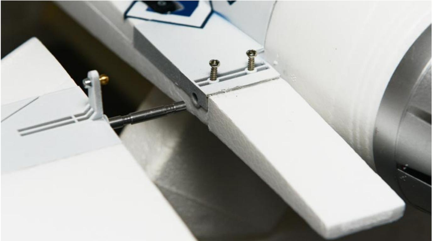
Im Ruder wird nun ein Ring eingelegt. Vorher sind dort die beiliegenden M2-Schrauben leicht einzudrehen. Der Ring wird dann in die Aussparung des Pendelleitwerks gelegt, das Leitwerk wird auf den Metallstift aufgeschoben und dann wird der Ring positioniert und mit der Schraube fixiert. Es sollte nun kein Spiel am Pendelleitwerk vorhanden sein und das Leitwerk sollte sich leicht, ohne Widerstand, bewegen lassen.
