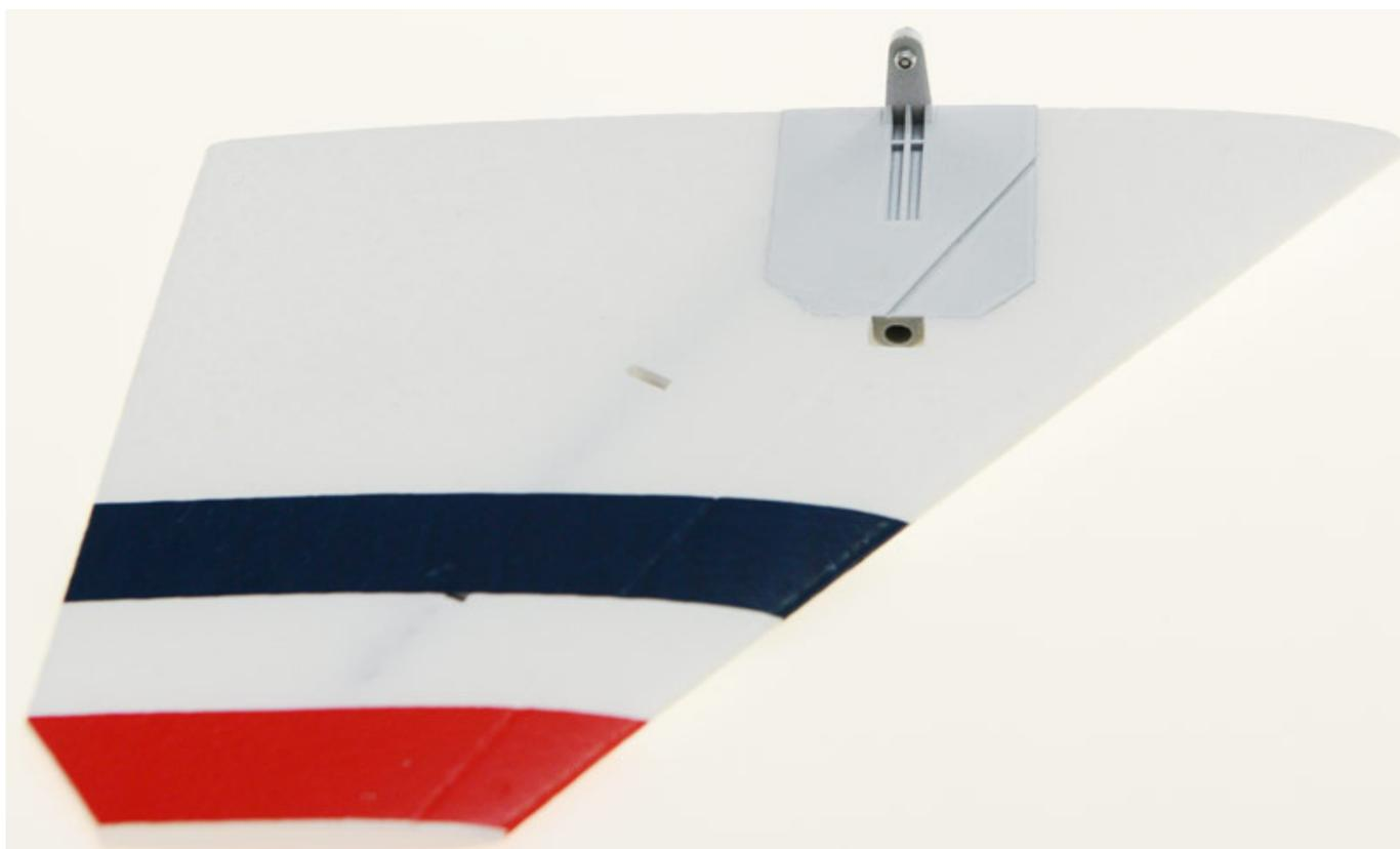
Es werden zwei Metallstifte, die sich natürlich im Lieferumfang befinden, in die dafür vorgesehene Bohrungen in die beiden Heckplastikteile eingeschoben und mit zwei
