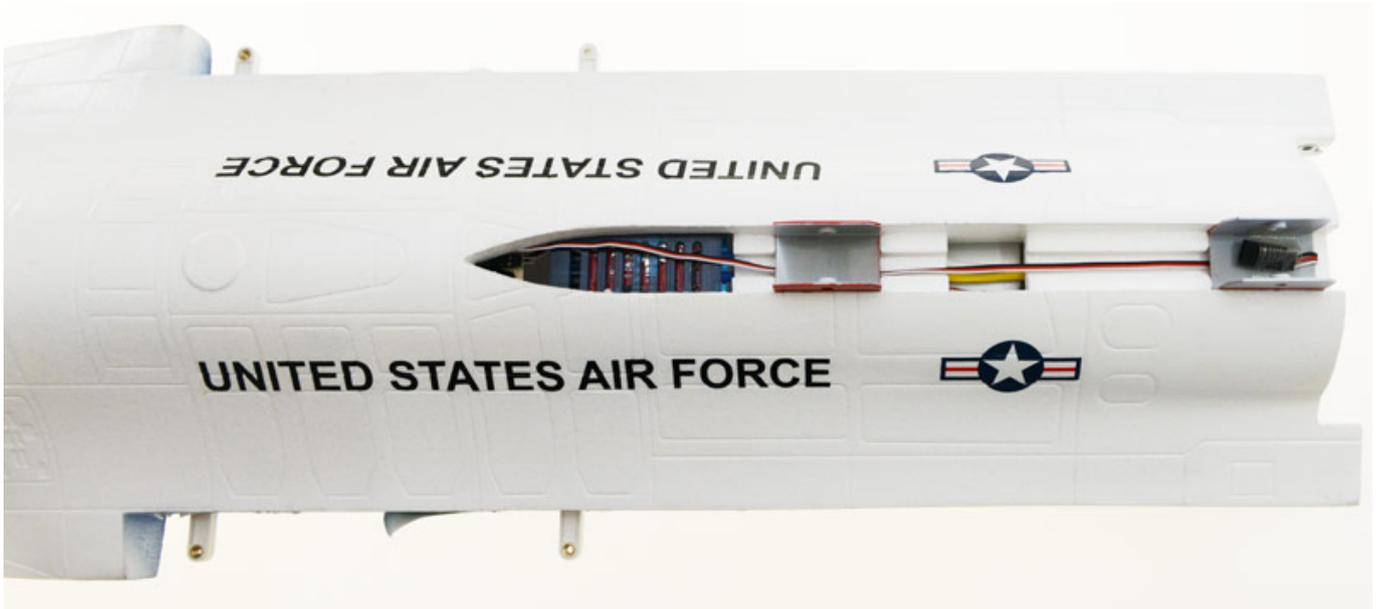
Die Düse ist mit einer integrierten Nachbrennersimulations-Beleuchtung ausgestattet (s. Abb. unten). Man muss daher als erstes das Kabel für die Beleuchtung an der Kabelverbindung am Ende des Hecks anschließen und dann die Düse mit dem mitgeliefertem Kleber verkleben. Bei der F-16 benötigt kann man alle Klebungen mit dem beiliegenden Kleber durchführen.
