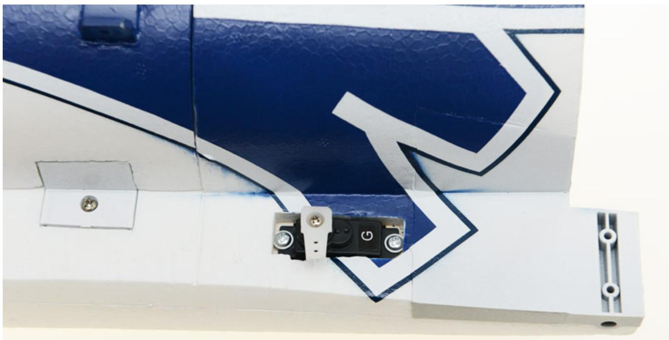
Das Pendelhöhenruder ist fertig aufgebaut und auch schon mit der Mitnahme für die Pendelruderanlenkung versehen.
