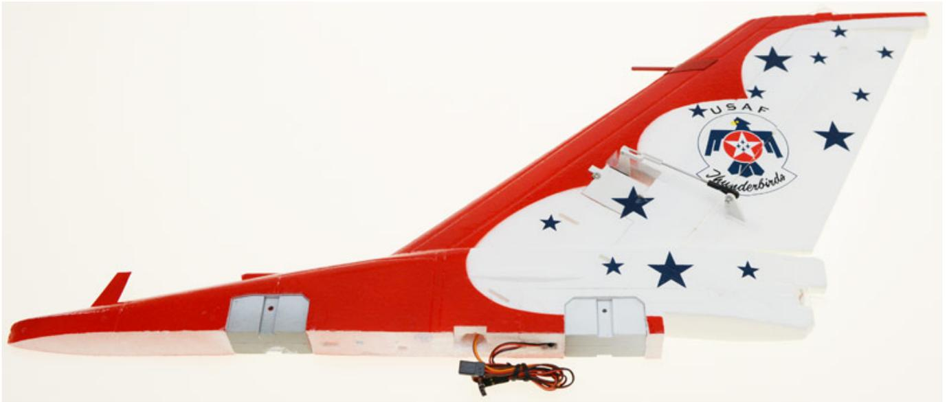
Die drei Kabel müssen unter dem Plastikbefestigungsaufnahme geschoben werden (s. Abb. unten). Dann wird das Seitenleitwerk eingesteckt und mit vier Schrauben (selbstschneidend, 8 mm Länge) befestigt. Man muss die Kabel vorne am Seitenleitwerk so verstauen, dass sich das Seitenleitwerk auch ganz in den Rumpf einstecken lässt.
