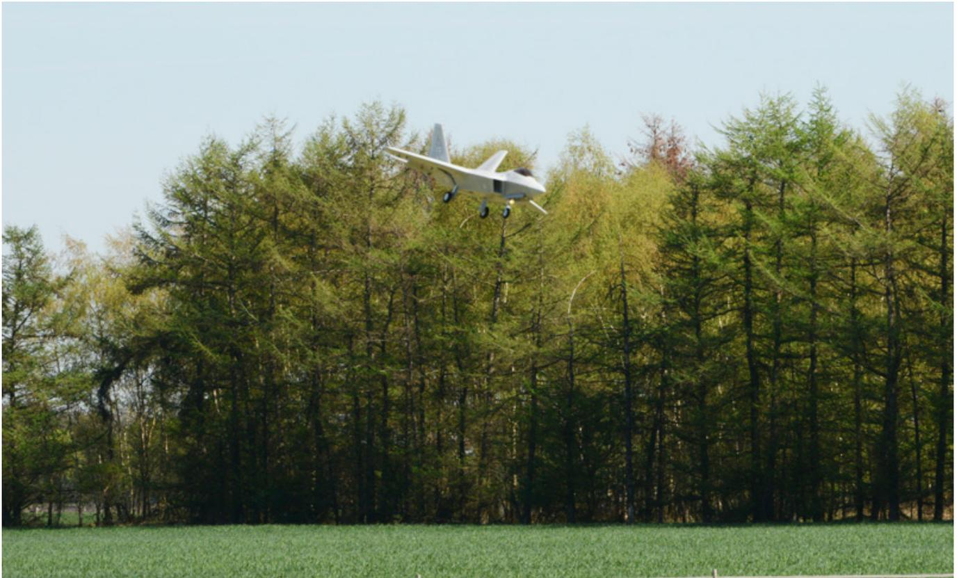
Abgesehen von der Fluglagepositionserkennung ein absolut unkompliziertes Modell, was trotz des Schub/Gewichtsverhältnis von ca. 0,75, in der Luft sehr agil ist. Auch Aufwärtsfiguren lassen sich gut fliegen wenn die Geschwindigkeit am Startpunkt der Figur hoch genug ist.
