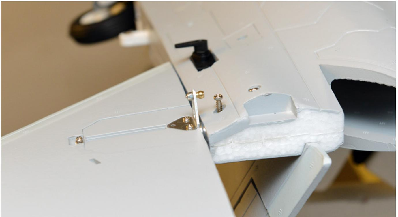
Nun werden auf beiden Seiten jeweils zwei Schrauben (3 x 10 mm) eingedreht. Diese Schrauben so festziehen, dass der Metallstab arretiert ist. Vorsicht beim Anziehen der Schrauben, denn da ist die Gefahr, dass der Kopf der Schraube abschert. Die eine Schraube schaut dabei etwas (im Bild noch nicht angezogen) heraus.
