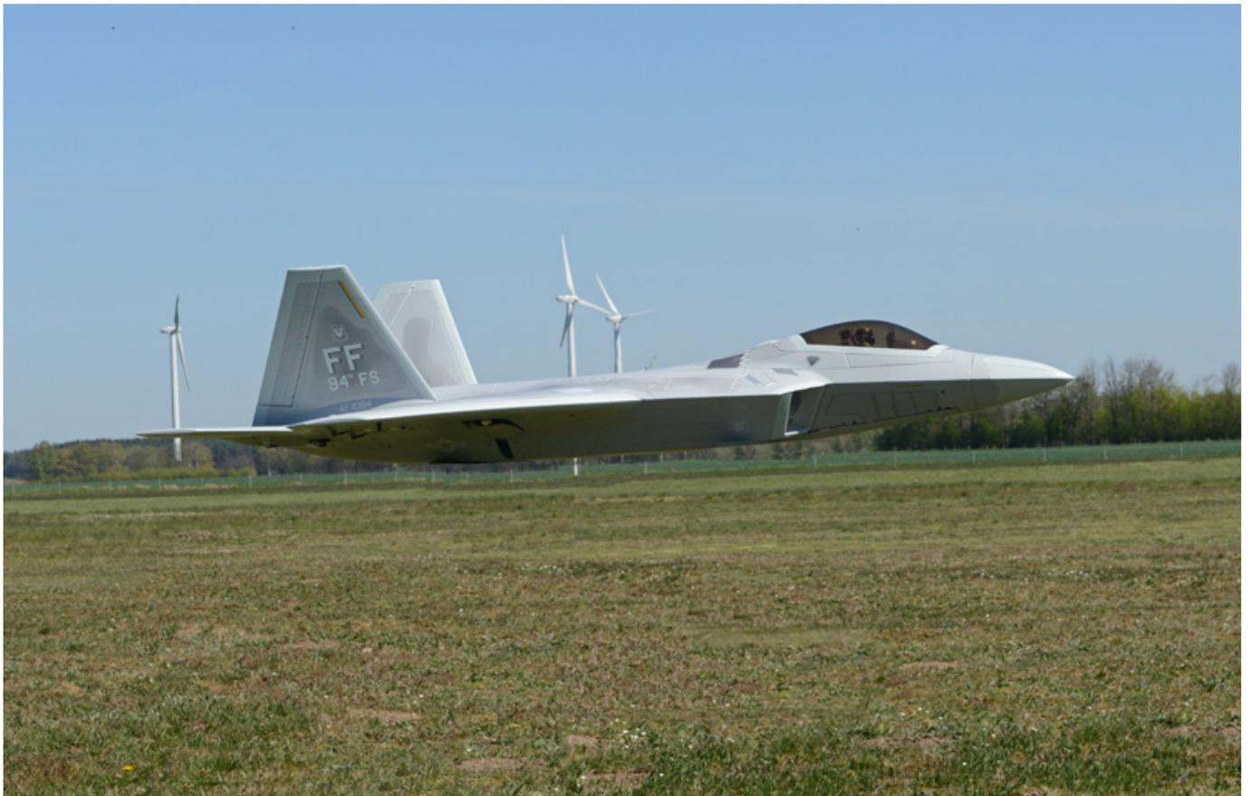
Die mit GPS gemessene Maximalgeschwindigkeit liegt bei ca. 170 km/h. Wir haben für den Erstflug den von Freewing vorgeschlagenen Schwerpunkt von 150 mm eingestellt. Diesen haben wir dann aber auf 142 mm reduziert da das Modell etwas schwammig in der Steuerung war und auch mal nach rechts oder links wegkippte. Der neue Schwerpunkt passt nun besser. Nach Bedarf kann man ihn auf 145 mm zurücknehmen.
