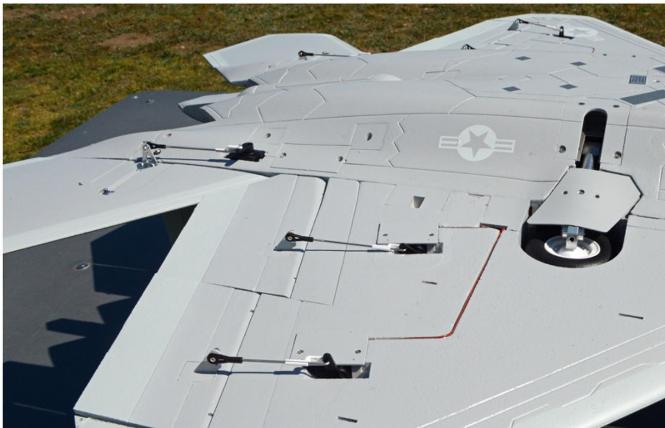
Bei der Montage auch darauf achten, dass die Lenkstange gerade in der Bewegungsrichtung verläuft und nicht schräg eingebaut ist. Also den schwarzen Clip immer auf der richtigen Seite montieren (s. Abb. oben).
