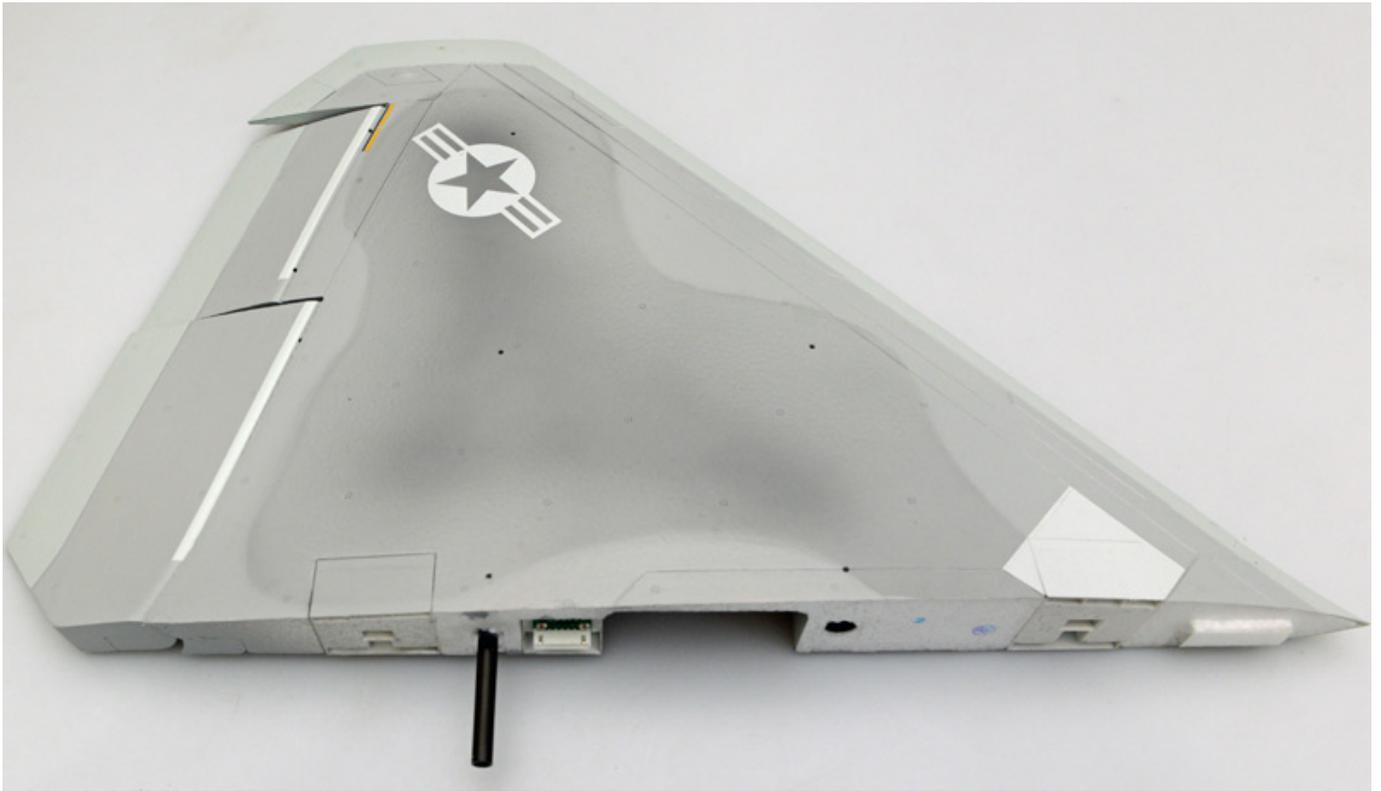
Und nun geht es auch schon an die Montage der beiden Flügel. Ein CFK-Stab zur Arretierung ist schon in die Fläche eingeklebt (s. Abb. oben).
