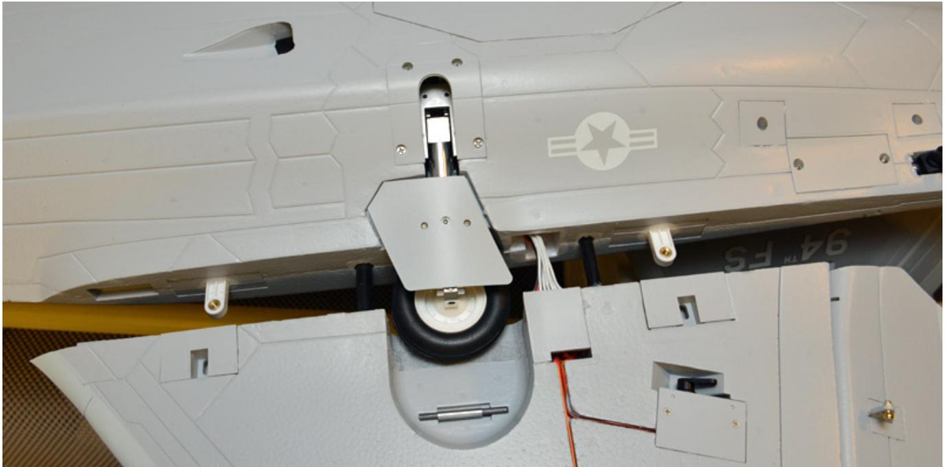
Nun wird der CFK-Stab für die Flächenaufnahme in den Rumpf geschoben so dass beide Enden gleich lang aus dem Rumpf ragen. Jetzt ist es eigentlich schon Zeit den Empfänger an den Servokabeln im Rumpf anzuschließen oder einen Servotester zu bemühen das Fahrwerk auszufahren, denn dann lassen sich die Flügel leichter montieren, da die Räder des Hauptfahrwerkes nicht im Weg sind (s. Abb. oben). Ansonsten muss man das Rad leicht wegdrücken um den Flügel einzuschieben.
