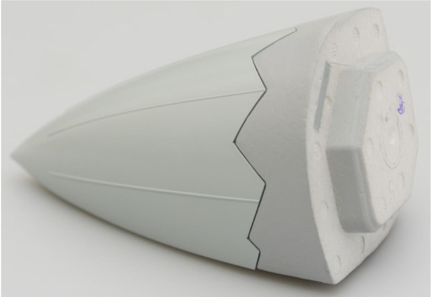
Die Nase ist übrigens - und auch das ist ein großer Pluspunkt - von Magneten gehalten und lässt sich ggf. auch leicht tauschen. Übrigens bietet Freewing auch diverse Ersatzteile an, auch die Fahrwerkskomponenten. Die Montage ist somit nun abgeschlossen.
