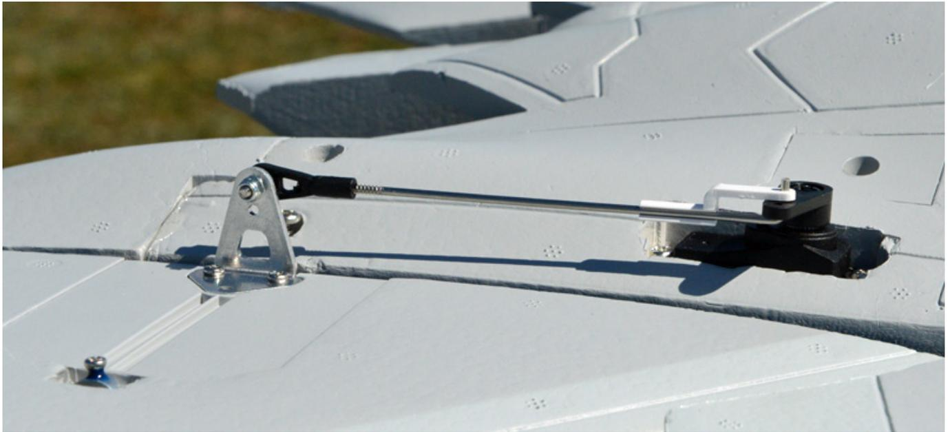
Uns so sieht dann die fertige Anlenkung des Pendelhöhenruder aus (s. Abb. oben).
