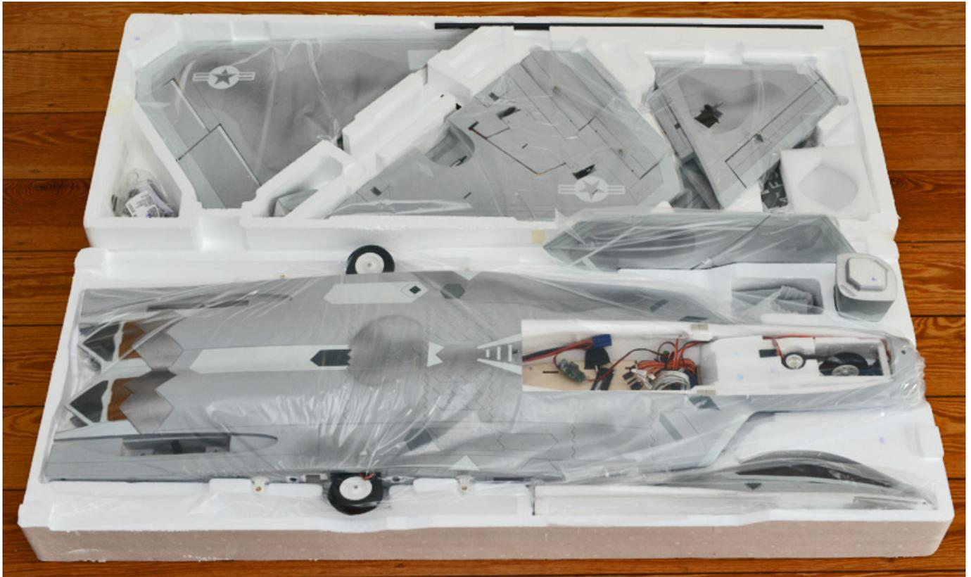
Das Modell ist als ARF-Version verfügbar, wobei alle Servos und das Fahrwerk fertig eingebaut sind. Auch der Antrieb und die Elektronik ist bereits installiert. Als Antrieb wird ein Freewing 90-mm-Impeller mit neuen Blättern in Verbindung mit einem MO37484 Motor mit 1750kV sowie ein 130-Ampere-Brushless-Regler verbaut. Die 8-S-Variante bietet dagegen ein 12.-Blatt-Impeller mit einem MI040753 Motor mit 1.390 kV und einem 150-Ampere-Regler.
