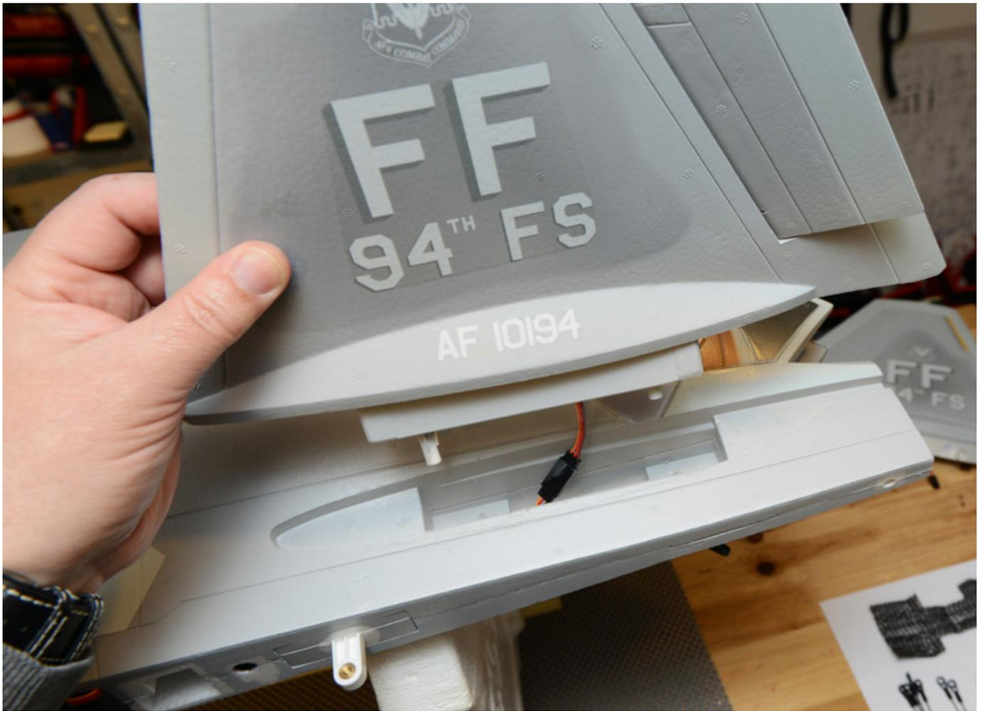
Nun zu dem Pendelhöhenrudern. Das Höhenruder selbst hat eine Aufnahme für den Stahlstab (s. Abb. unten)
