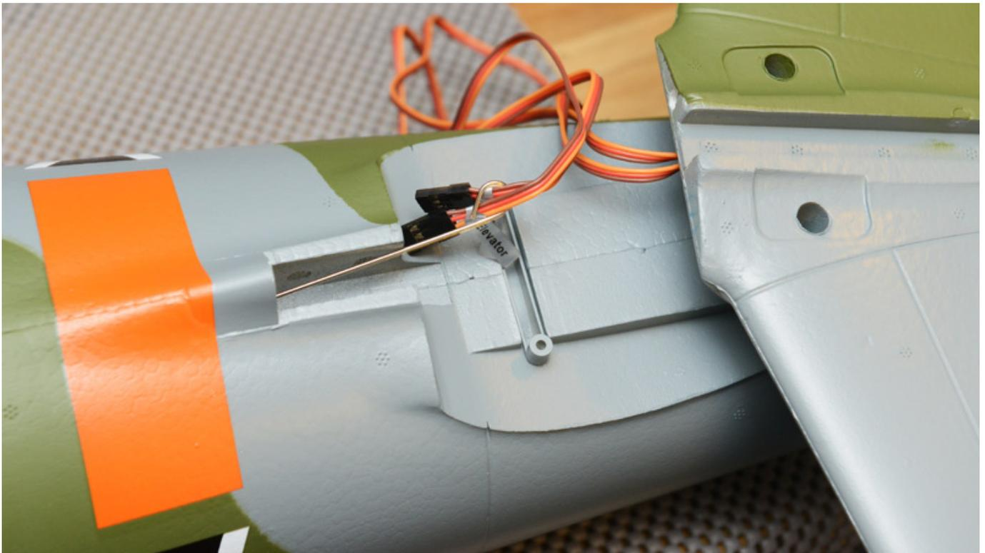
Das Höhenleitwerk wird mit zwei selbstschneidenden Schrauben befestigt.
