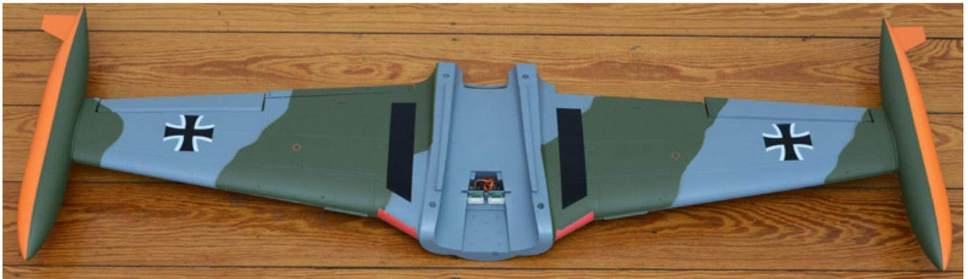
Nun werden die Servo-Anlenkungen für Höhen-, Seiten- und Querruder sowie Landeklappen montiert. Die Ruderhörner müssen dazu an den entsprechenden Stellen auf 1,5 mm Durchmesser aufgebohrt werden. Es empfiehlt jetzt schon einmal den Empfänger zu Binden und anzuschließen um auch gleich die Neutralstellung der Ruder mechanisch einzustellen.
