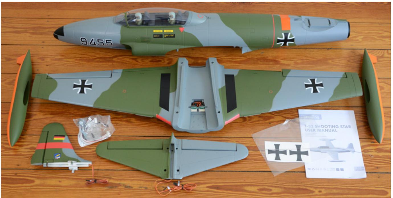
Da Fläche und Höhenleitwerk aus einem Stück bestehen ist die Anzahl der zu montierenden Komponenten überschaubar: Rumpf und Cockpit, Fläche, Höhenleitwerk und Seitenleitwerk sowie Kleinmaterial. Unserem Baukasten lag auch neben dem Handbuch noch ein Aufkleber-Set mit zwei Schwarzen Kreuzen als Ersatz bei.
