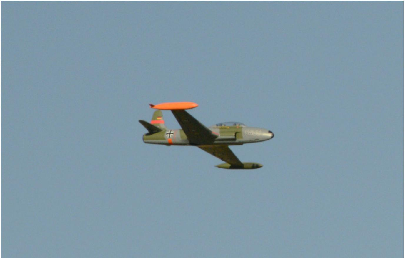
Die T-33 macht in der Luft eine sehr gute Figur. Sie ist zügig Unterwegs so mit ca. 160 bis 170 km/h km/h Maximalgeschwindigkeit. Man kann dank der Flügelstreckung auch längere Passagen völlig ohne Antrieb fliegen und kann das Modell sehr langsam machen und das auch ohne Klappeneinsatz. Trotz Windböen konnten wir aber keine übermäßige Wind- oder gar Seitenwindempfindlichkeit feststellen.
