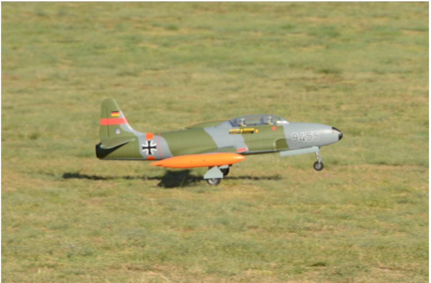
Da die T-33 wie ein Segler gleitet, was bei den Flächenform Profil auch kein Wunder ist, ist die Landung relativ einfach. Auch in die Nähe eines Strömungsabriss sind wir auch bei sehr langsamen Flug nicht geraten. Zudem kann man die T-33 auch gut bei der Landung anstellen, wie man gut auf dem Foto (s. Abb. oben) sehen kann.
