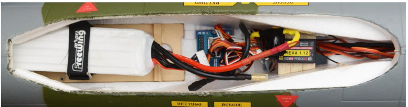
Das Abfluggewicht betrug mit unserem Akku 3,1 Kilogramm, Wir haben einen kurzzeitigen Maximalstrom von 111 Ampere gemessen, also über der Maximalstromangabe von 100 Ampere des Reglers, aber da die 111 Ampere nur sehr kurz auftreten, hat sich während des Betriebs, auch an sehr heißen Tagen, kein Problem mit dem Regler gezeigt. Über Öffnungen an der Unterseite des Rumpfes ist
