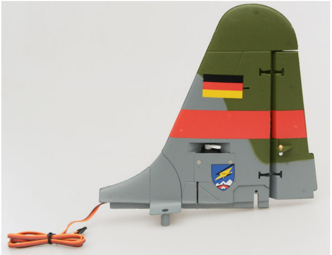
Nun wird auch das Servokabel des Seitenleitwerks durch den Rumpf nach vorne gezogen und es wird auf das Höhenleitwerk aufgesetzt und mit vier selbstschneidenden Schrauben befestigt (s. Abb. unten).
