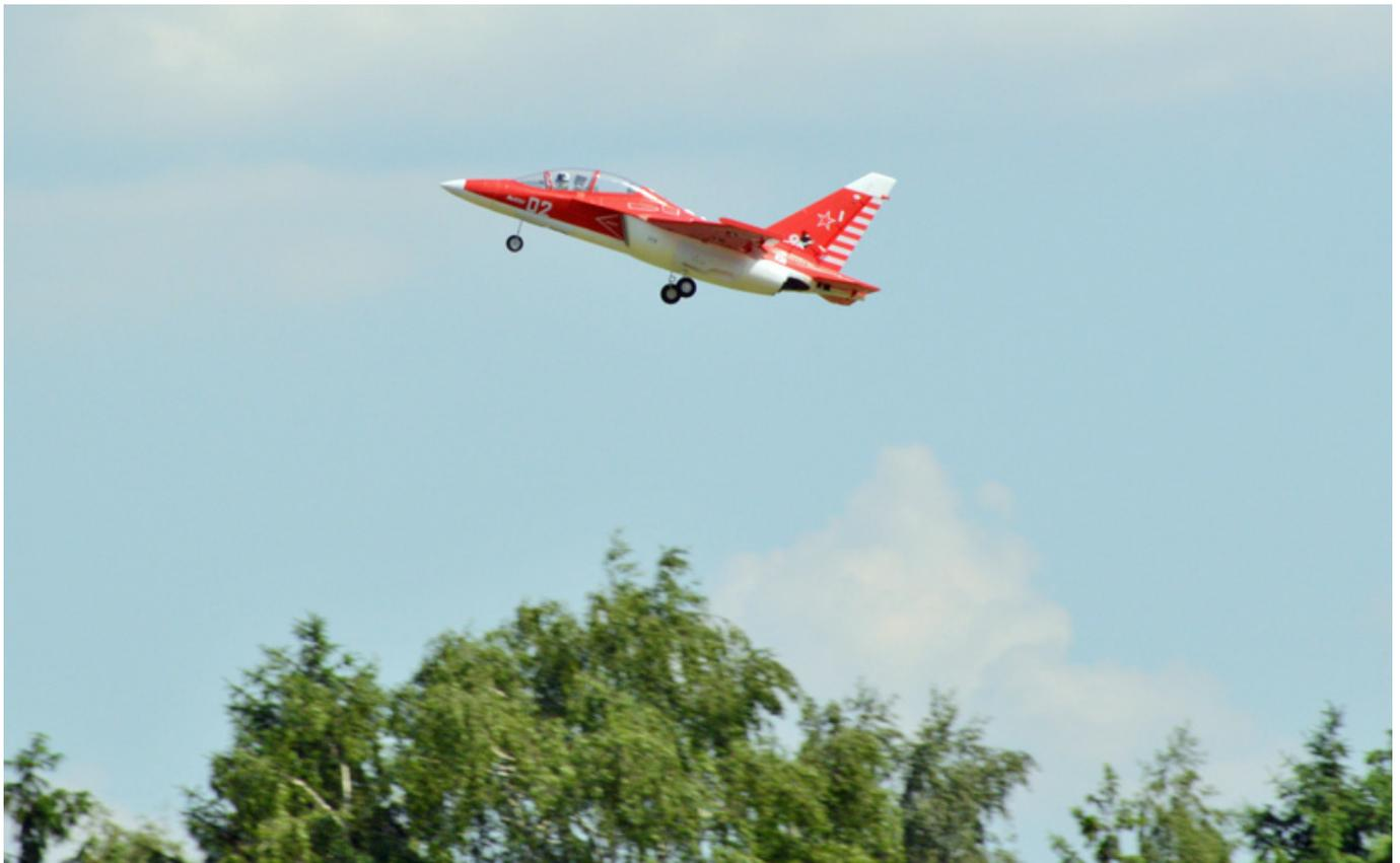
Das Modell ist mit dem 4-S-Antrieb erstaunlich gut motorisiert. Man kann häufig Gas rausnehmen, so dass man problemlos 5 Minuten Flugzeit erreicht.
