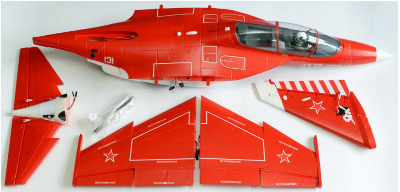
Weitere Komponenten sind zwei Flächen, ein Seitenleitwerk sowie eine Höhenleitwerkssektion. Überall sind Servos eingebaut und die Anlenkungen sind ebenfalls schon installiert. Für die Flächen liegen zwei Holme bei und des Weiteren ist auch noch eine Tube Einkomponentenkleber sowie zwei Ersatz-Anlenkgabeln und vier Schrauben für die Flügelbefestigung dabei. Das Cockpit ist für diese Größe sehr schön gemacht (s. Abb. unten).
