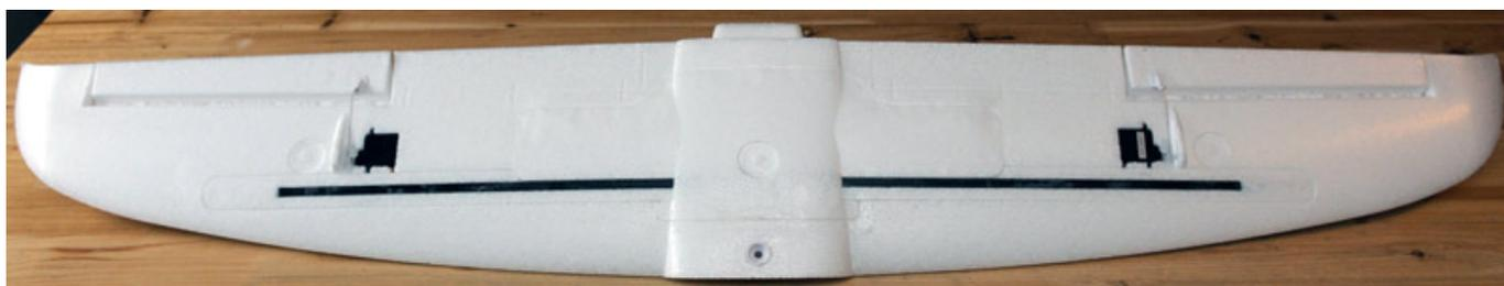
Die Servokabel schauen oben heraus (s. unten). Die Kabel werden mit 320-mm-Servokabel (Graupner-Nr. 3952.32) verlängert. Die Verlängerungen verbleiben im Rumpf.
