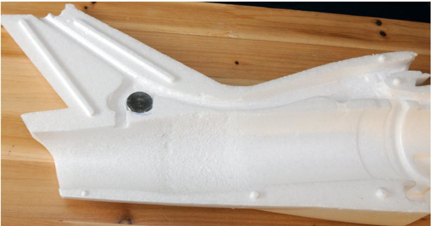
Wenn der Schwerpunkt von 70 mm eingestellt ist können die beiden Rumpfhälften verklebt werden. Auch hier mit Tesa-Film-Unterstützung und Klemmen arbeiten. Ggf. Klebestellen mit Aktivator besprühen damit einige Stellen schon mal schneller verkleben um andere dann nacharbeiten zu können. Als nächstes ist noch das Höhenleitwerk angeklebt.
