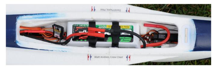
Als Antriebsakku haben wir einen 4 S LiPo von SLS (Stefans Lipo Shop) der Serie APL 30C+ mit 3.300 mAh eingesetzt, der perfekt passt und auch bei dem höheren Strom für eine gute Spannungslage sorgt.
