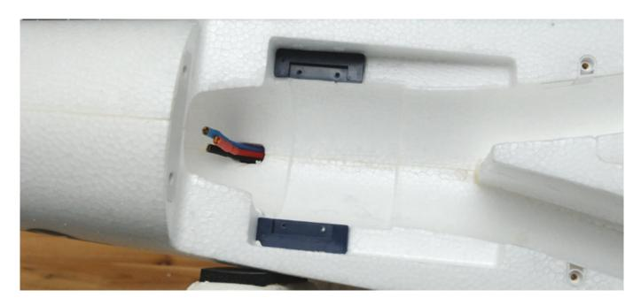
Als erstes muss man den vorhandene Impeller ausbauen. Die Laschen des Mini Fan pro haben die gleiche Breite wie der E-flite Delta V 15. Lediglich die Tiefe ist größer. Man sollte zwei Linien markieren (siehe unten) und die beiden Aufnahmen dann entsprechend vergrößern (von 7,5 auf 12 mm). ggf. sind die Aufnahmen mit Sekundenkleber nachzukleben.
