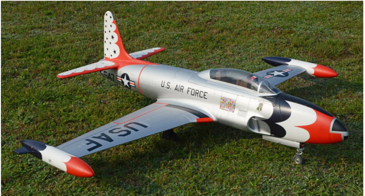
Neben Freewing hat auch HSD nun eine EDF-Modell der Lockheed T-33 Shooting Star herausgebracht und zwar eine gigantisch große mit 1.800 Millimeter Länge und einer beachtlichen Spannweite von 2.018 Millimeter mit üppiger Ausstattung. Sicherlich zurzeit das größte EDF-Schaummodell was in Serie hergestellt wird. Der Maßstab beträgt ca. 1:6, wobei die Flächen etwas größer sind als beim Original. Wir haben im August 2020 ein Modell von Natterer Modellbau zum Test bekommen.
