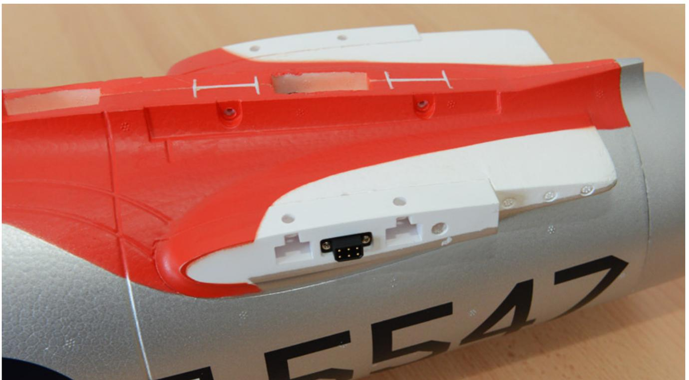
Die beiden Teile des Höhenleitwerks werden wie folgt montiert. Es wird der 6 mm x 650 mm Holm eingeschoben so dass er auf jeder Seite 250 mm herauschaut. Nun einfach die Höhenleitwerks-Komponenten aufschieben und verschrauben. Die Servoverbindung erfolgt über schon eingebaute Steckverbinder.
