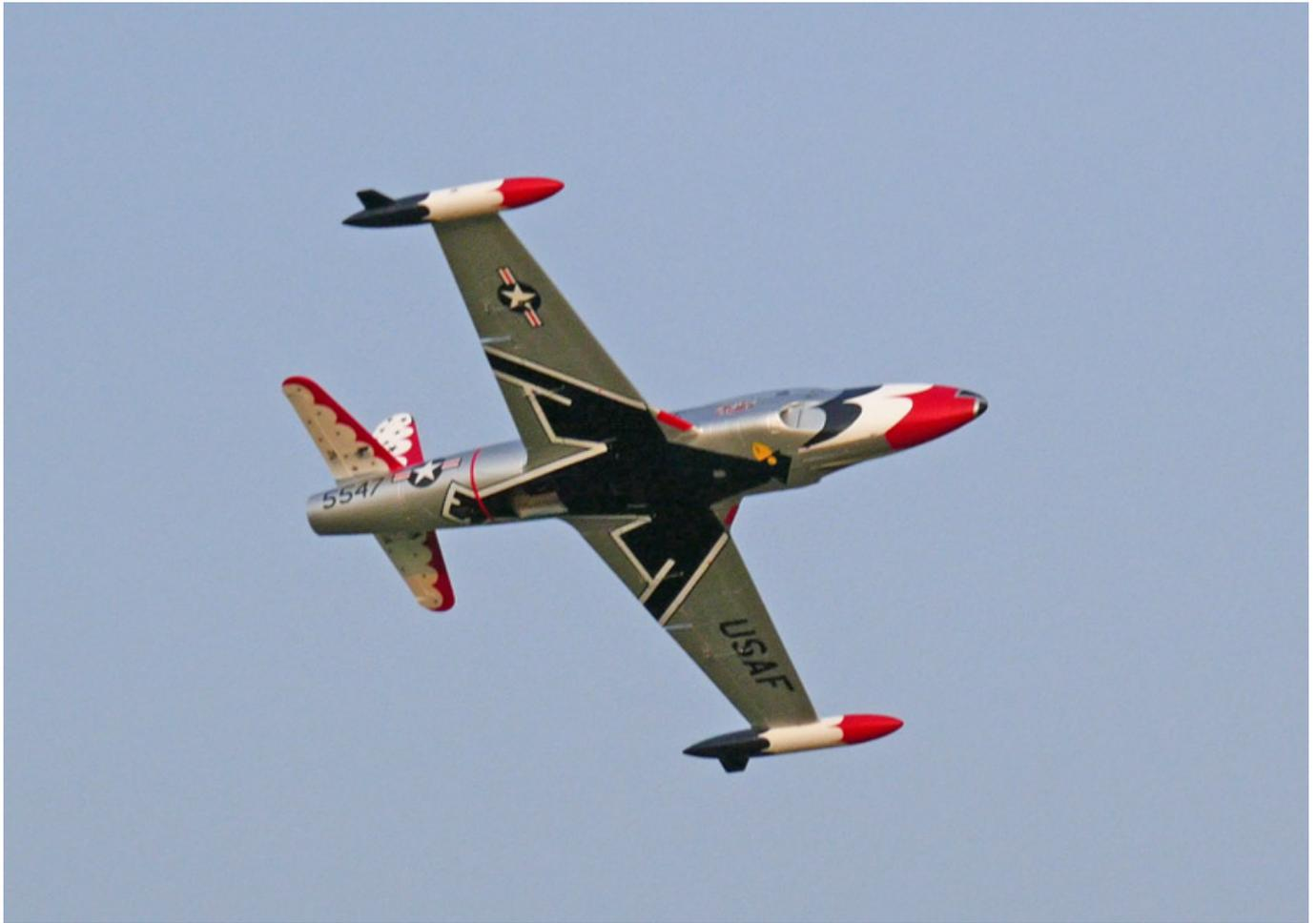
Bei Nutzung des guten Segelverhaltens und vieler Phasen ohne Antriebsnutzung kann man erstaunliche Flugzeiten erzielen. Der Erstflug mit sehr vielen Segelpassagen für die Fotografen war ca. Sechs Minuten. Selbst bei vielen Vollgasphasen sind aber fünf Minuten Flugzeit mit den 6500er Red Power LiPo-Akkus überhaupt kein Problem.
