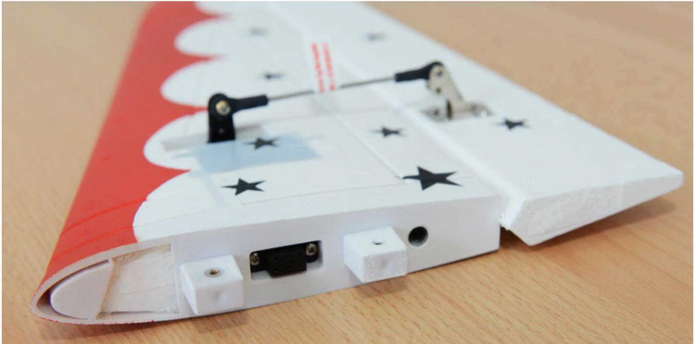
Dann wird das Seitenleitwerk angebaut. Zunächst wird das Servokabel angesteckt und dann das Leitwerk aufgesetzt und verschraubt. Wichtig ist, dass man die Schrauben nicht zu fest anzieht, da sonst das Kunststoff brechen kann.
