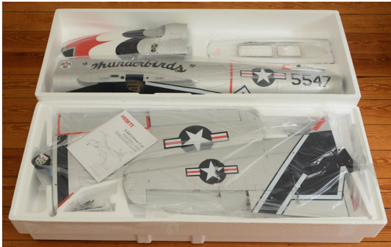
Der Baukasten ist auf den ersten Eindruck relativ kompakt aber spätestens wenn man die Einzelkomponenten auspackt wird die Größe des Modells offensichtlich. Das Modell ist aus extrem dichtem EPO-Schaum gefertigt
