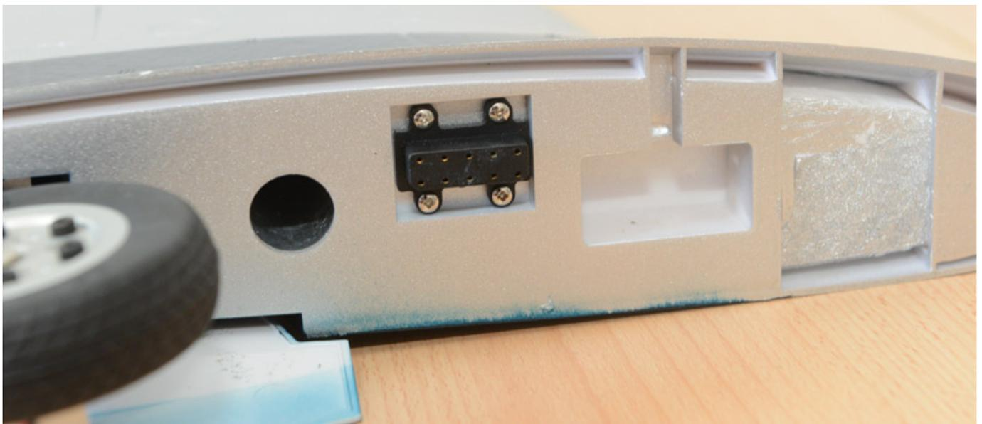
Nun muss man nur noch die Flügelhälften aufschieben und diese mit den vier 3 x 14 mm mit Innensechskant-Schrauben befestigen. Am besten nutzt man dazu einen Schraubendreher mit Sechskant wie den Wera 354 2,5 x 75. Einen Sechskant-Winkelschlüssel sollte man nicht nutzen, denn dann kann man sich bei der Montage leicht den Rumpf beschädigen. Bei unserem Testmodell ließ sich eine Schraube nicht eindrehen, da die Bohrung im Plastikstück am Flügel zu klein war. Die haben
