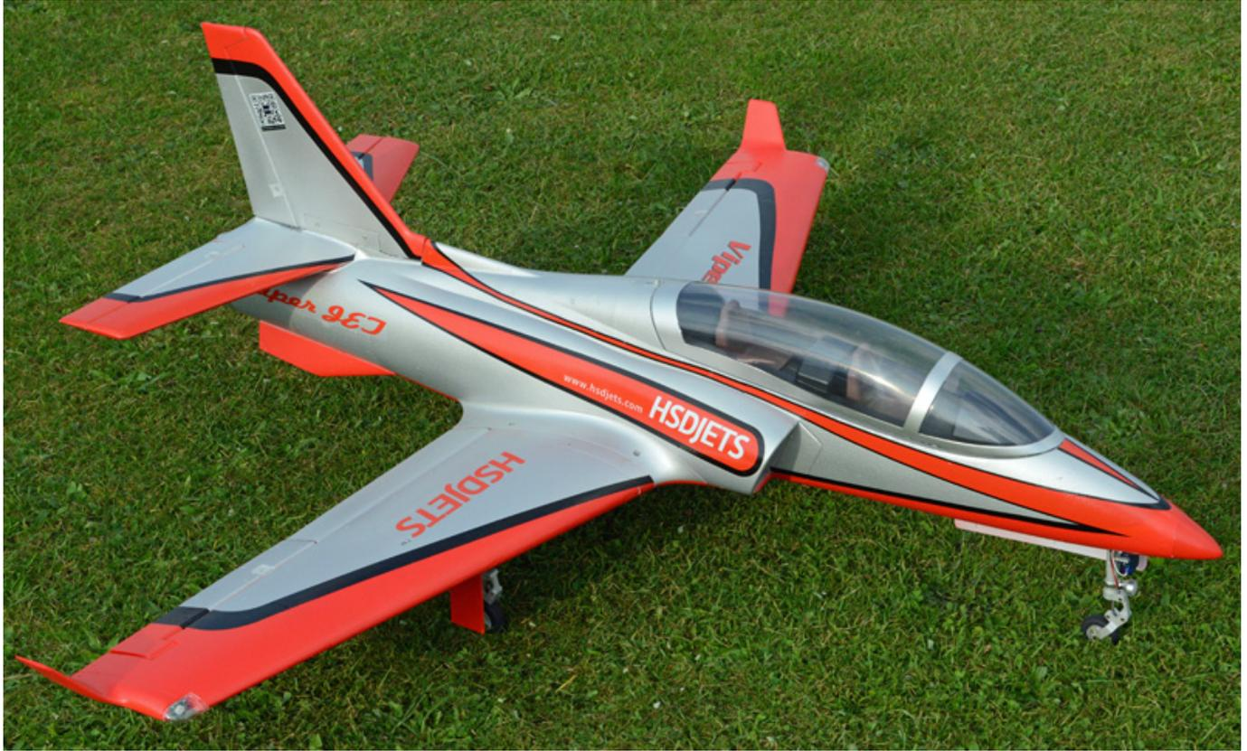
HSDJETS ist eigentlich für Ihre Schaumjets für Turbine bekannt aber man bietet auch Einiges an Elektroimpeller-Jets an. So auch eine Viper mit 90-mm-Impeller mit 1400 mm Spannweite. Diese wurde nun komplett überarbeitet und steht nun in der Version 2 zur Verfügung. Um es vorweg zu nehmen: es handelt sich nicht um ein kosmetisches Update sondern eher um ein Upgrade. Die Größe ist mit 1,4-Meter-Spannweite identisch zum Vorgänger, was einem Maßstab von ungefähr 1:9 entspricht.
