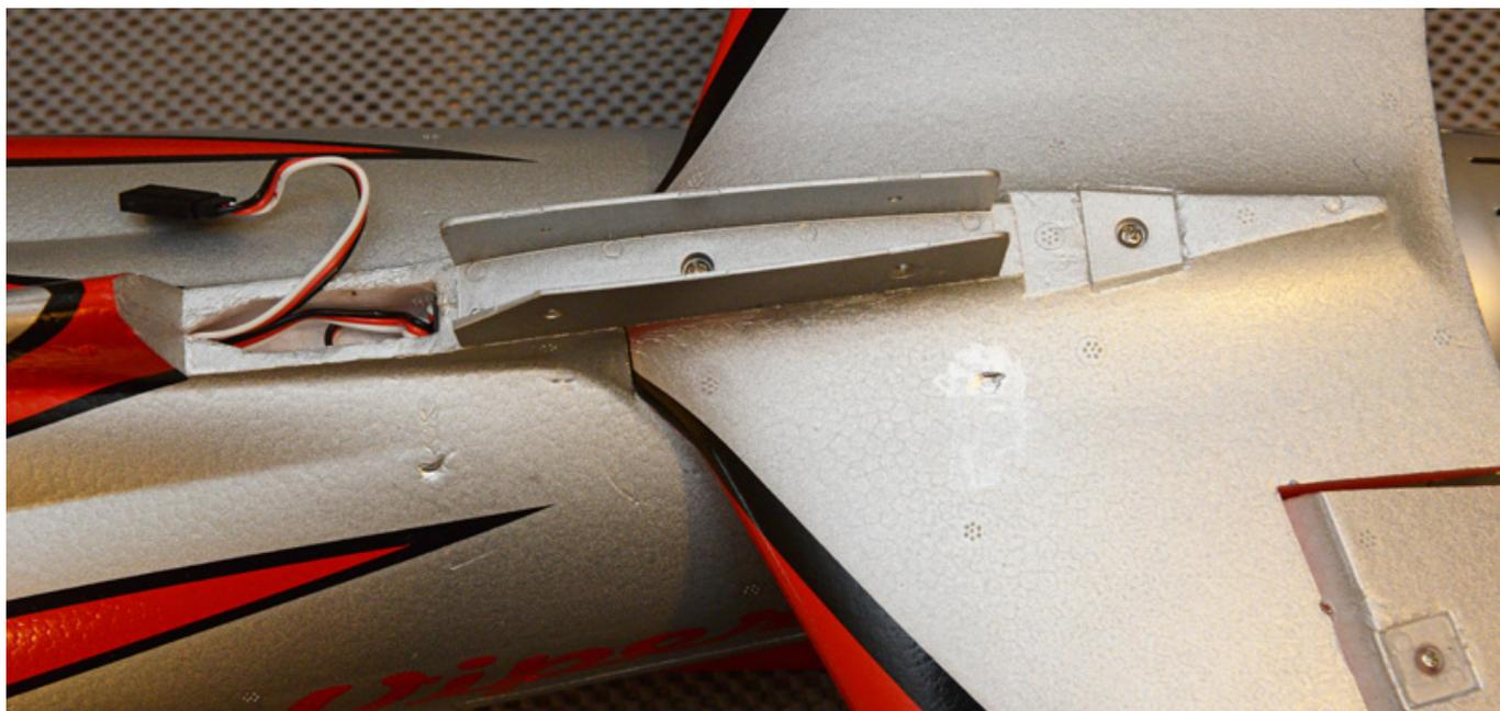
Nun wird das Servokabel des Seitenruders verbunden und es wird in die Führung gesteckt und mit vier Schrauben befestigt.
