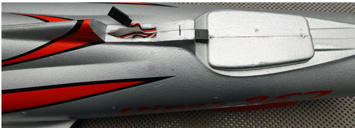
Die Kabel sind schon im Rumpf verlegt (s. Abb. oben). Die beiden Servokabel werden in die Verlängerung gesteckt und das Höhenleitwerk dann mit zwei Schrauben befestigt.
