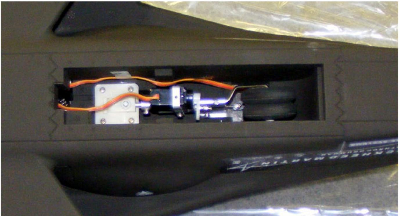
Auch das Bug (Doppelbereifung) und die beiden Hauptfahrwerke sind schon fix und fertig vormontiert. Im unteren Bild sieht man auch die Serviceklappe für den Zugang zum Antrieb.
