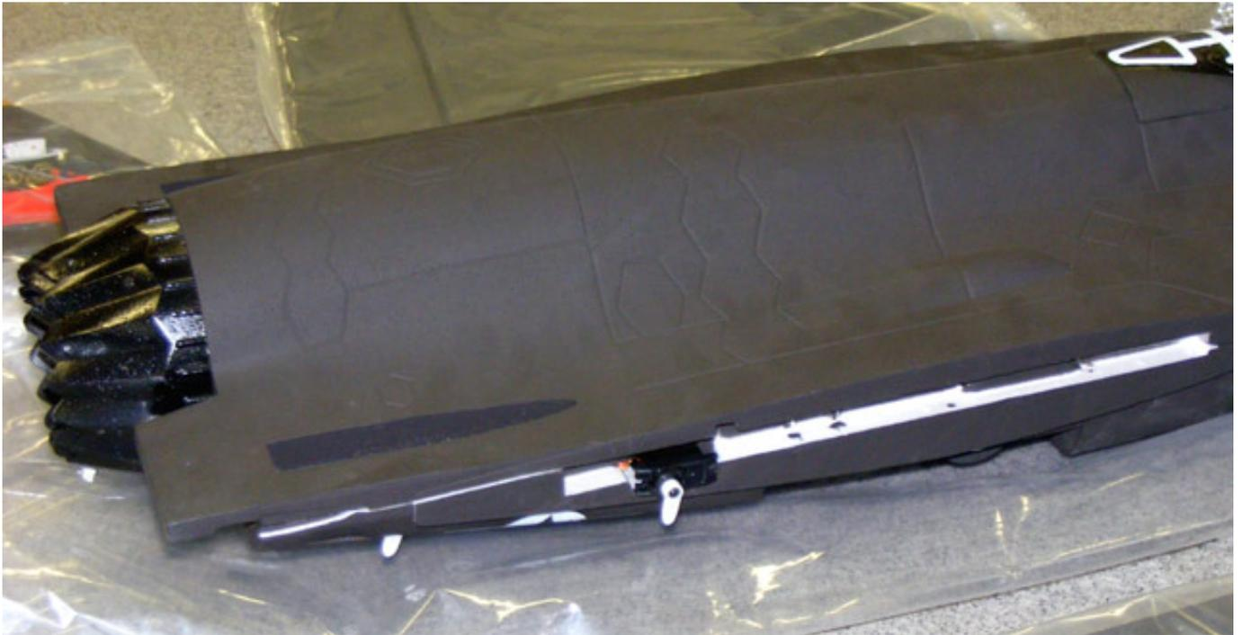
Die acht Micro-Servos für Querruder (2), Höhe, Seite, Einziehfahrwerk (3) und Bugfahrwerkslenkung sind, wie auch die Einziehfahrwerksmechanik selbst, schon eingebaut und verdrahtet.
