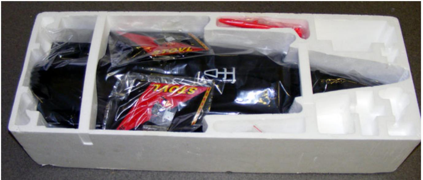
Der Baukasten besteht aus einem Rumpf, zwei Flügelhälften, zwei Leitwerke und zwei Seitenleitwerke aus Schaum, eine Cockpit-Haube sowie die Nasenspitze aus Kunststoff und noch zwei Raketenattrappen. Alle Decals sind bereits aufgebracht.
