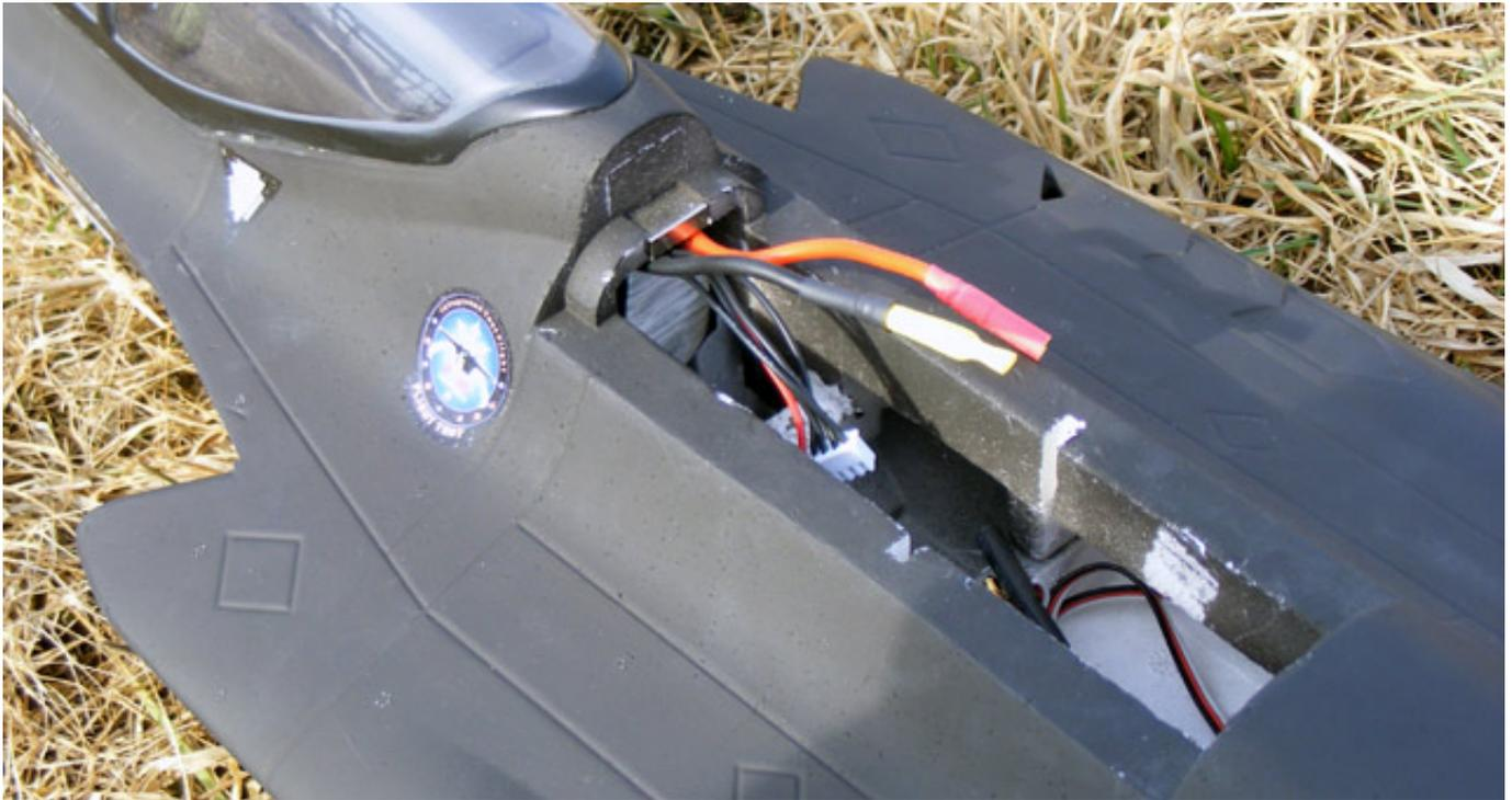
Wir haben zunächst einen 2.100 mAh Akku eingesetzt, aber bei einem Strom von ca. 38 Ampere sollte man mindestens einen Akku mit einer Kapazität von 2.400 mAh einsetzen, da die Spannung sonst zu stark zusammenbricht. 30-C-Akkus im Bereich 2.400 bis 2750 mAh passen und die Eingangsleistung liegt um die 600 Watt. Man sollte aber die Abmessungen bei Akkus über 2.400 mAh vor dem Kauf überprüfen, da hier verschiedenen Bauformen am Markt sind.
