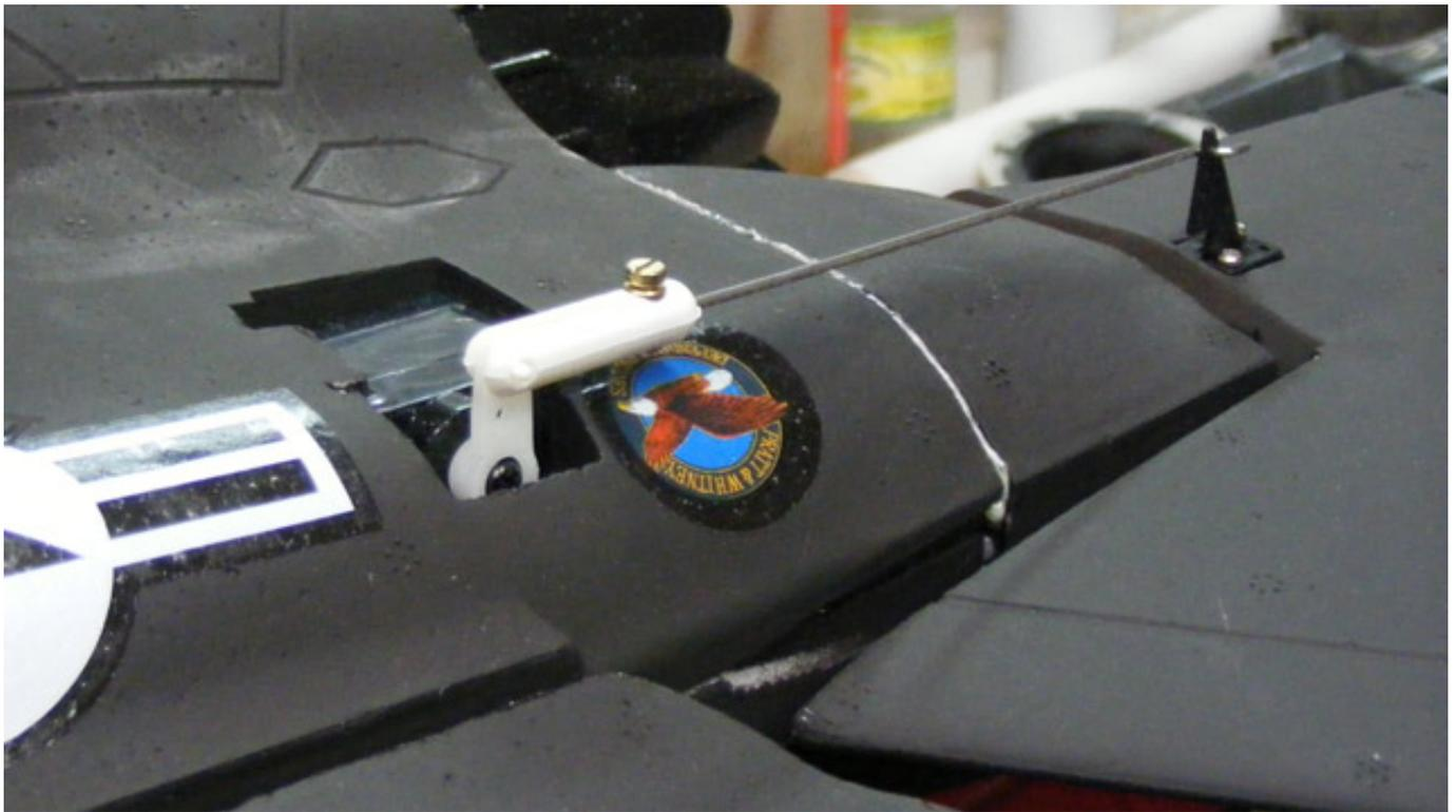
Der 45 A Regler verfügt über BEC für die Empfängerstromversorgung und liegt vertieft im Luftkanal. Eine optimale Kühlung ist damit gewährleistet.
