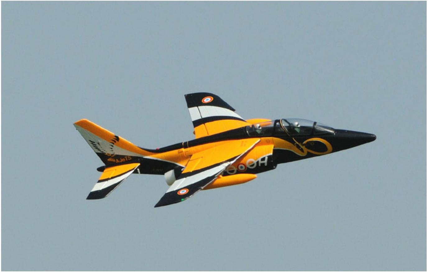
Die Landung sollte durch eine große Kurve eingeleitet werden und dann muss man mit Schleppgas möglichst flach anfliegen und nur leicht Höhe abbauen. Erst im letzten Moment kurz vor der Bodenberührung kann man das Gas ganz rausnehmen. Aber auch mit Schleppgas ist die Landegeschwindigkeit nicht sehr hoch.
