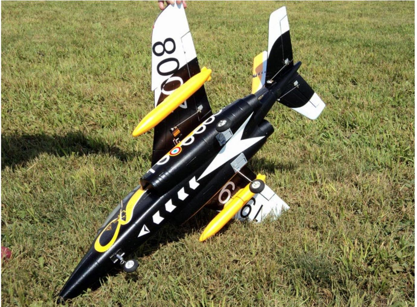
Mit dem Fahrwerk ist sowohl ein Start als auch Landung bei Gras möglich. Das Fahrwerk verbiegt sich zwar mit der Zeit und muss dann nachgebogen werden es neigt aber beim Betrieb nicht zum Springen.
