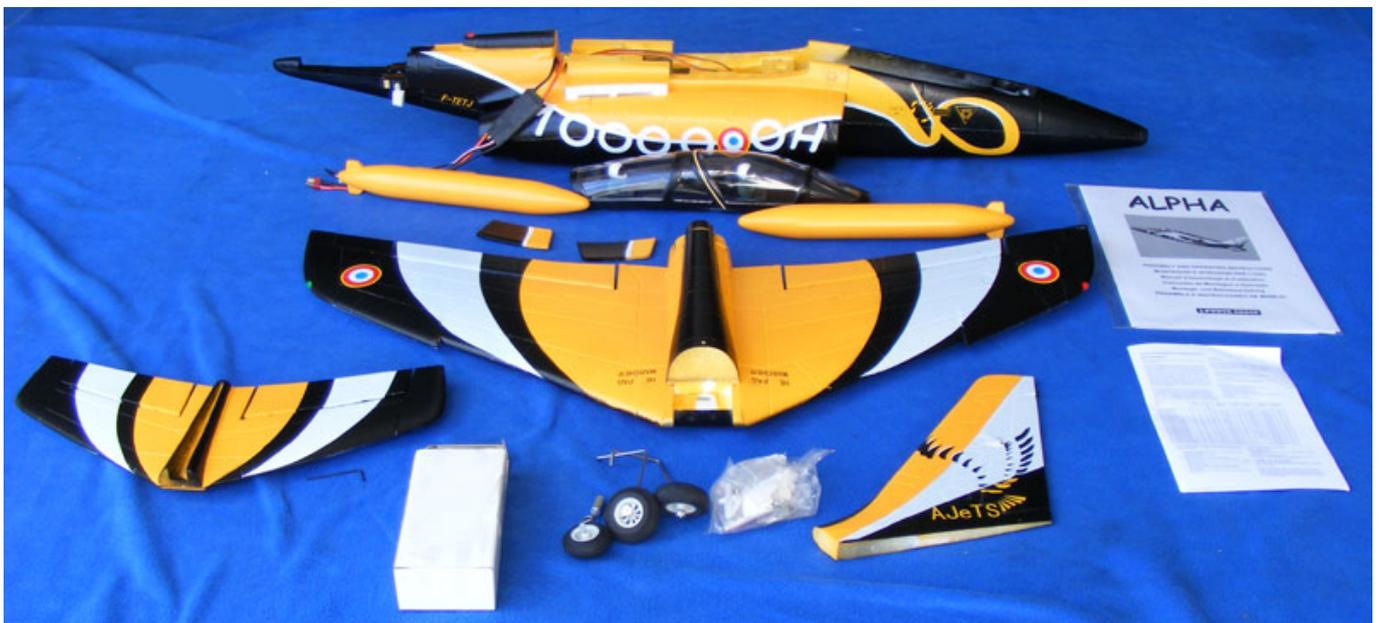
Das Modell besteht aus wenigen Einzelteilen und zwar: kompletter Rumpf, durchgängiger Flügel, Höhenleitwerk, Seitenleitwerk und fertige Kabine mit Piloten sowie zwei Zusatztanks, festes Fahrwerk (Stahldrähte mit Rädern) sowie alle benötigten Kleinteile, hauptsächlich für die Anlenkung der Ruder.
