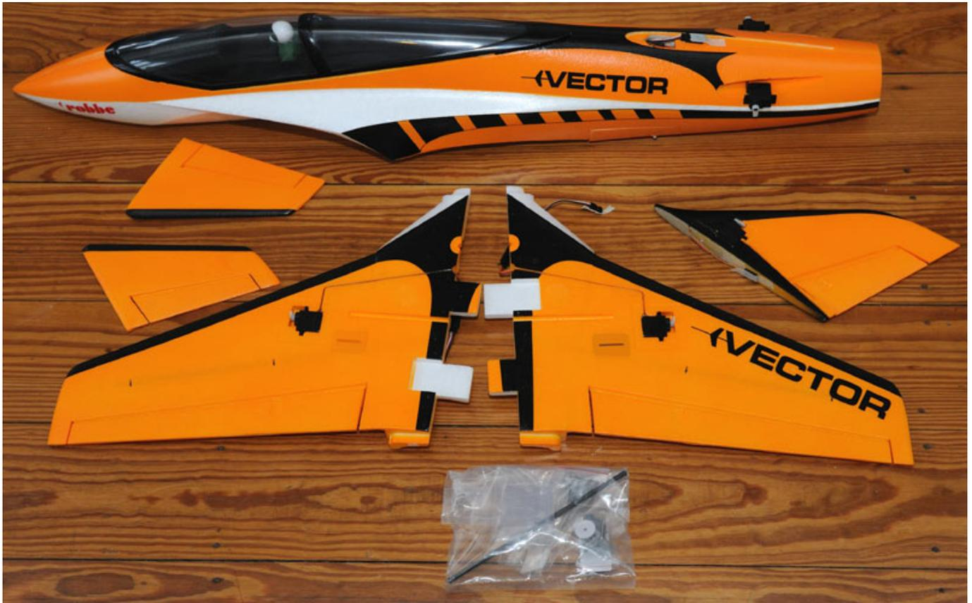
Weitere Komponenten sind die beiden Flügelhälften, Höhenruder, Seitenleitwerk, die komplett fertig aufgebaute Kabinenhaube mit eingeklebten Magneten sowie ein CFK-Stab und Kleinteile wie Anlenkungen, Abdeckungen, Landekufe etc.
